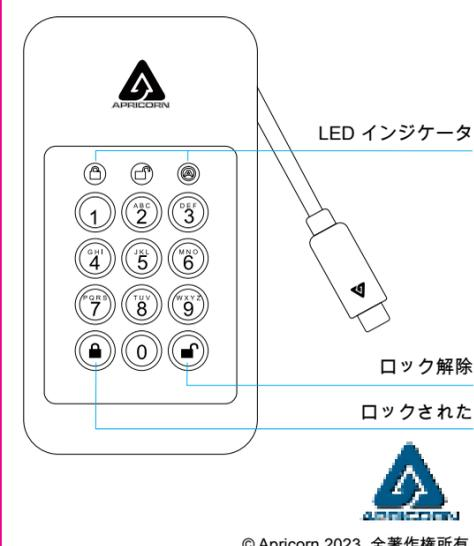
最初にAegis NVXを接続すると、ユニットはすべてのセキュリティコンポーネントが正しく動作していることを確認するためにセルフテストを行います。LEDは**赤色**、**緑色**、青色の3つのテスト段階に進みます。この後、**緑色**が3回点滅し、すべてのコンポーネントが正常に機能していることが示されます。テストに失敗すると、**赤色**のLEDが点滅して、ユニットが操作不能状態になります。
