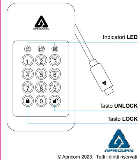
Quando si collega Aegis NVX per la prima volta, l'unità eseguirà un test automatico per verificare che tutti i componenti di sicurezza funzionino correttamente. I LED attraverseranno 3 fasi di test: **ROSSO**, **VERDE** e **BLU**. Seguiranno tre lampeggi **VERDI** che indicano che tutti i componenti funzionano correttamente. Un test fallito lascerà l'unità in uno stato inoperabile indicato da un LED **ROSSO** lampeggiante.
