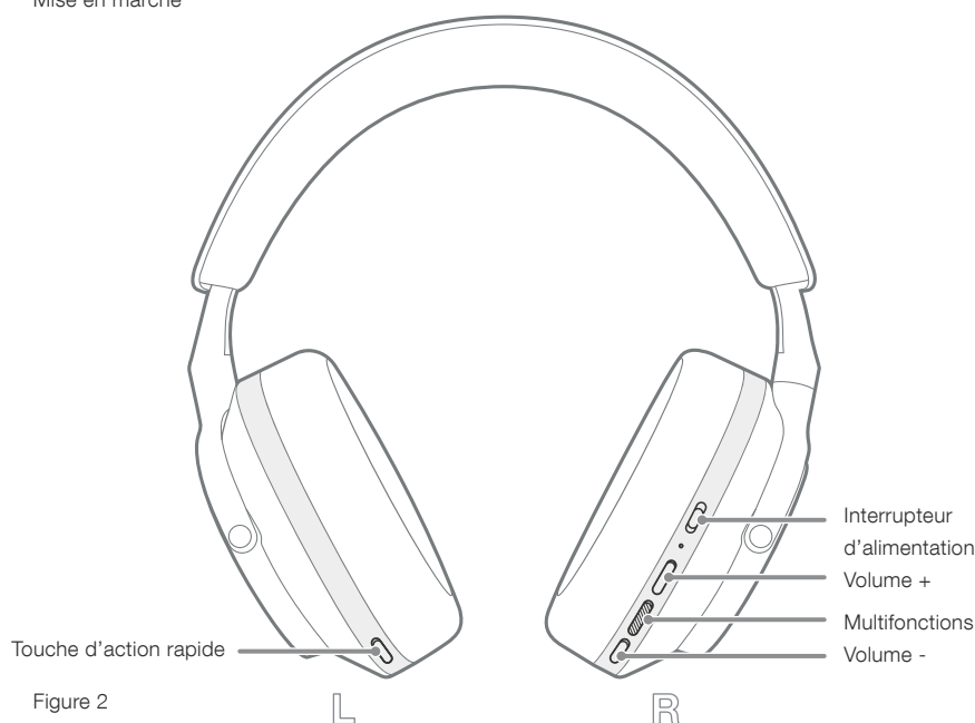
Figure 1 Mise en marche
