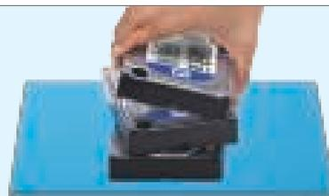
**Procédez avec précaution** pour monter le disque dans la baie, une force excessive pourrait endommager le disque.
