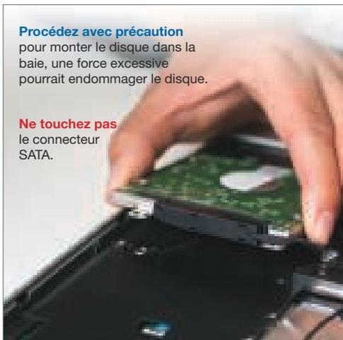
**Ouvrez le sac antistatique** dans un environnement ne comportant pas de risque de décharge électrostatique.
