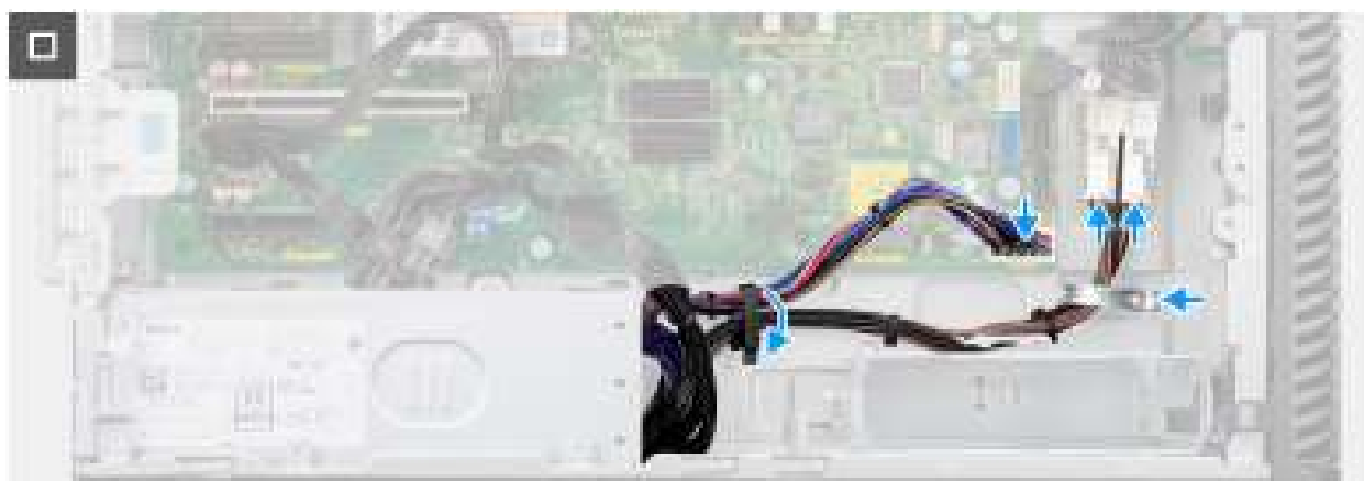
Figure 50. Installation du bloc d'alimentation de 1 000 W
