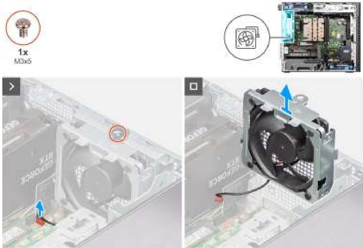
Figure 66. Retrait du ventilateur arrière (bloc d'alimentation de 1 000 W)
