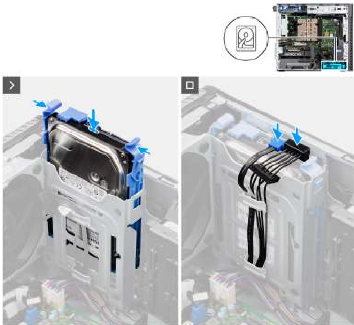
Figure 21. Installation de l'assemblage de disque dur de 3,5 pouces de la baie 1
