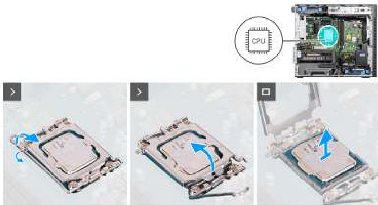
Figure 56. Retrait du processeur
