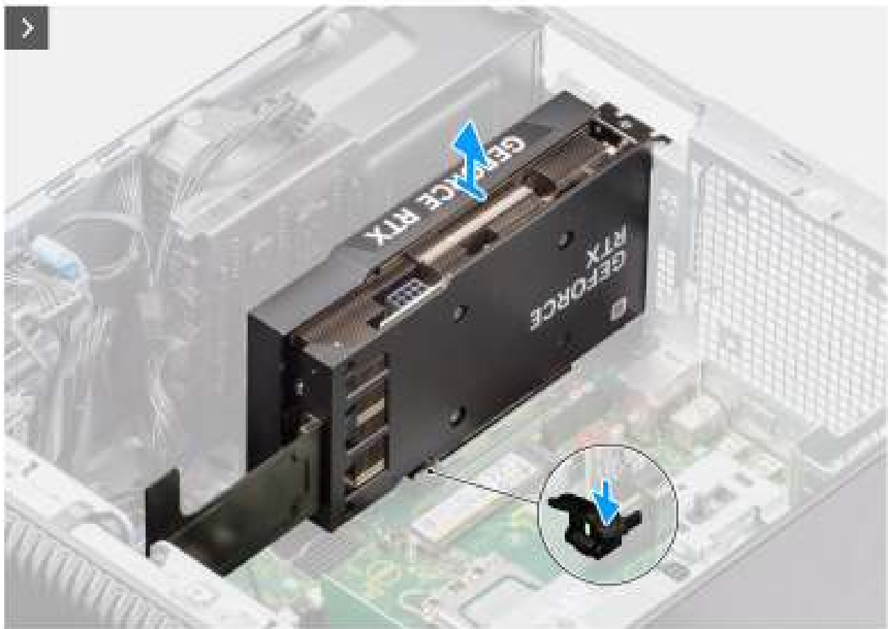
Figure 41. Retrait du processeur graphique alimenté
