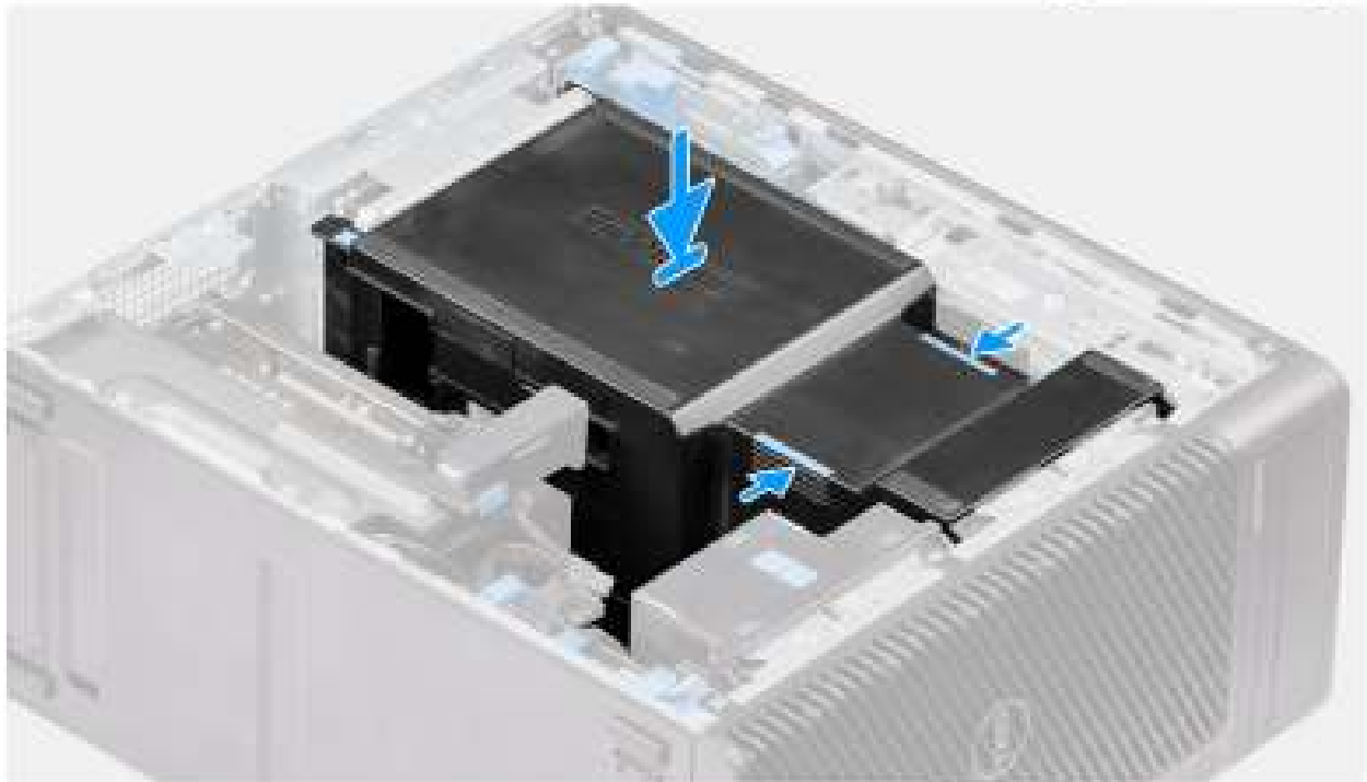
Figure 15. Installation du carénage à air
