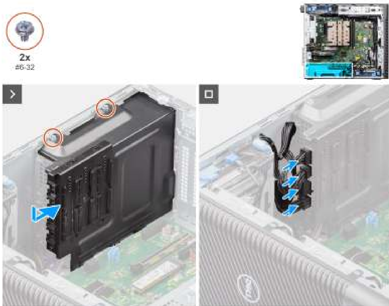
Figure 47. Installation du capot du bloc d'alimentation
