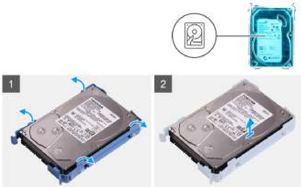
Figure 18. Retrait du support de disque dur de 3,5 pouces
