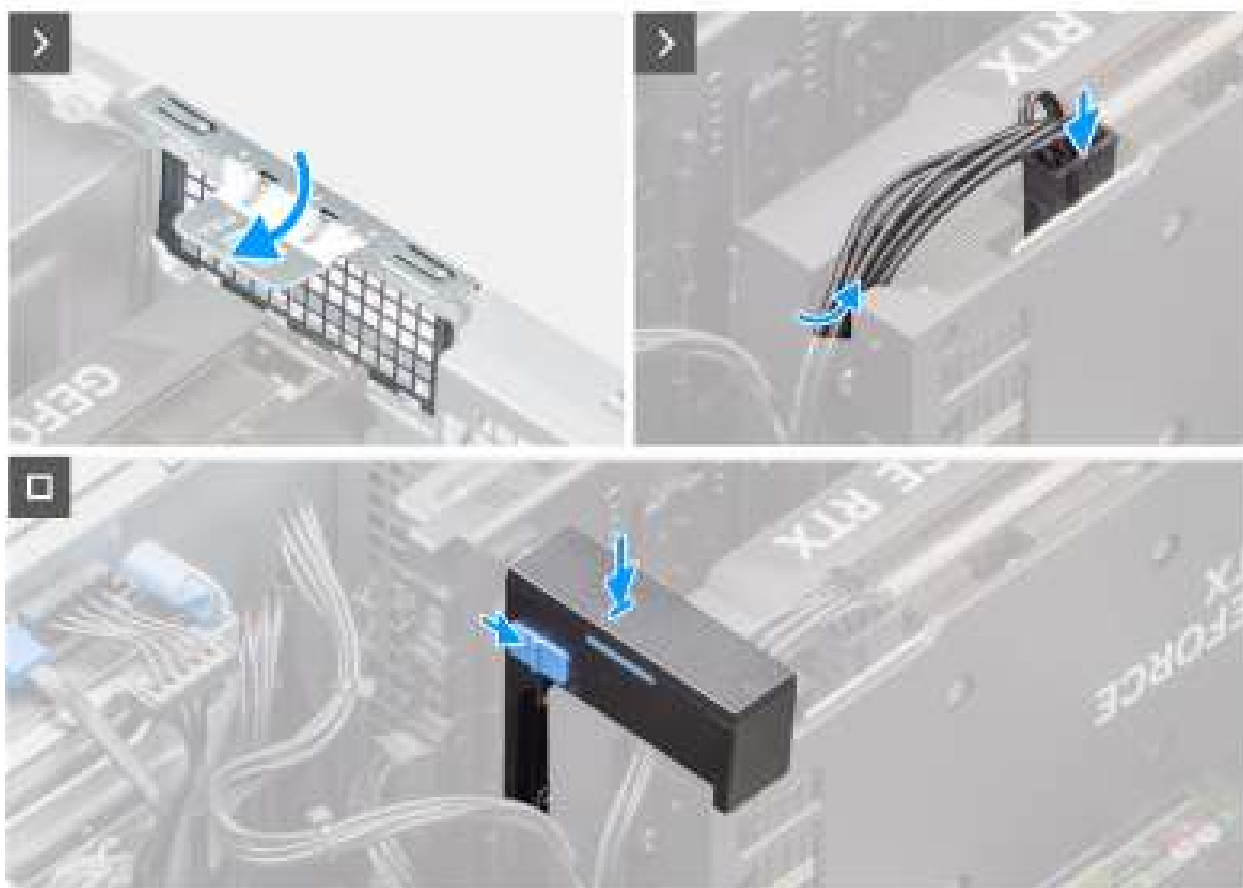
Figure 45. Installation du processeur graphique alimenté
