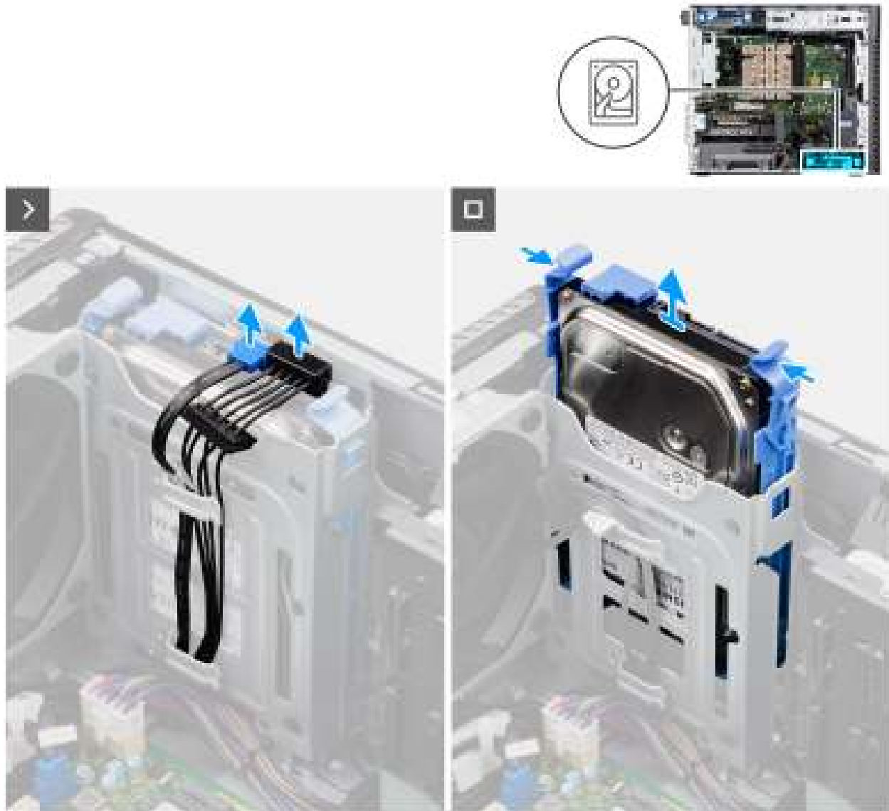
Figure 16. Retrait de l'assemblage de disque dur de 3,5 pouces de la baie 1
