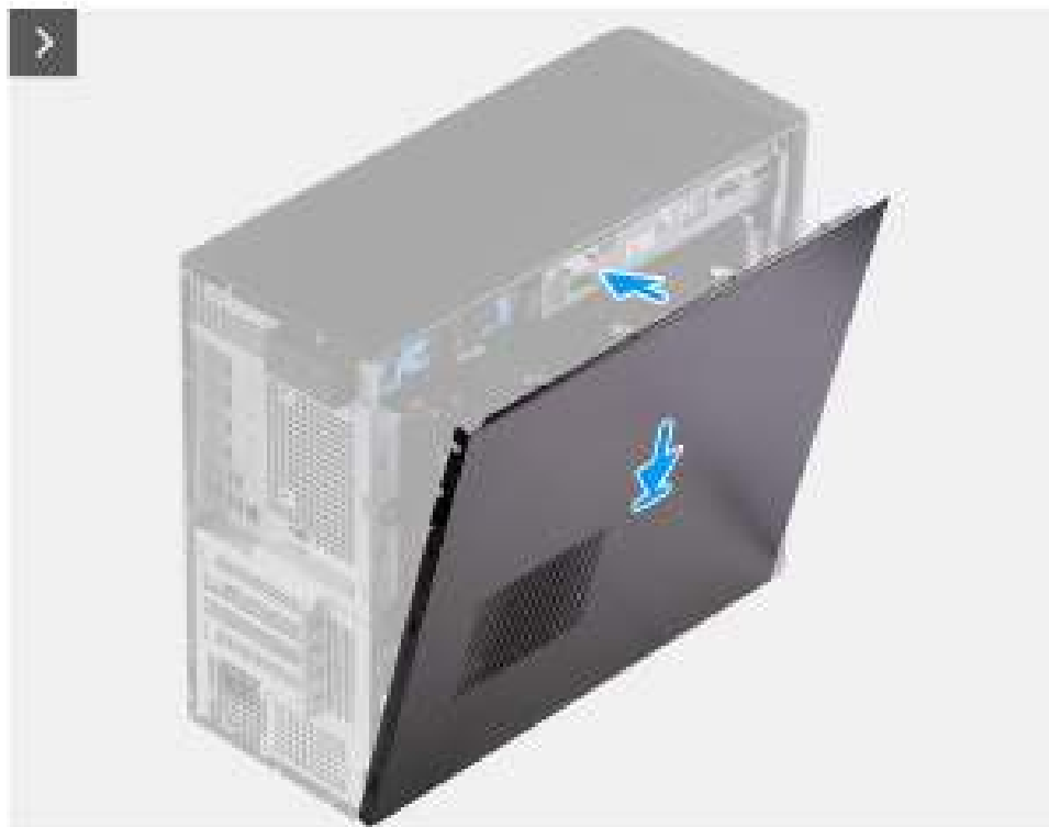
Figure 10. Installation du capot latéral
