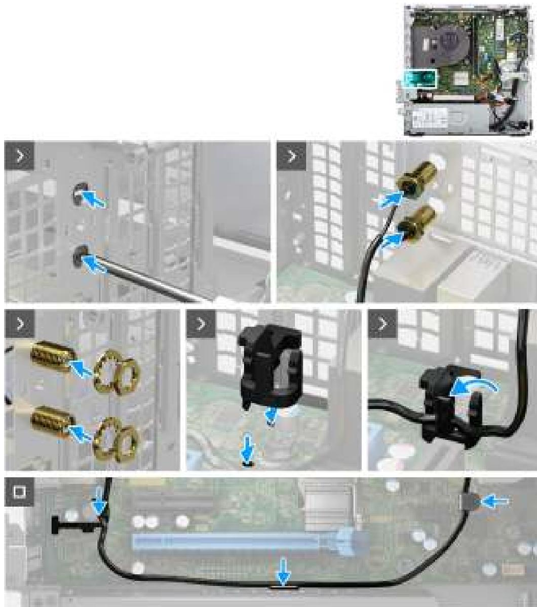
Figure 41. Installation du module d'antenne SMA externe
