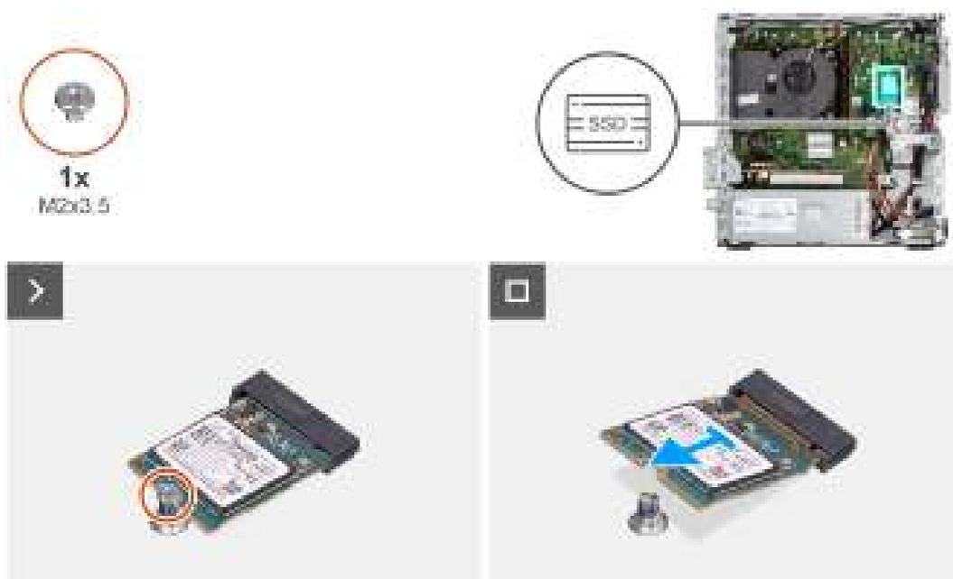
Figure 17. Retrait du disque SSD M.2 2230
