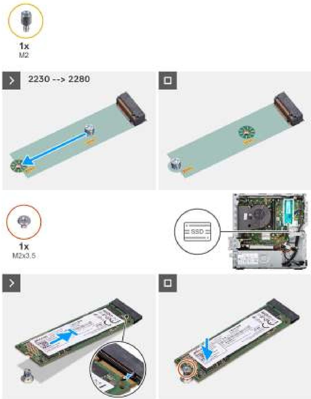
Figure 20. Installation du disque SSD M.2 2280
