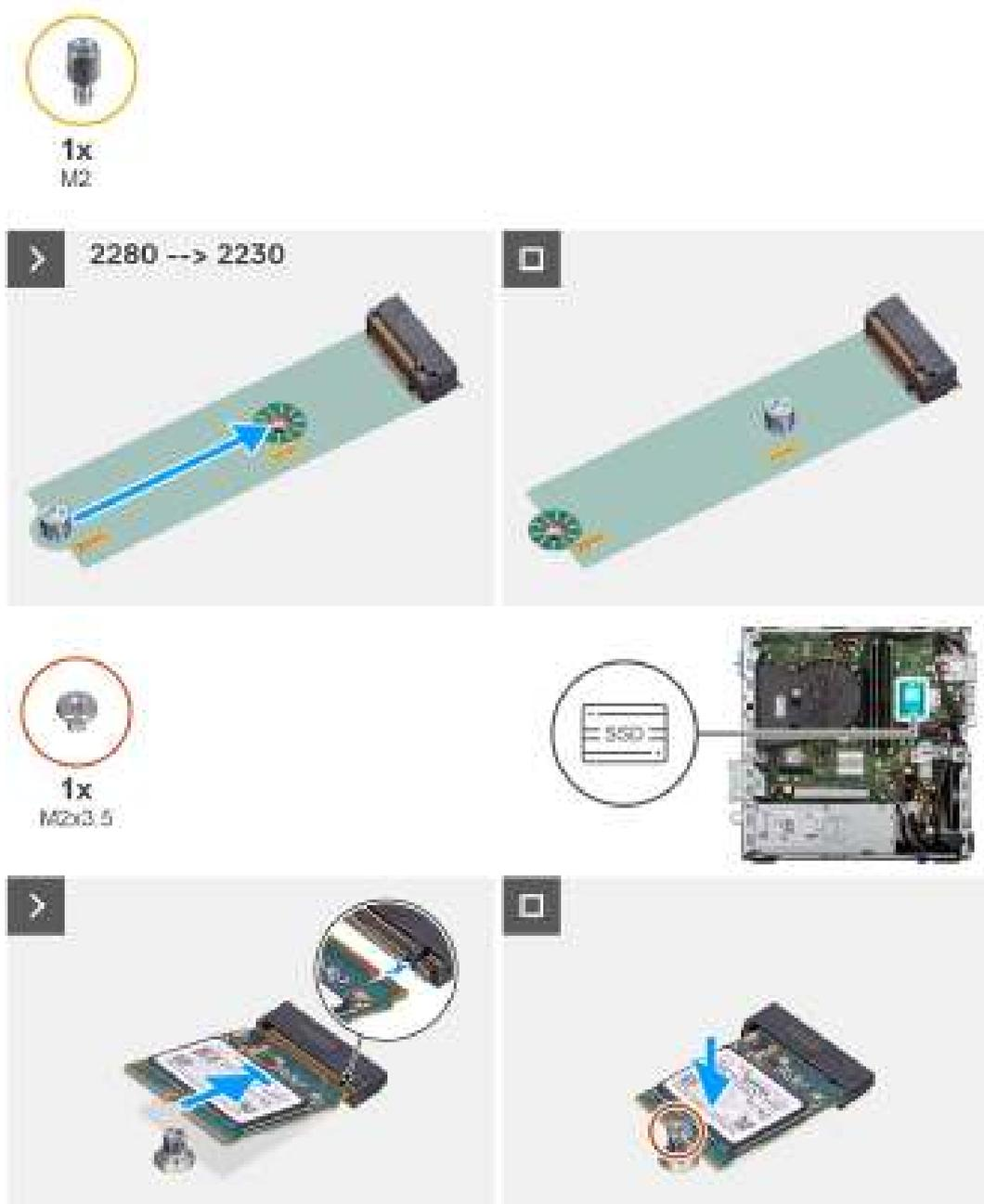
Figure 18. Installation des disques SSD M.2 2230
