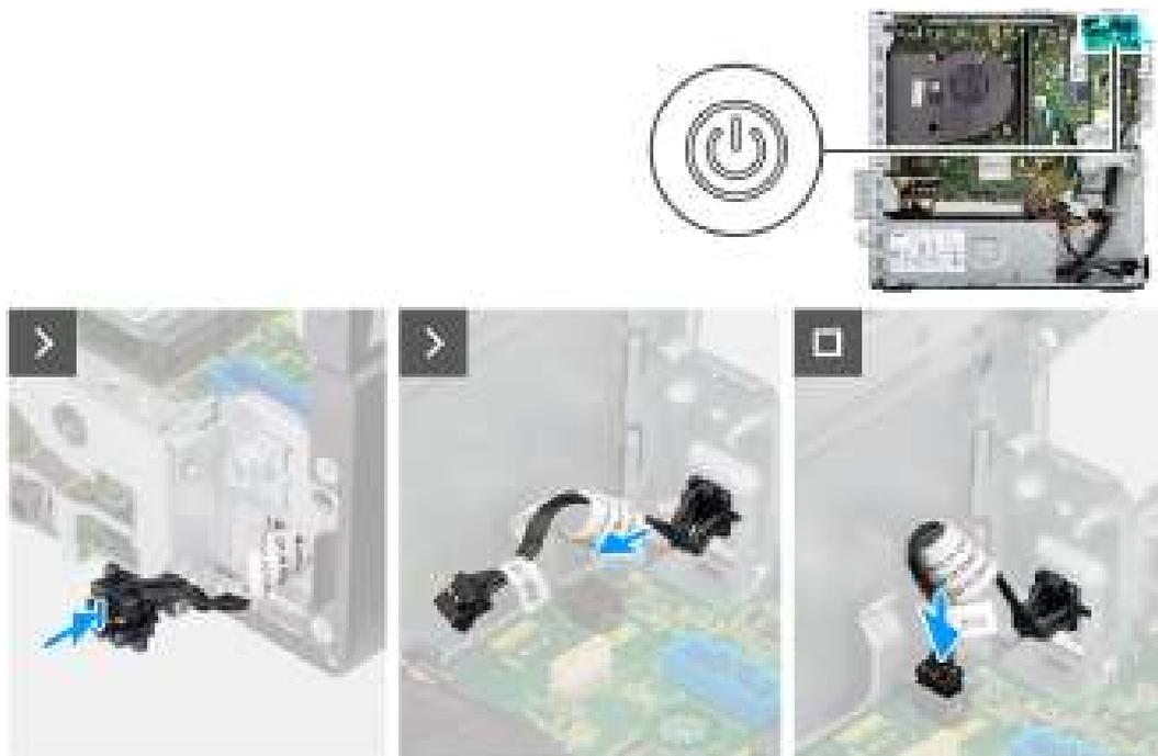
Figure 36. Installation du bouton d'alimentation
