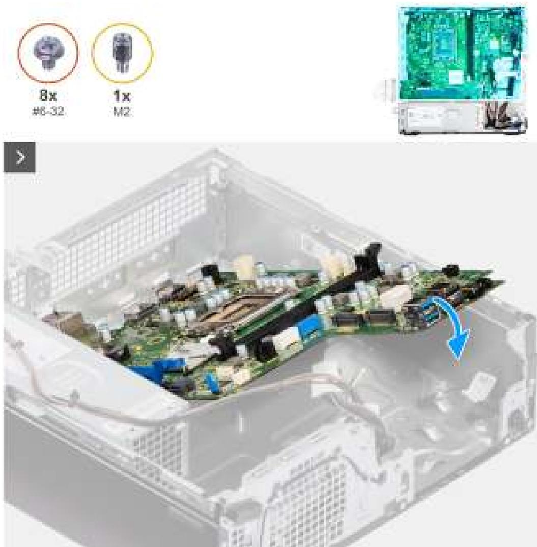
**Figure 62. Installation de la carte système**
