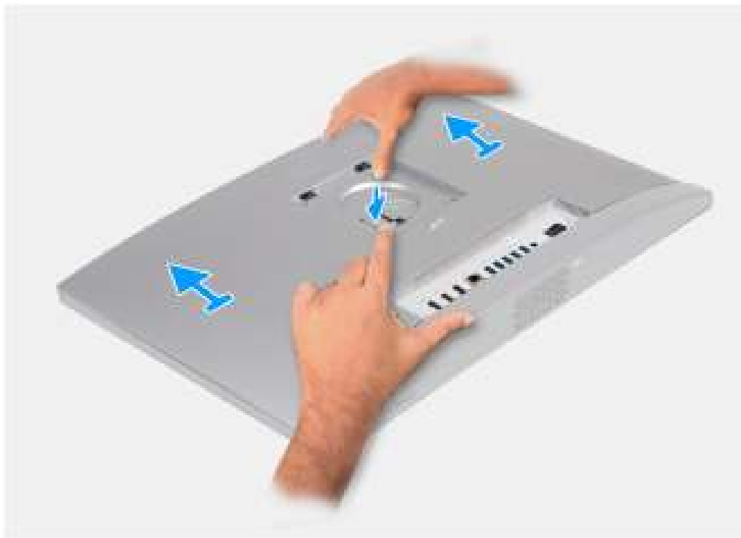
Figure 19. Retrait du capot arrière
