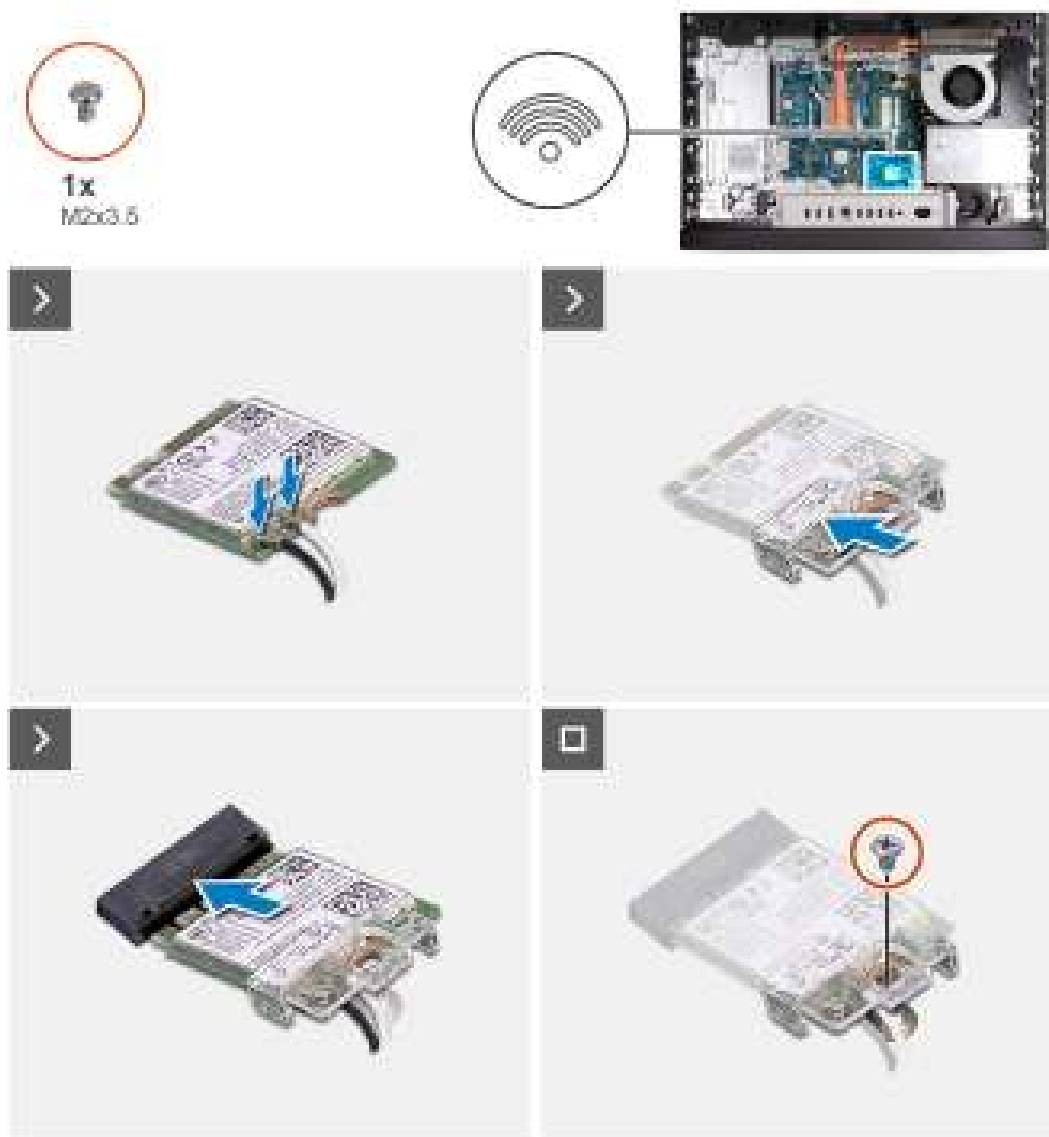
Figure 28. Installation de la carte sans fil
