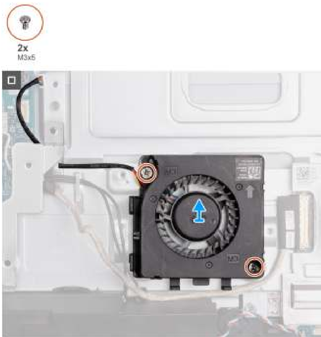
Figure 53. Retrait du ventilateur du bloc d'alimentation
