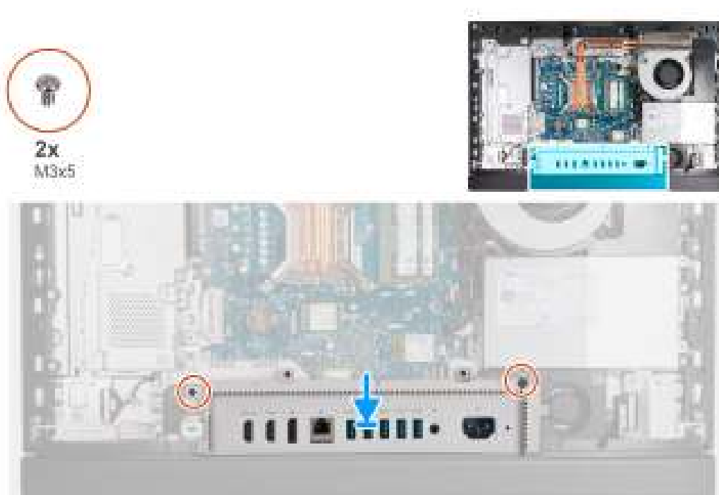
Figure 42. Installation du cache d'E/S
