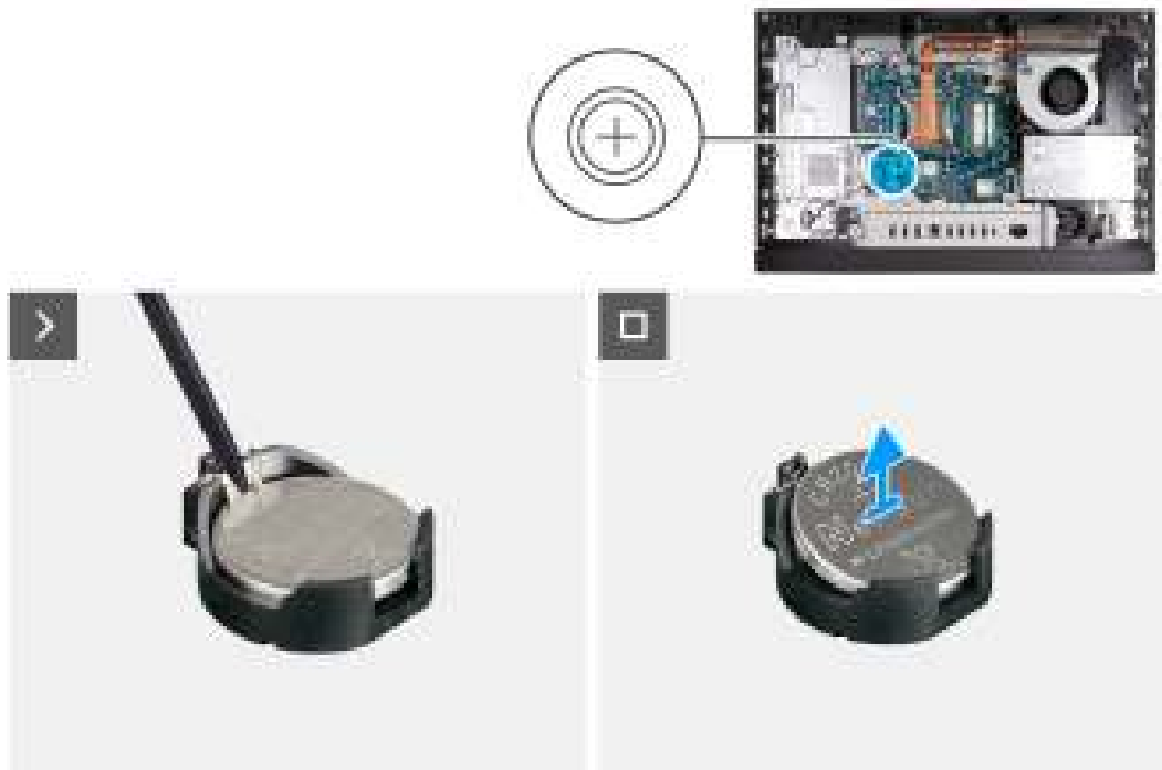
Figure 39. Retrait de la pile bouton
