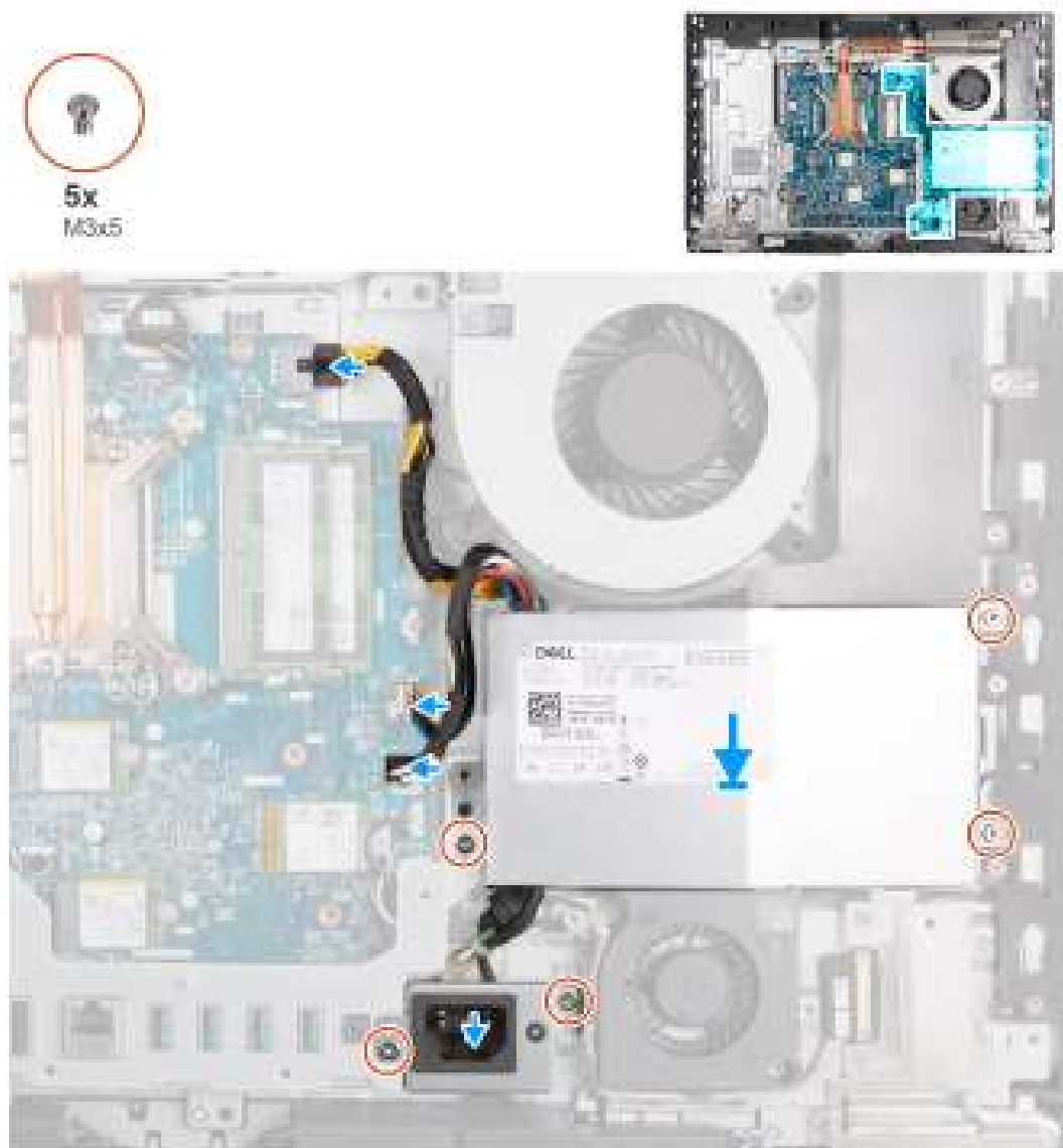
Figure 50. Installation du bloc d'alimentation
