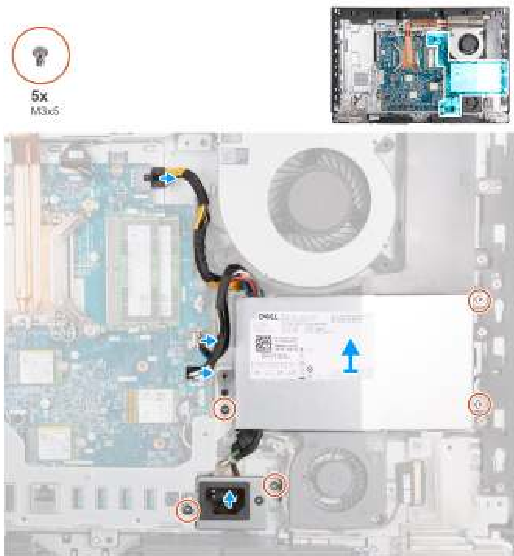
Figure 49. Retrait du bloc d'alimentation
