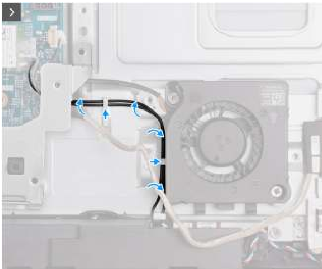
Figure 55. Installation du ventilateur du bloc d'alimentation
