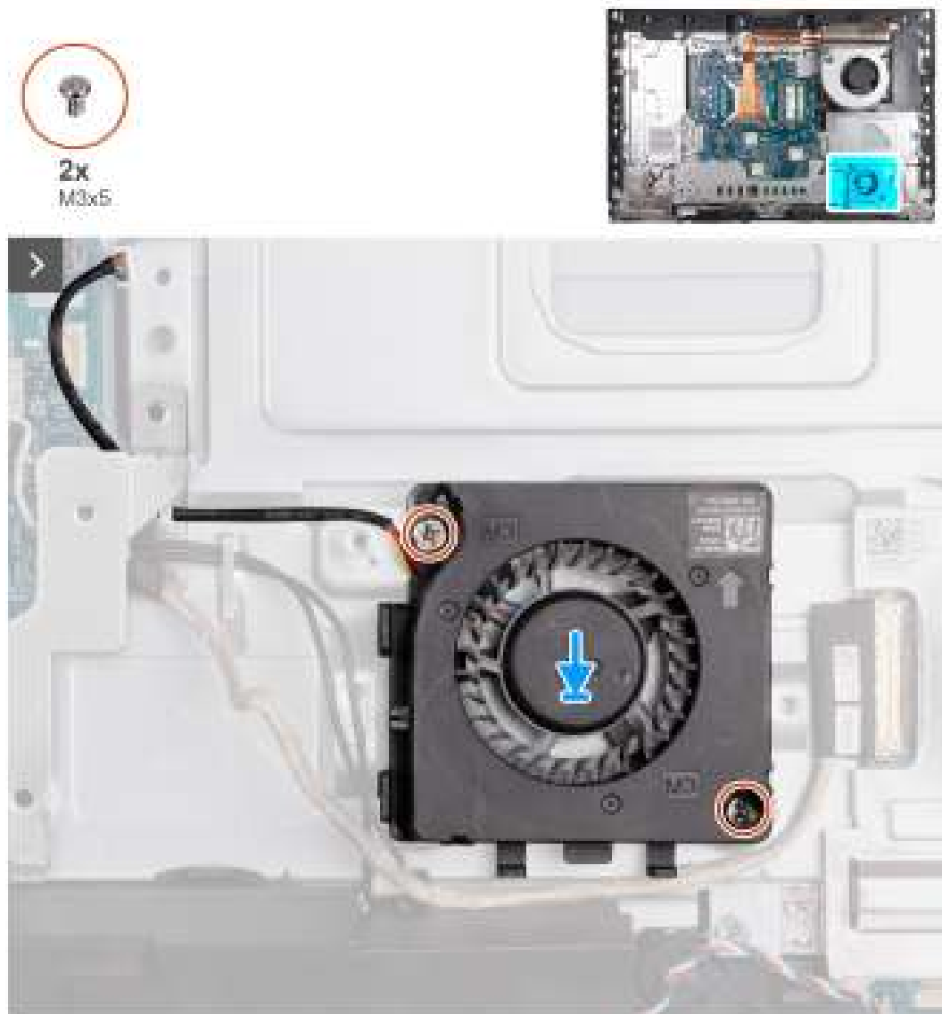
Figure 54. Installation du ventilateur du bloc d'alimentation
