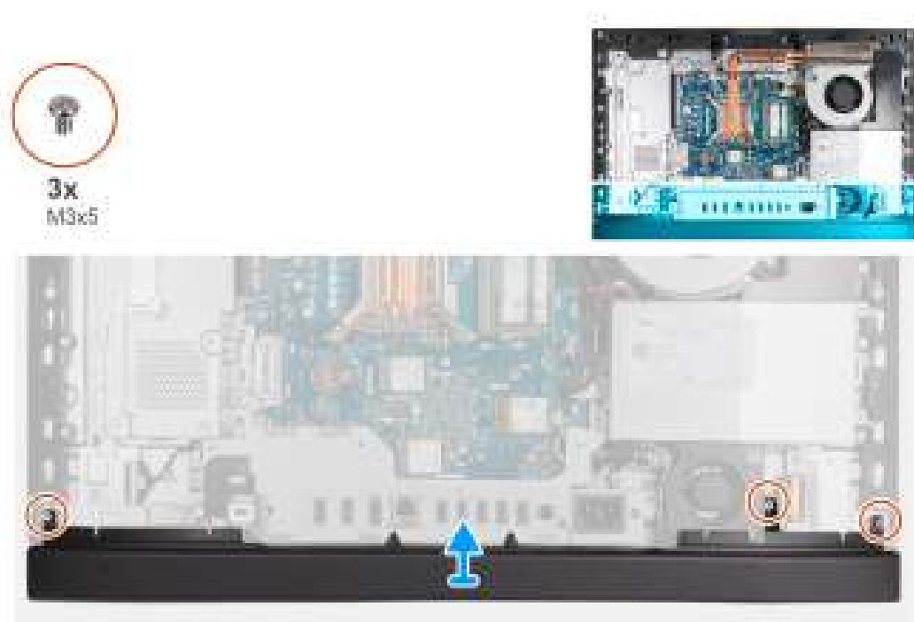
Figure 43. Retrait du cache inférieur
