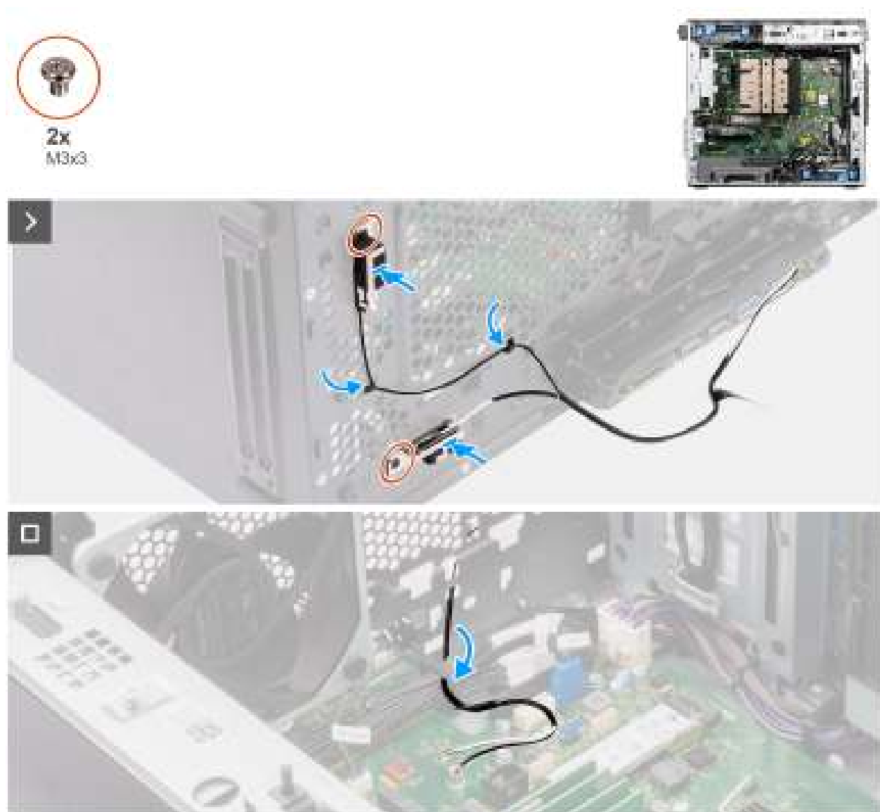
Figure 29. Installation de l'antenne interne WLAN
