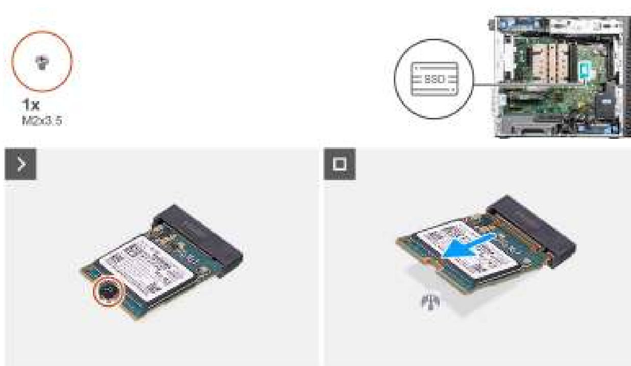
Figure 22. Retrait du disque SSD M.2 2230 PCIe
