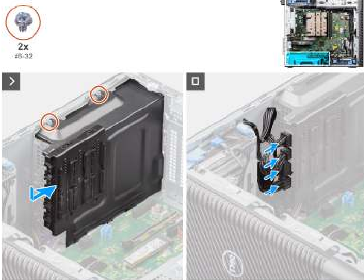
Figure 47. Installation du capot du bloc d'alimentation
