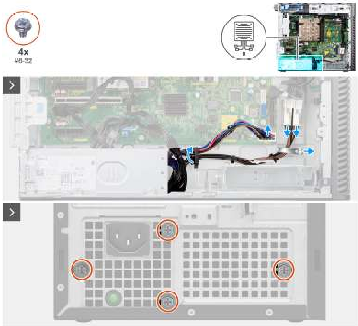
Figure 48. Retrait du bloc d'alimentation de 1 000 W
