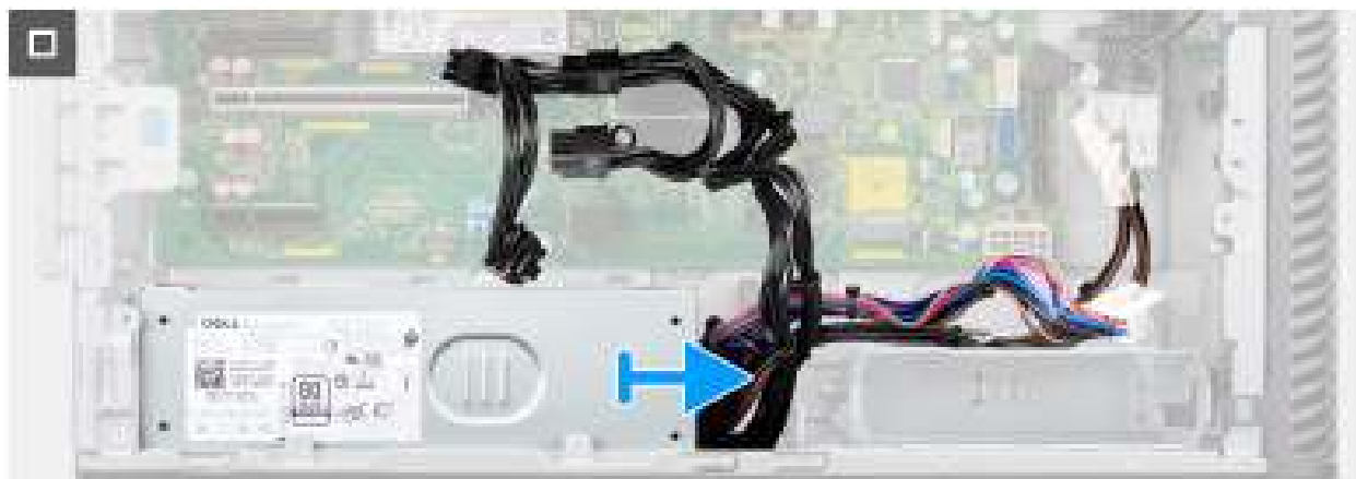
Figure 49. Retrait du bloc d'alimentation de 1 000 W
