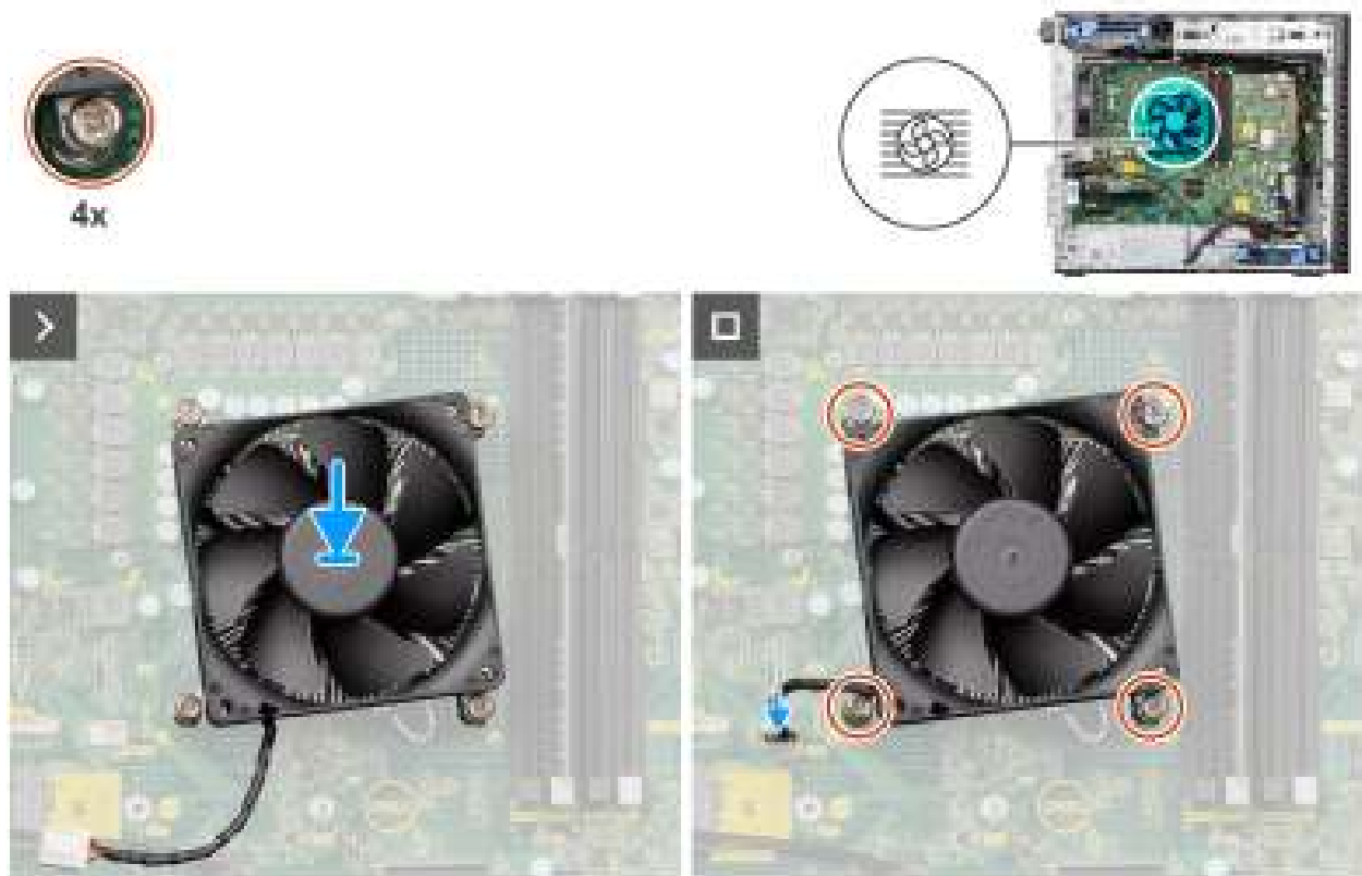
Figure 55. Installation de l'assemblage du ventilateur et du dissipateur de chaleur 65 W du processeur
