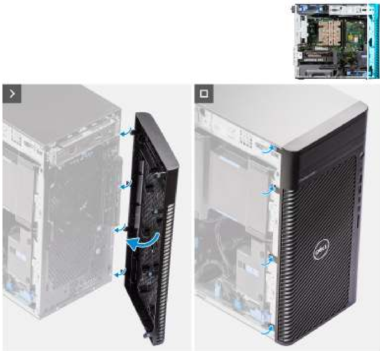
Figure 13. Installation du panneau avant
