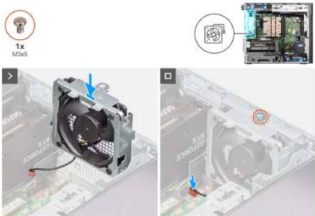
Figure 67. Installation du ventilateur arrière (bloc d'alimentation de 1 000 W)
