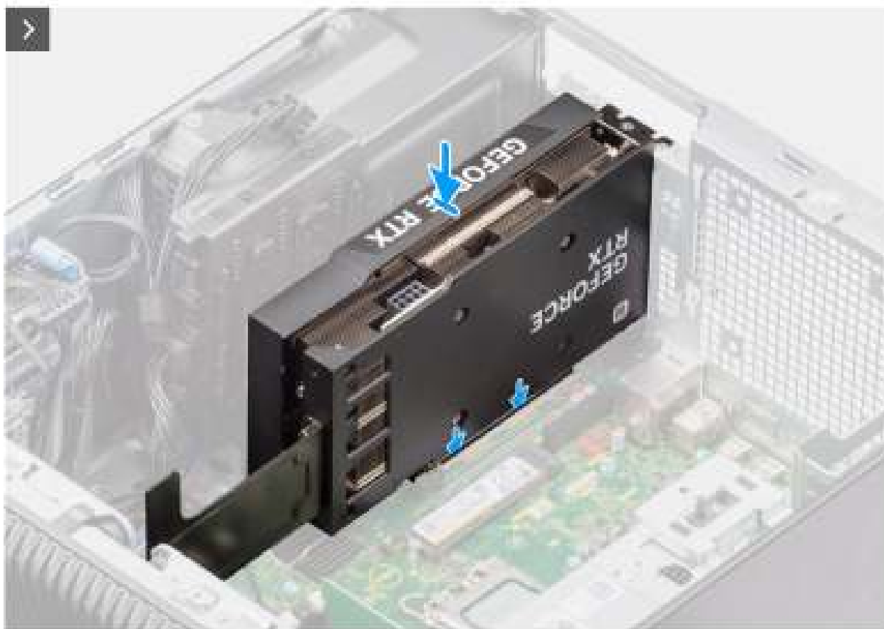
Figure 44. Installation du processeur graphique alimenté
