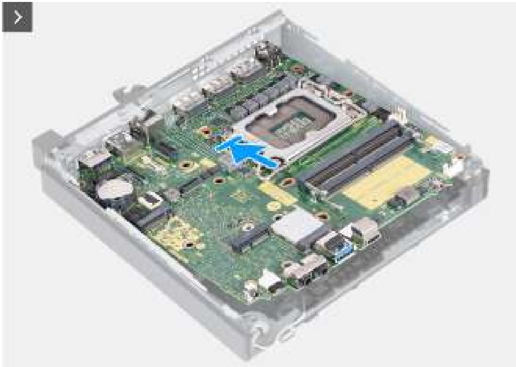
Figure 48. Installation de la carte système
