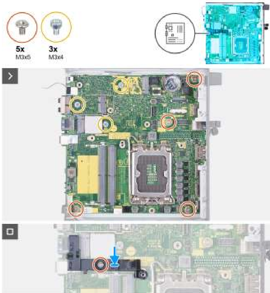
Figure 49. Installation de la carte système
