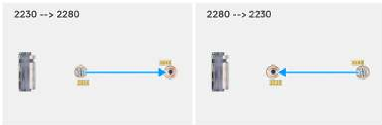
Figure 27. Déplacement du support à vis pour prendre en charge un autre format (OptiPlex Micro 7020)
