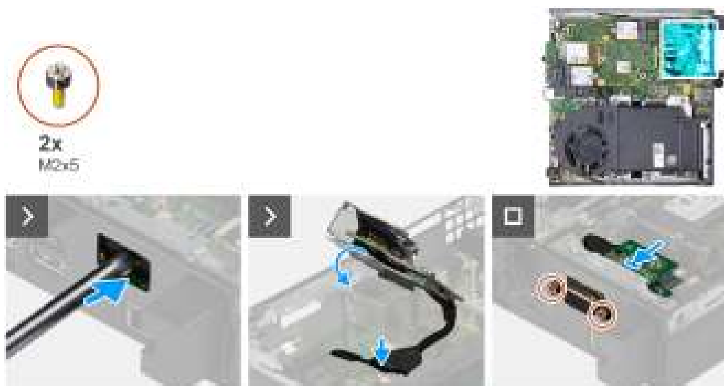
Figure 37. Installation du module d'E/S en option (VGA ou série)
