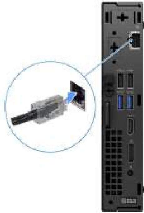
Figure 4. Connectez-vous à votre réseau à l'aide d'un câble
