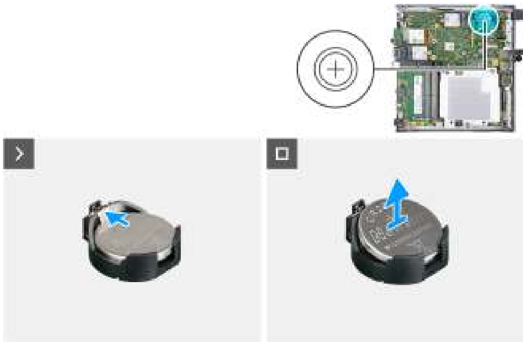
Figure 13. Retrait de la pile bouton
