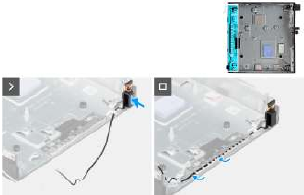
Figure 53. Installation du module d'antenne (câble noir)
