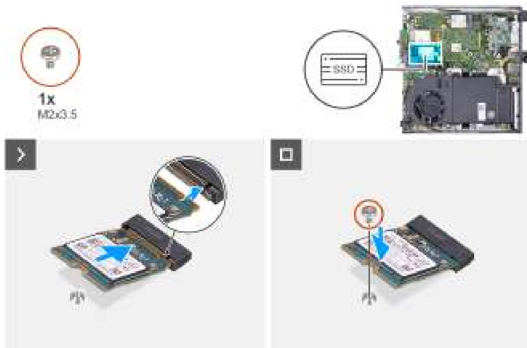
Figure 20. Installation du disque SSD 2230 dans le logement 0
