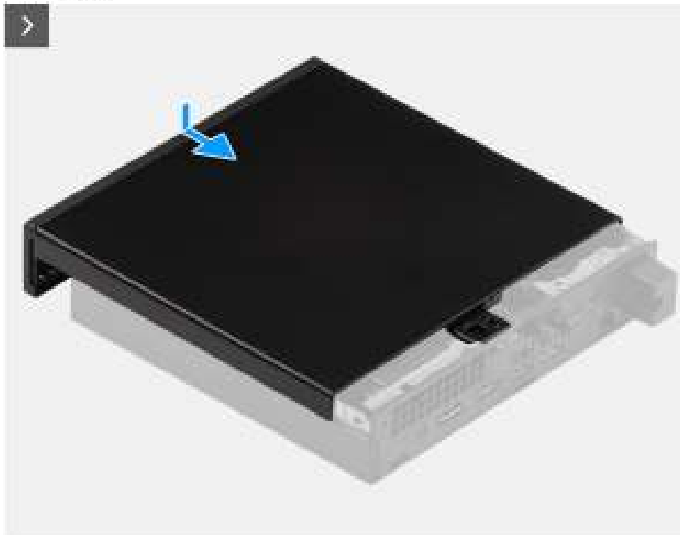
Figure 11. Installation du capot latéral
