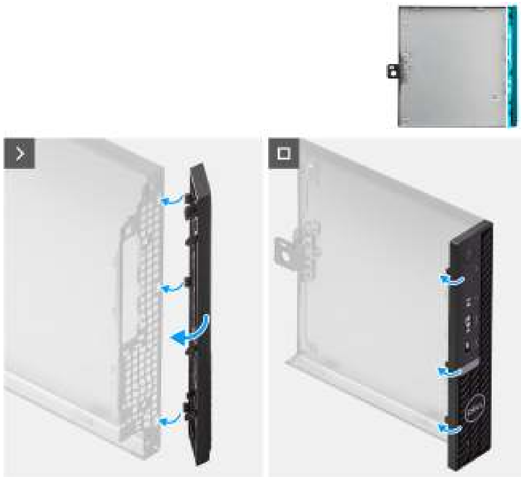
Figure 16. Installation du panneau avant
