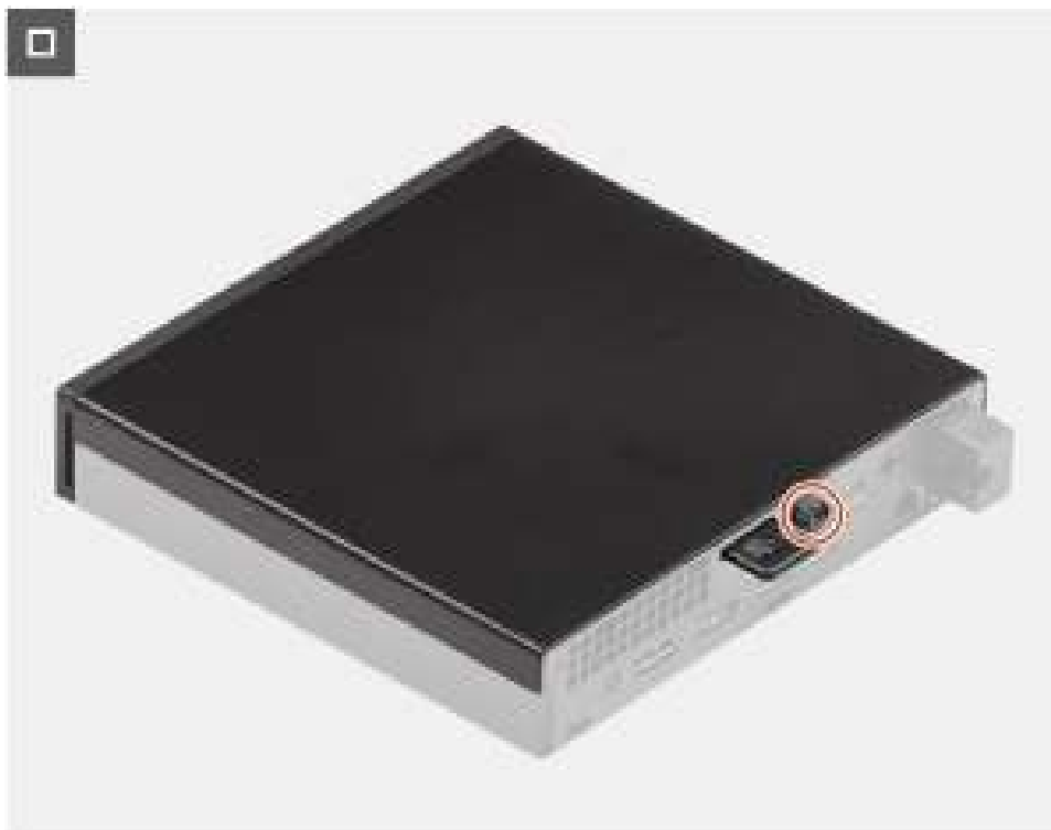
Figure 12. Installation du capot latéral
