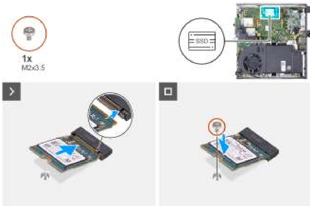
Figure 24. Installation du disque SSD M.2 2230 dans le logement 1
