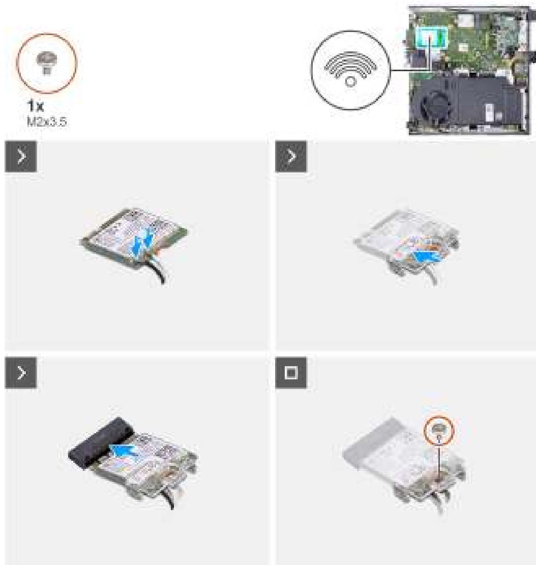
Figure 29. Installation de la carte sans fil
