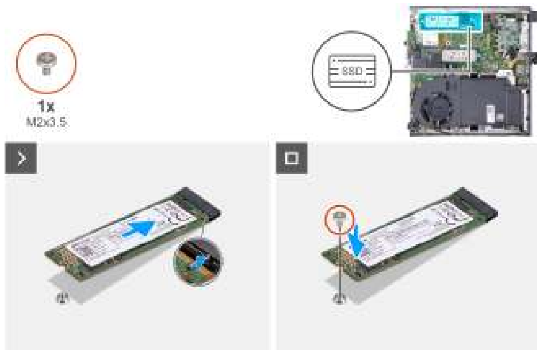
Figure 26. Installation du disque SSD M.2 2280 dans le logement 1
