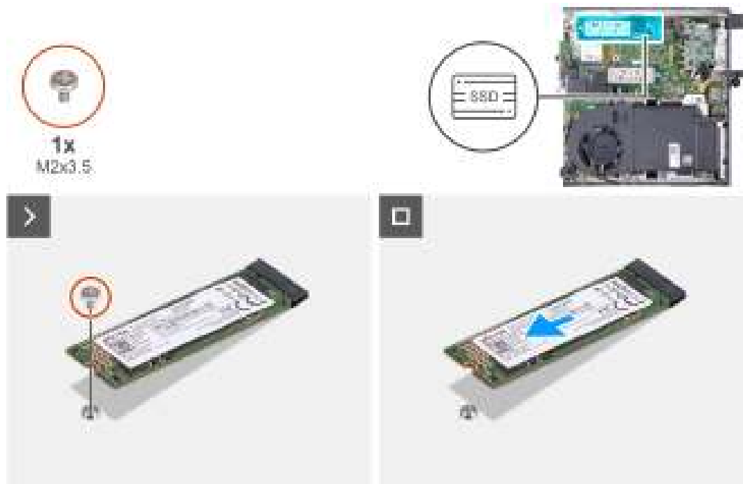
Figure 25. Retrait du disque SSD M.2 2280 du logement 1
