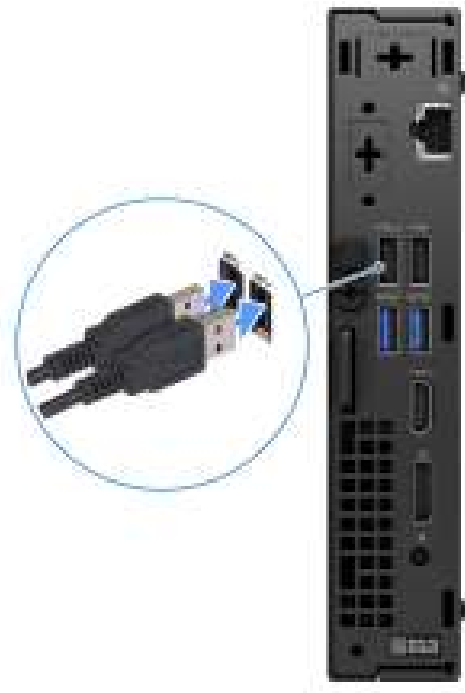
Figure 3. Connexion du clavier et de la souris à l'ordinateur OptiPlex Micro 7020
