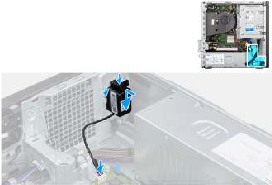
Figure 32. Installation du haut-parleur
