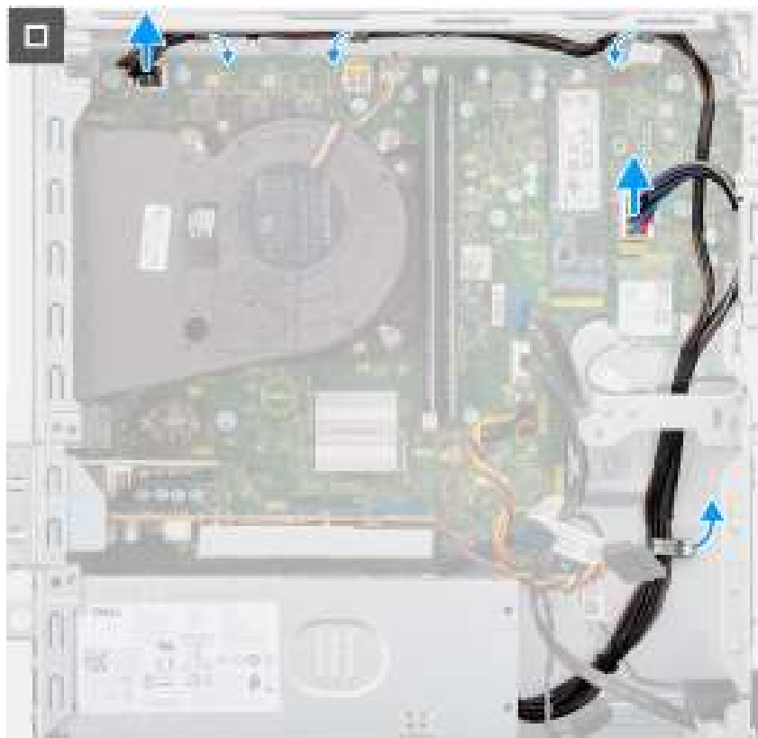
Figure 43. Installation du bloc d'alimentation
