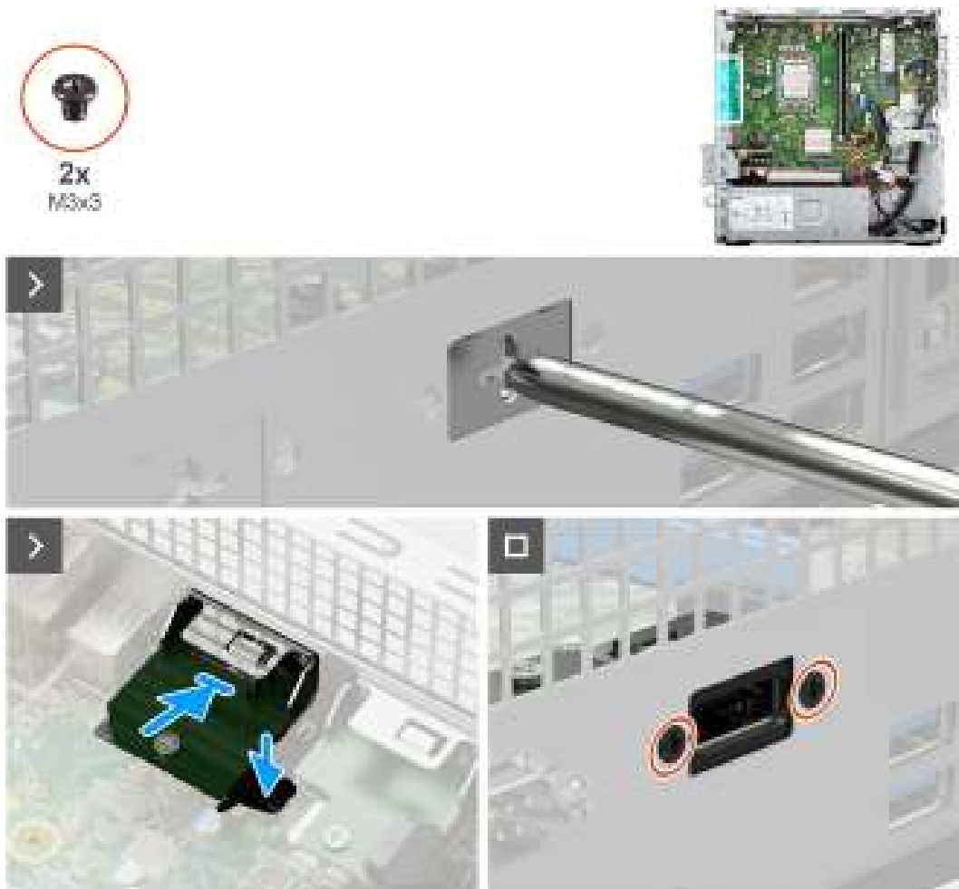
Figure 53. Installation du module DisplayPort
