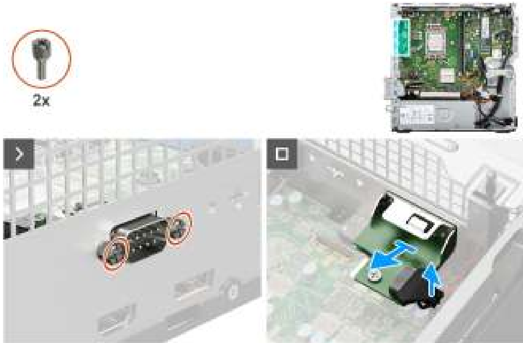
Figure 48. Retrait du module série
