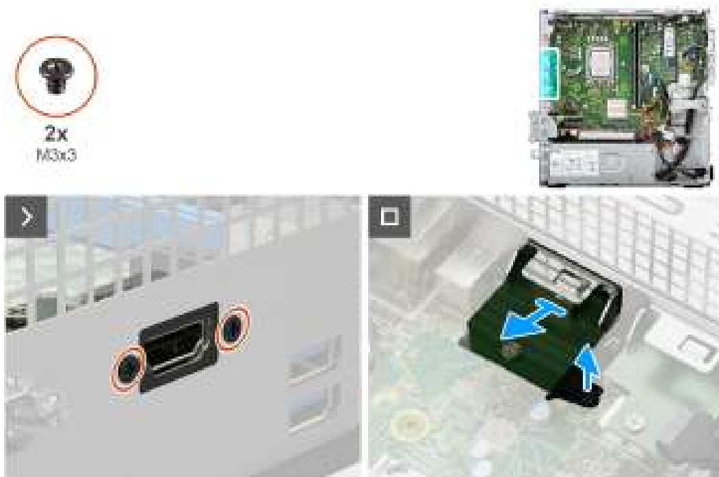
Figure 54. Retrait du module HDMI
