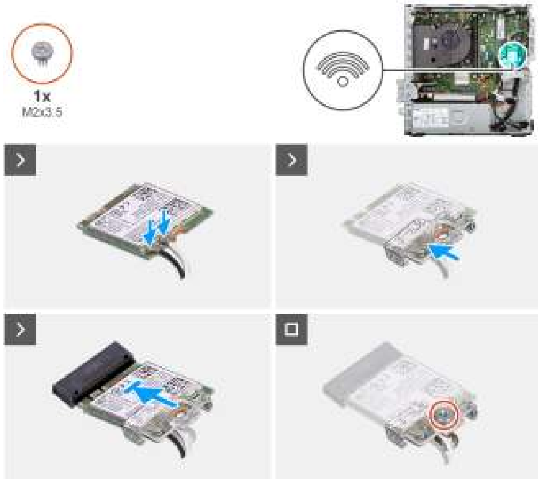
Figure 28. Installation de la carte sans fil
