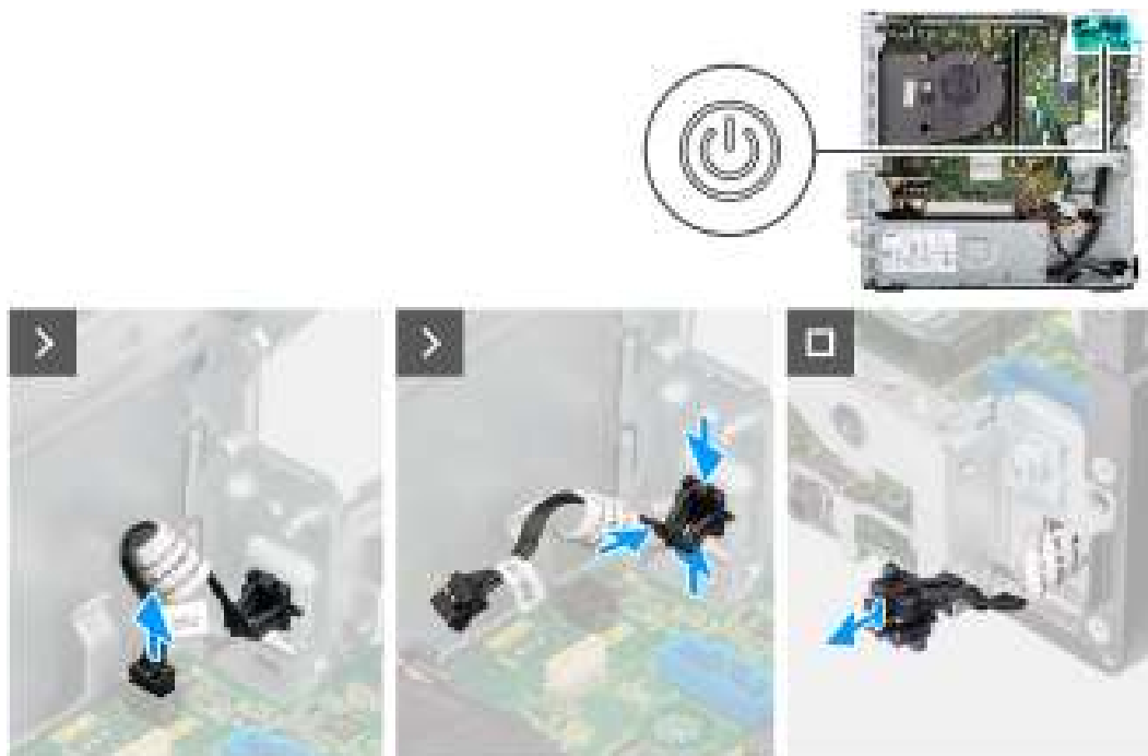
Figure 35. Retrait du bouton d'alimentation
