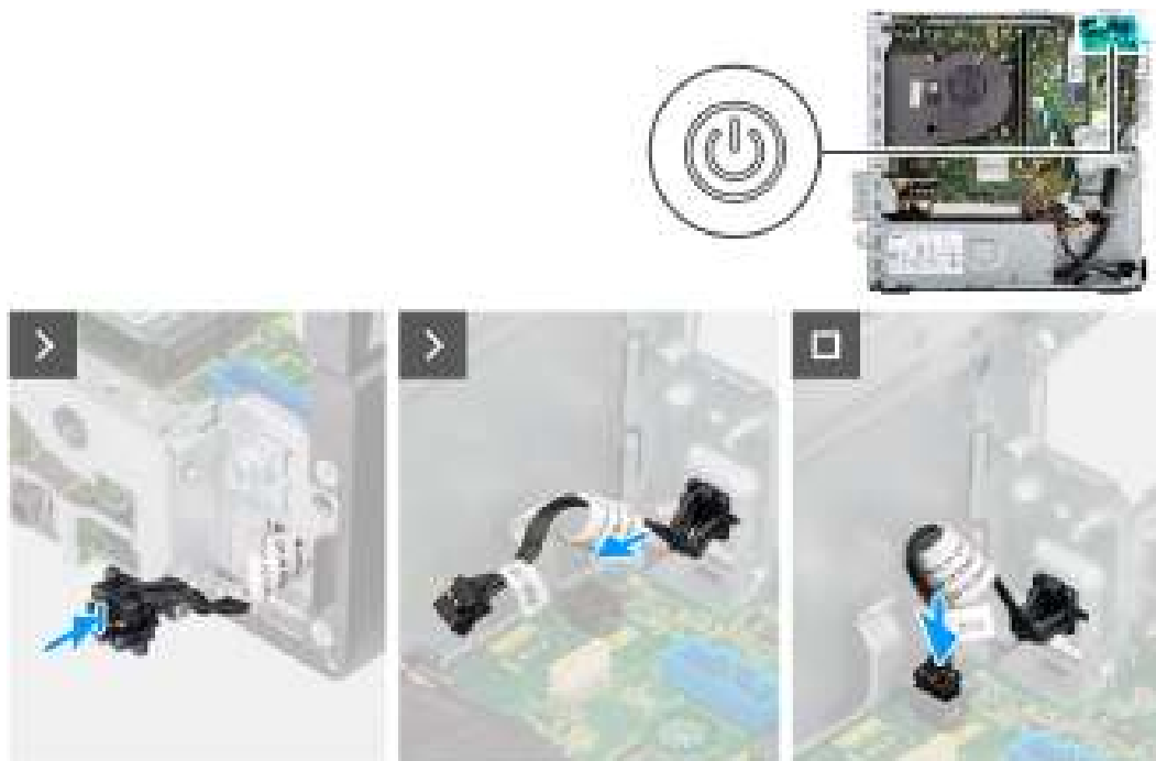
Figure 36. Installation du bouton d'alimentation
