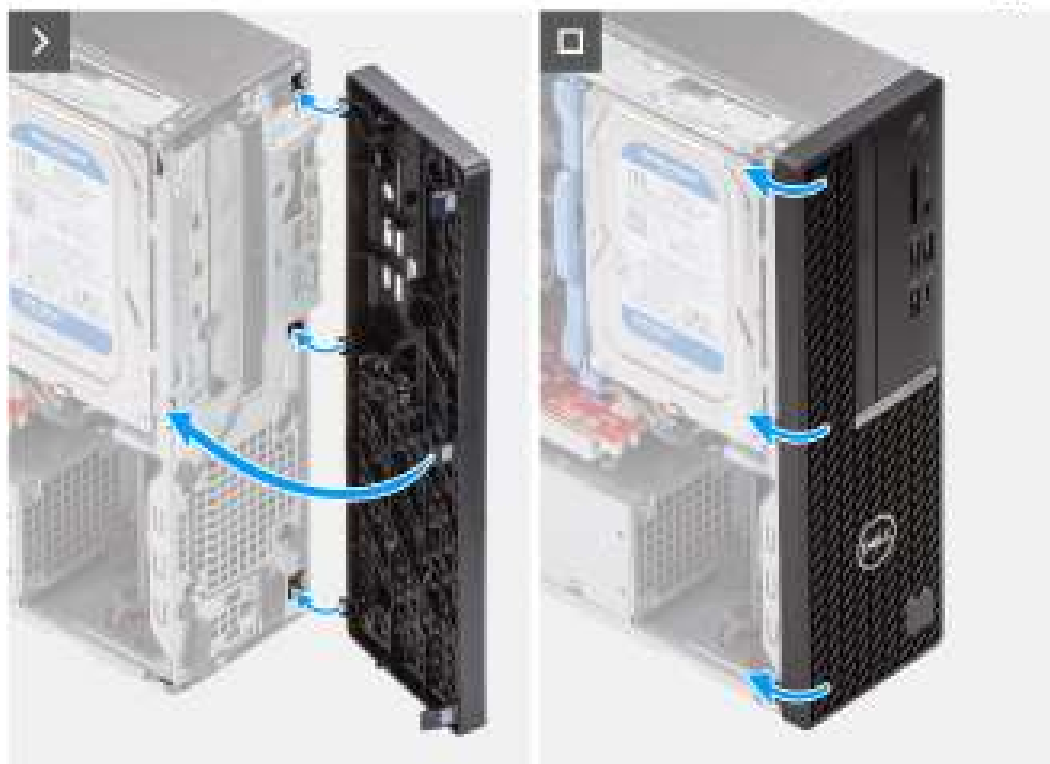
Figure 8. Installation du panneau avant
