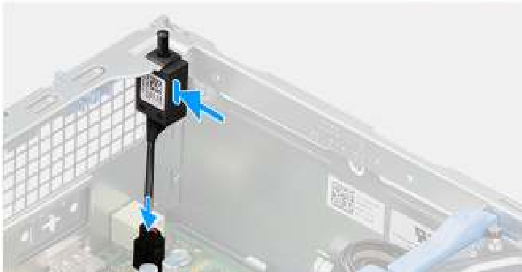
Figure 34. Installation du commutateur d'intrusion
