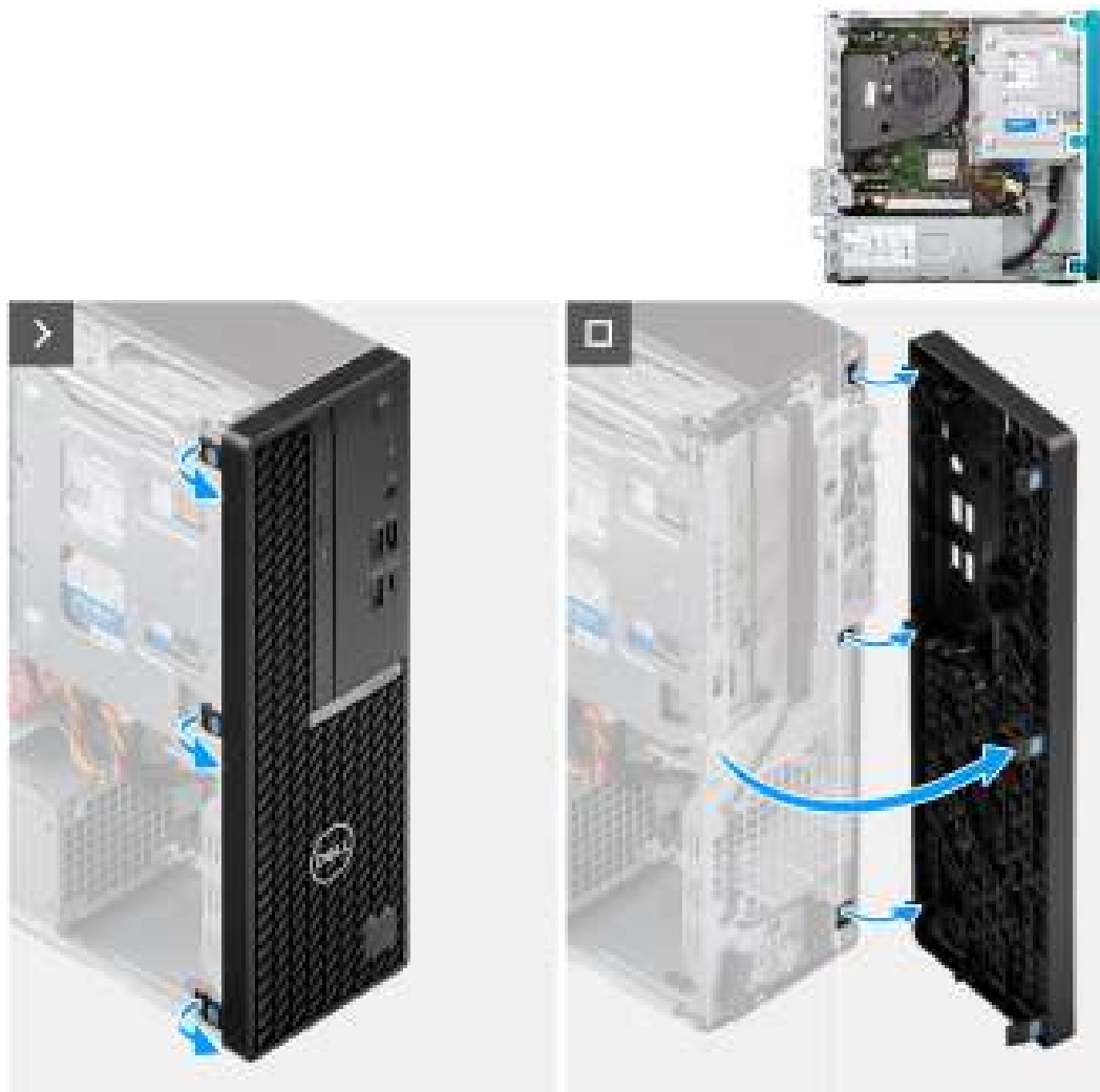
Figure 7. Retrait du panneau avant
