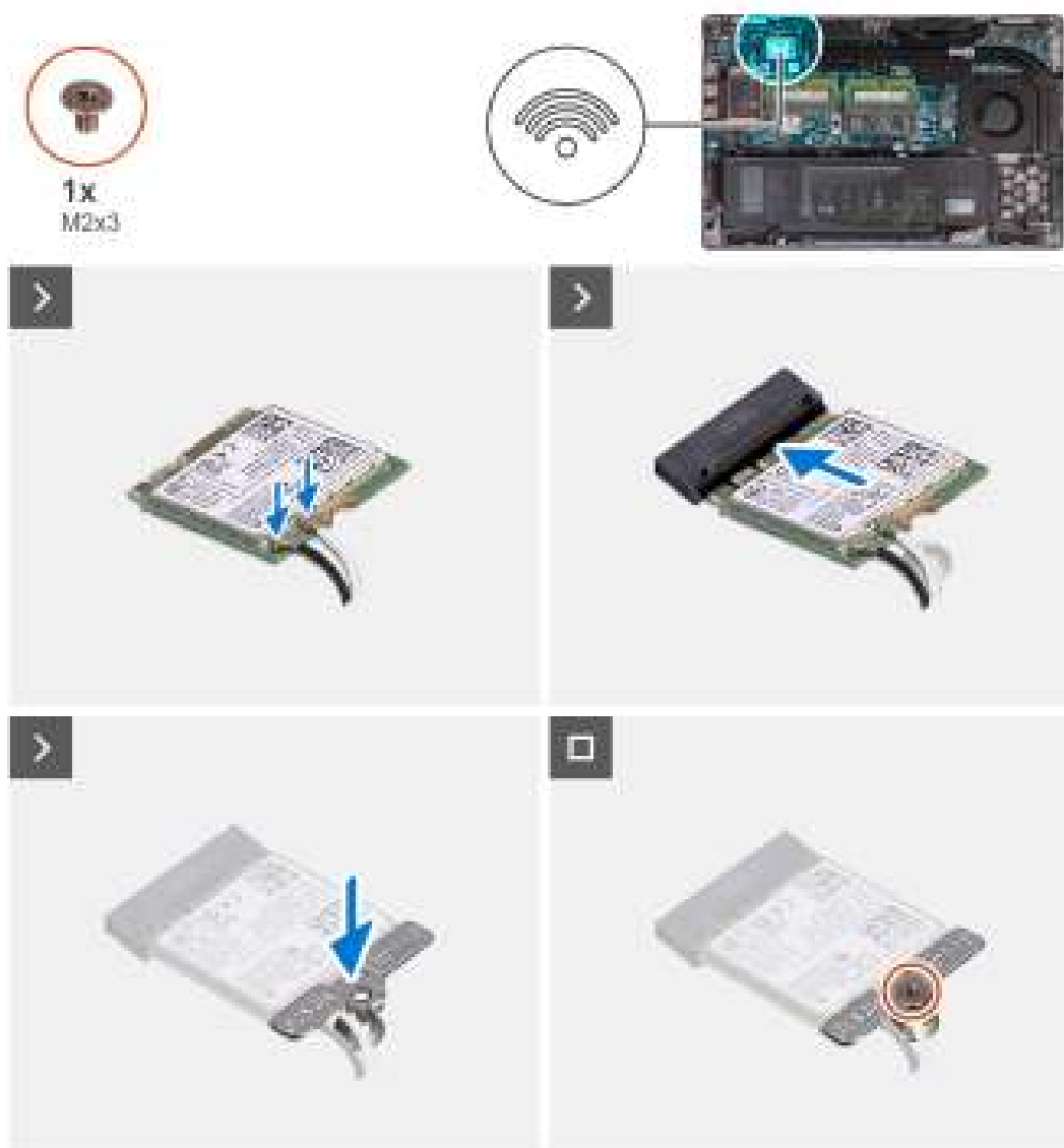
Figure 20. Installation de la carte sans fil
