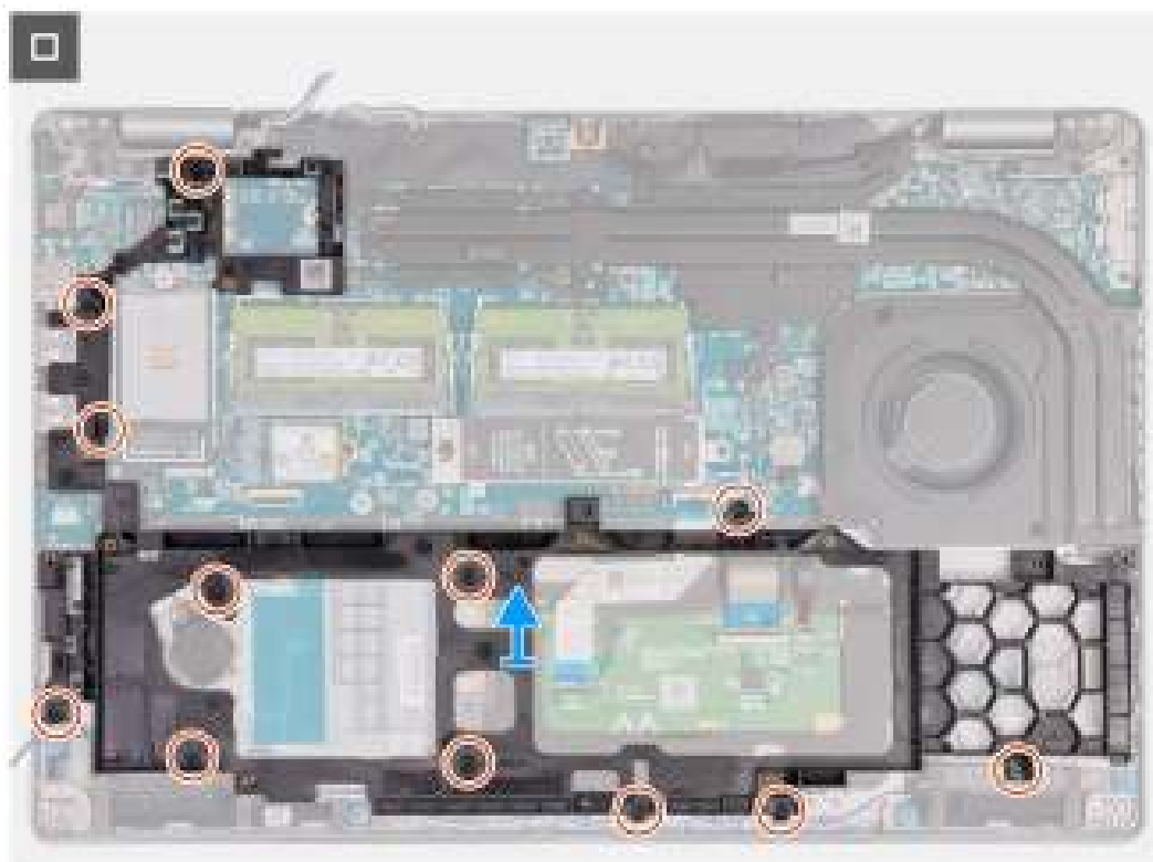
Figure 38. Retrait du cadre interne de l'assemblage
