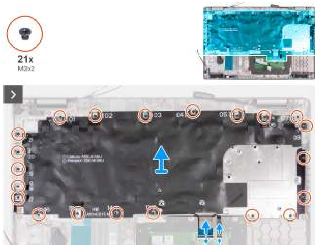
Figure 65. Retrait du clavier
