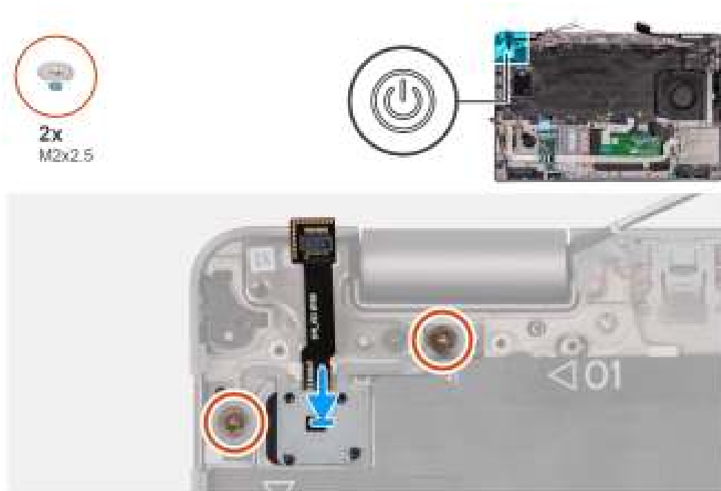
Figure 64. Installation du bouton d'alimentation avec lecteur d'empreintes digitales (en option)
