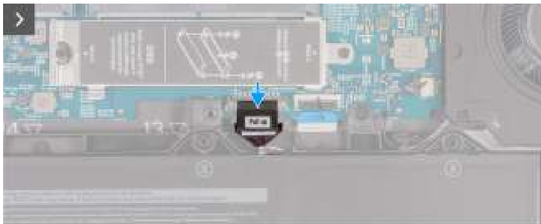
Figure 16. Connexion du câble de la batterie
