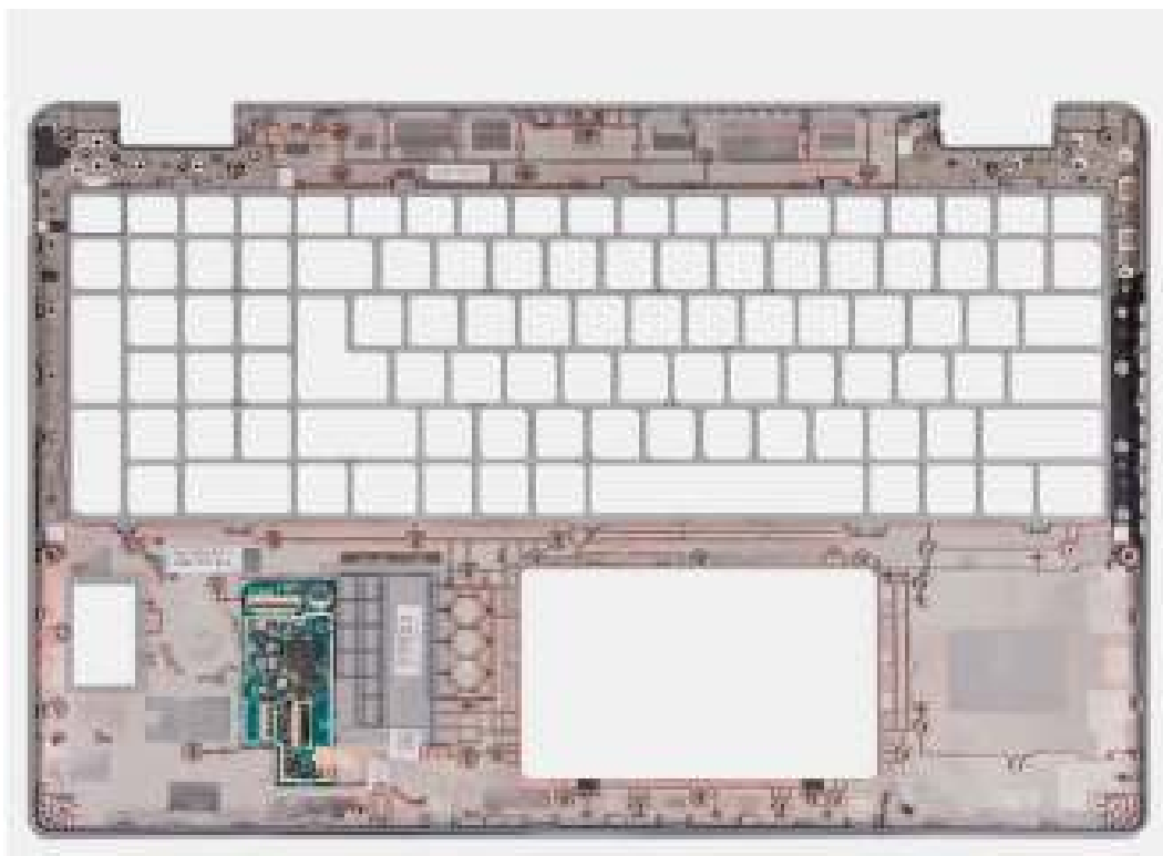
Figure 100. Retrait de l'assemblage du repose-poignets
