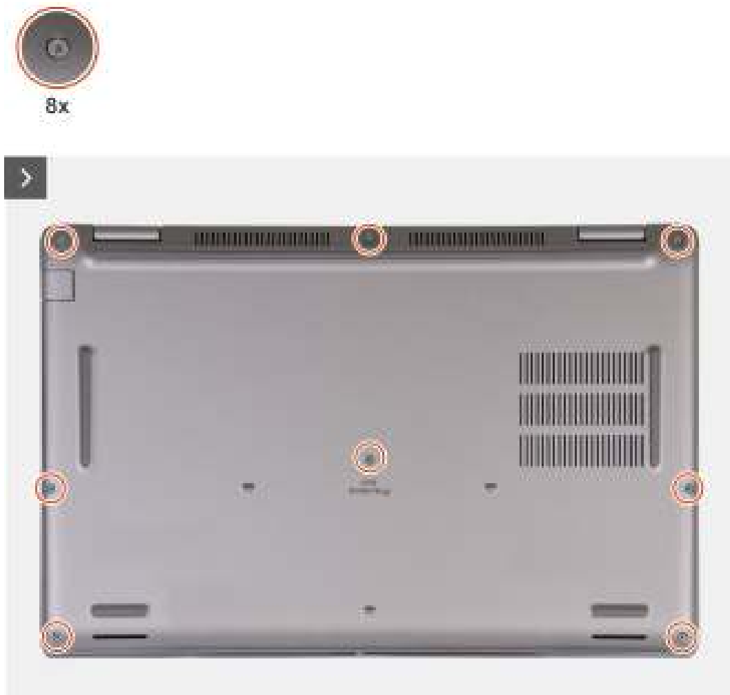
Figure 13. Desserrage des vis imperdables
