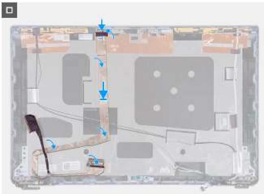
Figure 91. Installation du câble de l'écran
