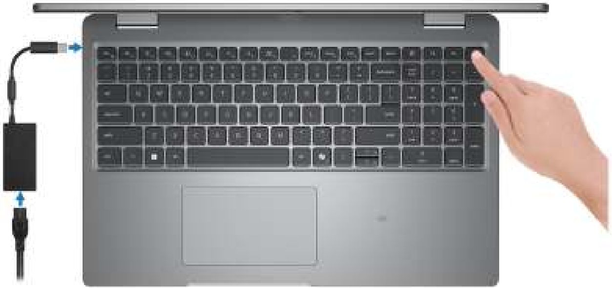
Figure 8. Branchez l'adaptateur secteur (AC) et appuyez sur le bouton d'alimentation
