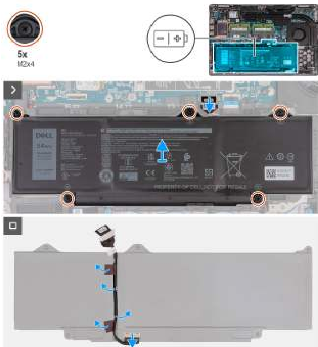
Figure 35. Retrait de la batterie
