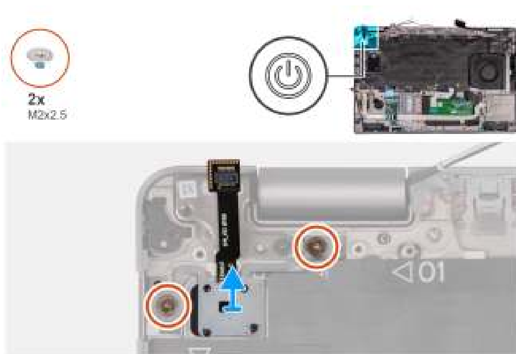
Figure 63. Retrait du bouton d'alimentation avec lecteur d'empreintes digitales (en option)
