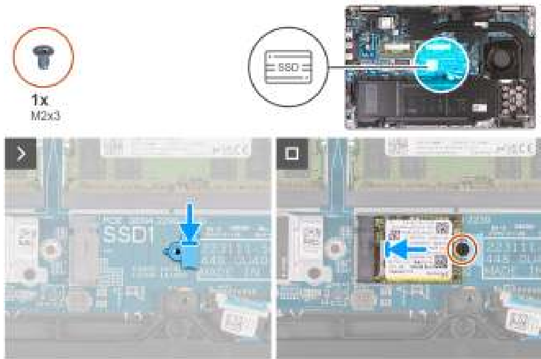
Figure 28. Installation du disque SSD M.2 2230 dans le logement 1
