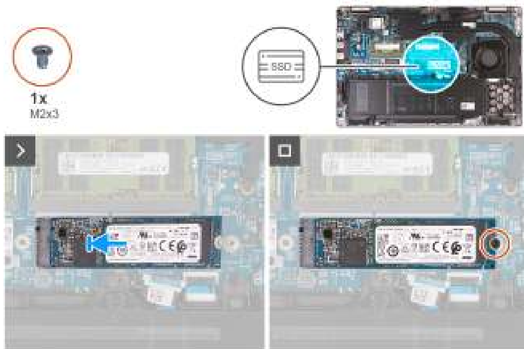
Figure 30. Installation du disque SSD M.2 2280 dans le logement 1
