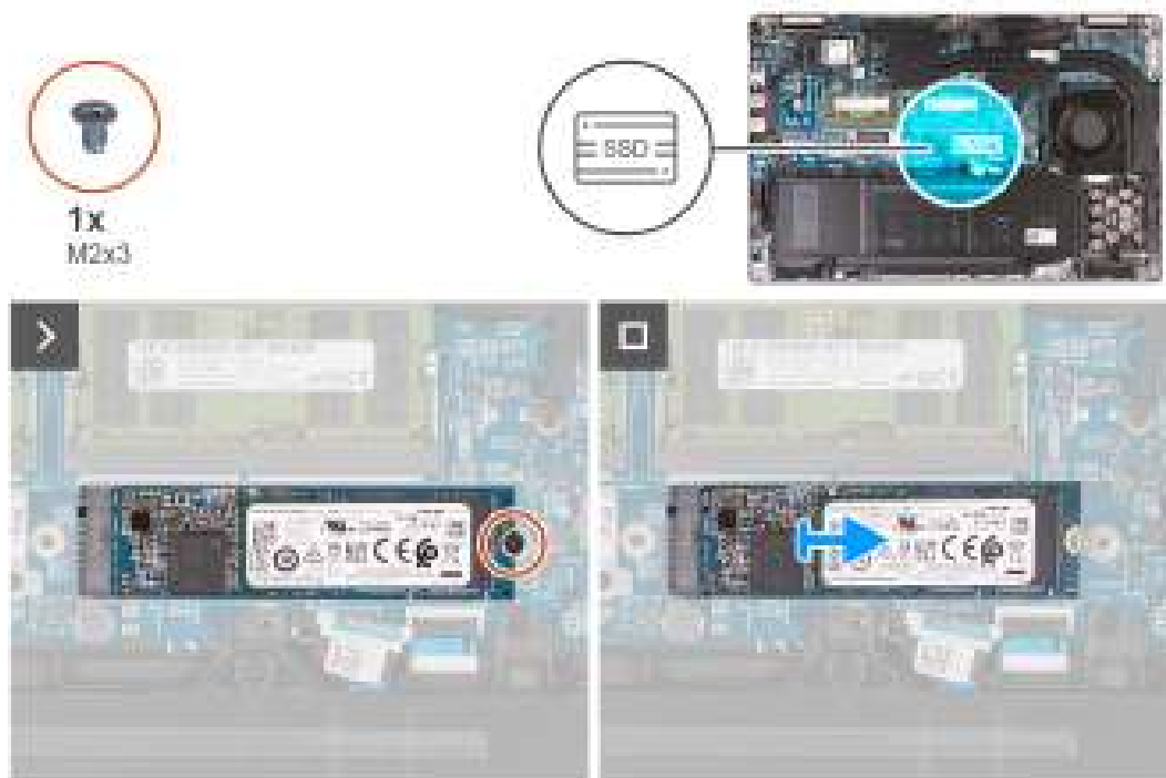
Figure 29. Retrait du disque SSD M.2 2280 du logement 1
