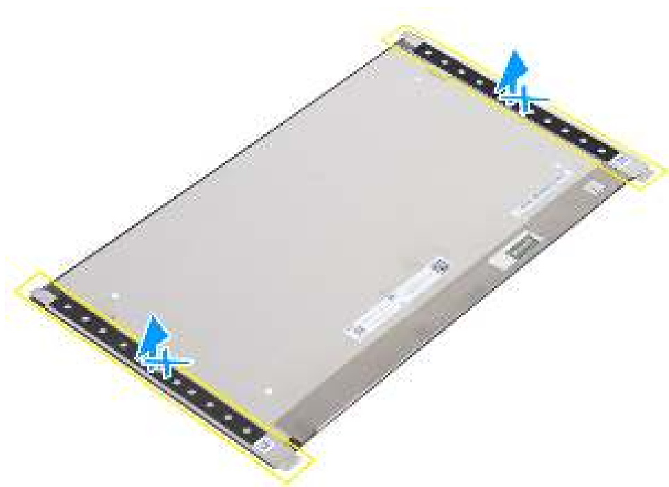
Figure 79. Ne pas tirer ni détacher les rubans étirables (SR)
