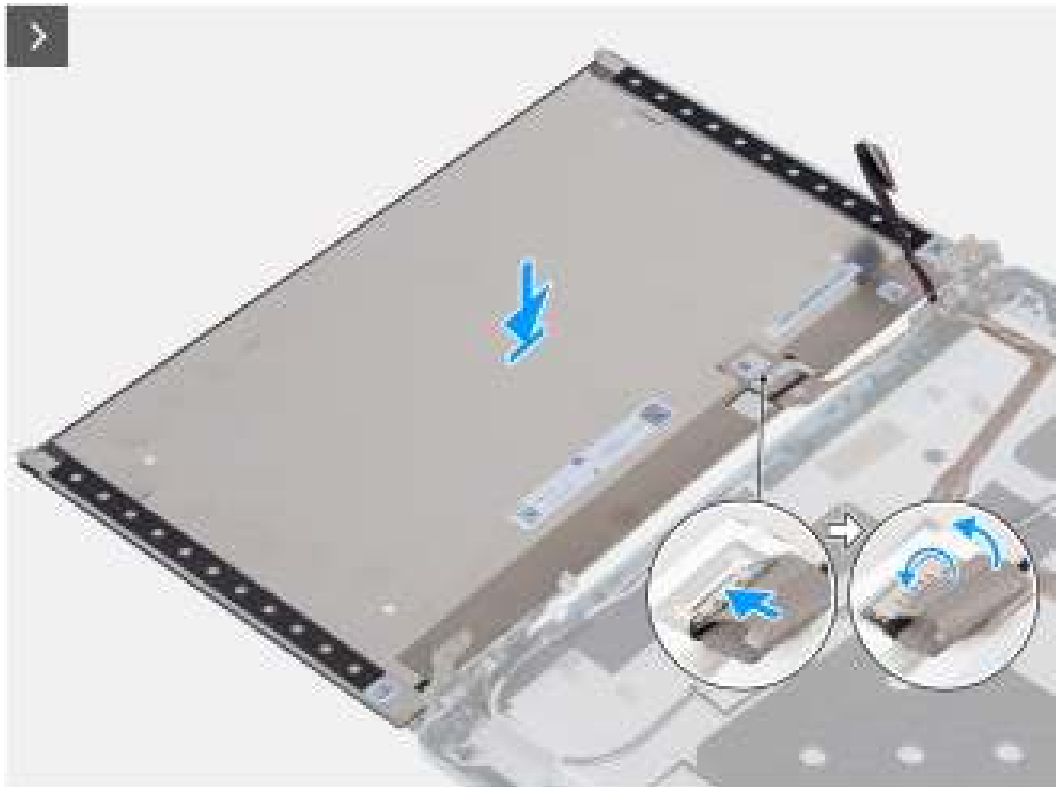
Figure 85. Installation du panneau d'écran
