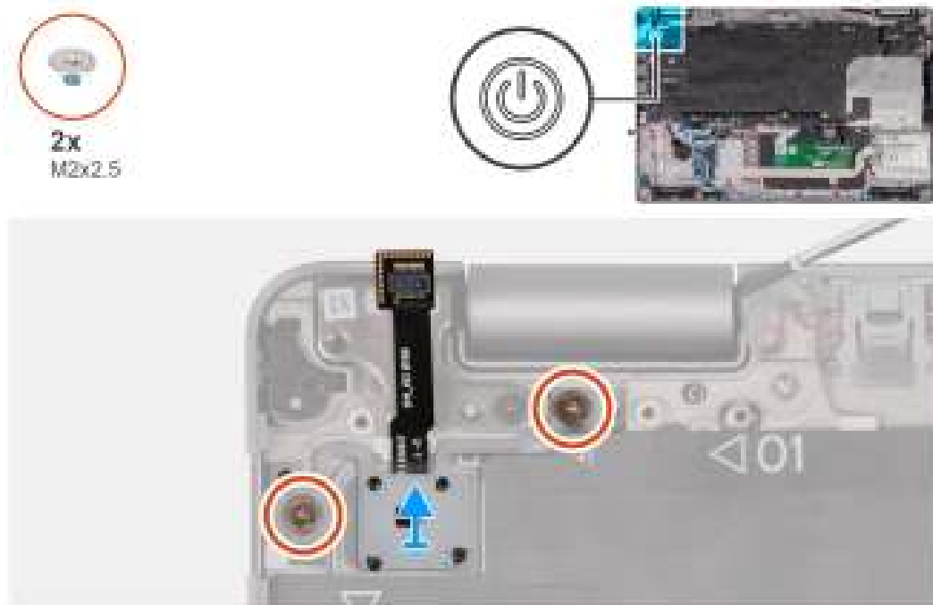
Figure 65. Retrait du bouton d'alimentation
