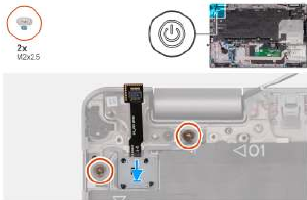
Figure 68. Installation du bouton d'alimentation avec lecteur d'empreintes digitales (en option)
