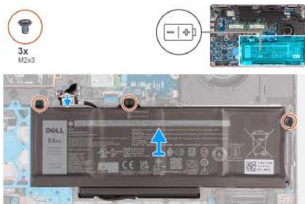
Figure 37. Retrait de la batterie - 64 Wh
