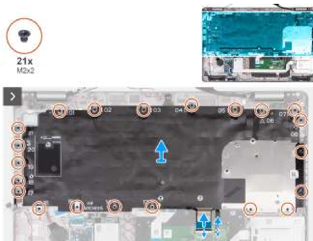
Figure 69. Retrait du clavier
