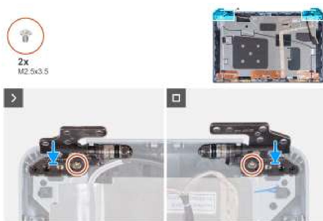
Figure 91. Installation des charnières d'écran
