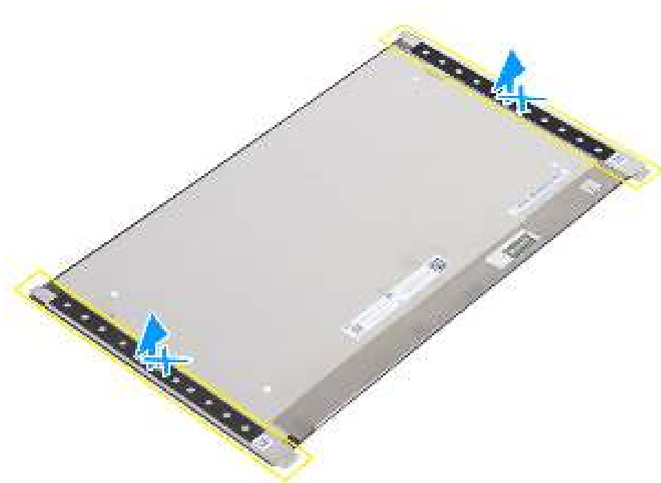
Figure 83. Ne pas tirer ni détacher les rubans étirables (SR)
