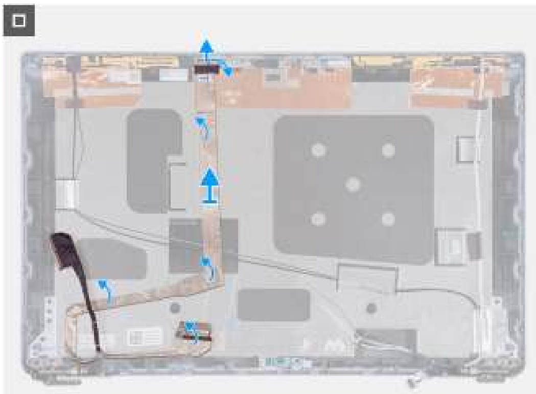
Figure 94. Retrait du câble de l'écran
