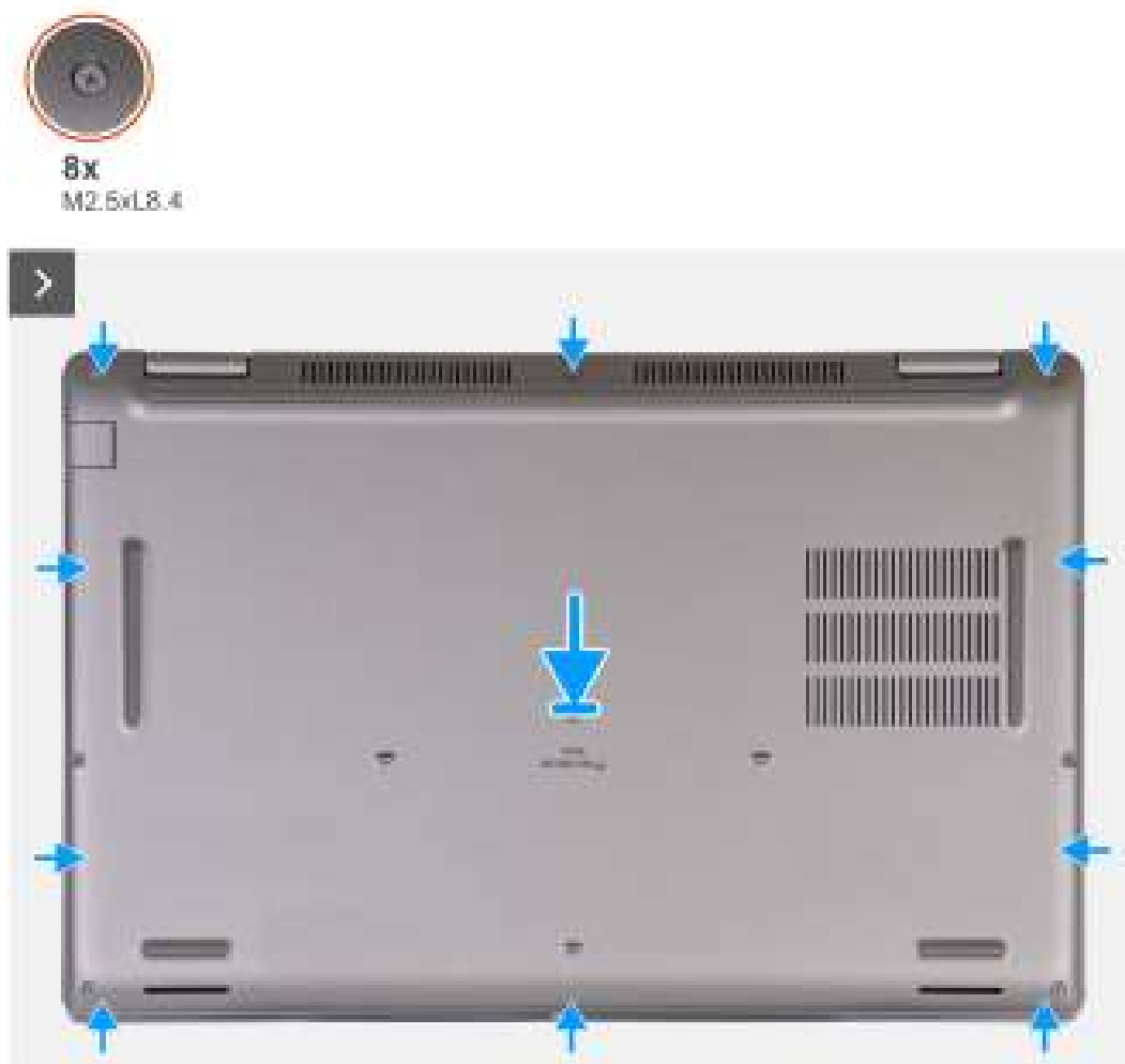
Figure 17. Installation du cache de fond
