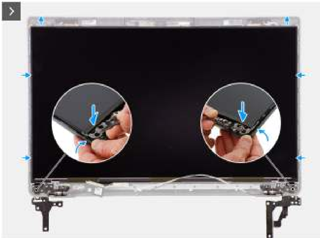
Figure 64. Installation du panneau d'écran
