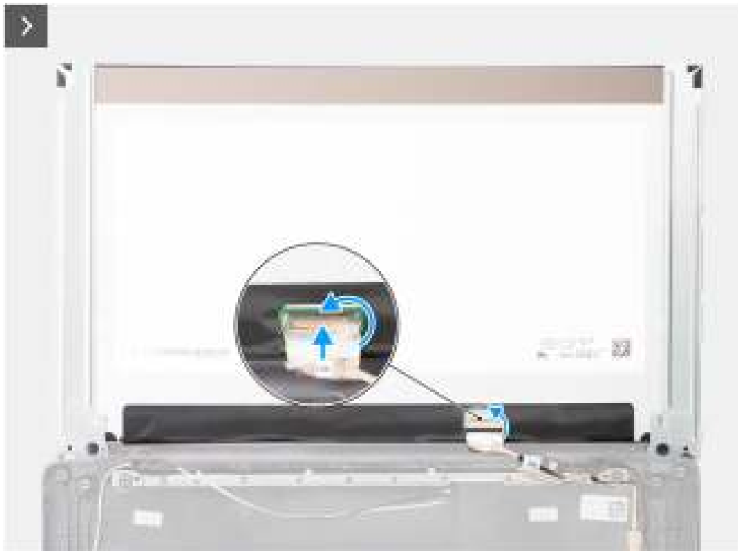
Figure 62. Installation du panneau d'écran
