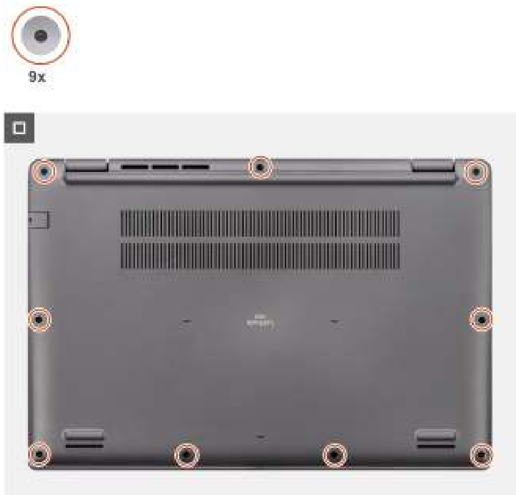
Figure 11. Installation du cache de fond
