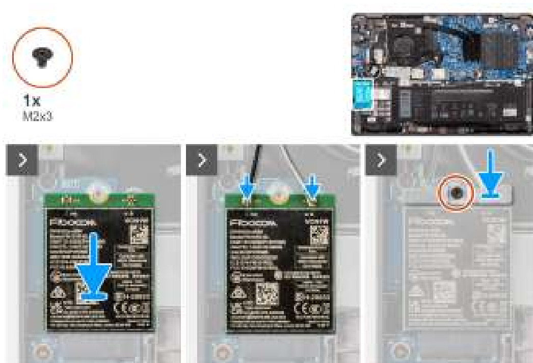
Figure 17. Installation de la carte WWAN
