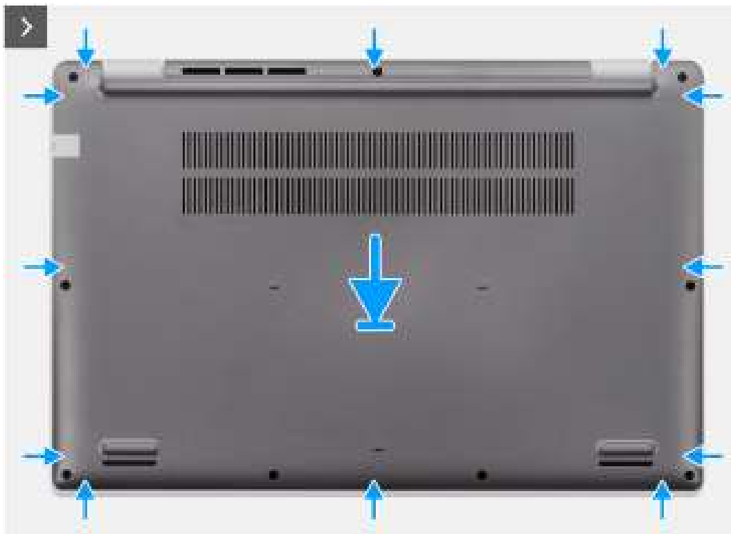
Figure 10. Installation du cache de fond
