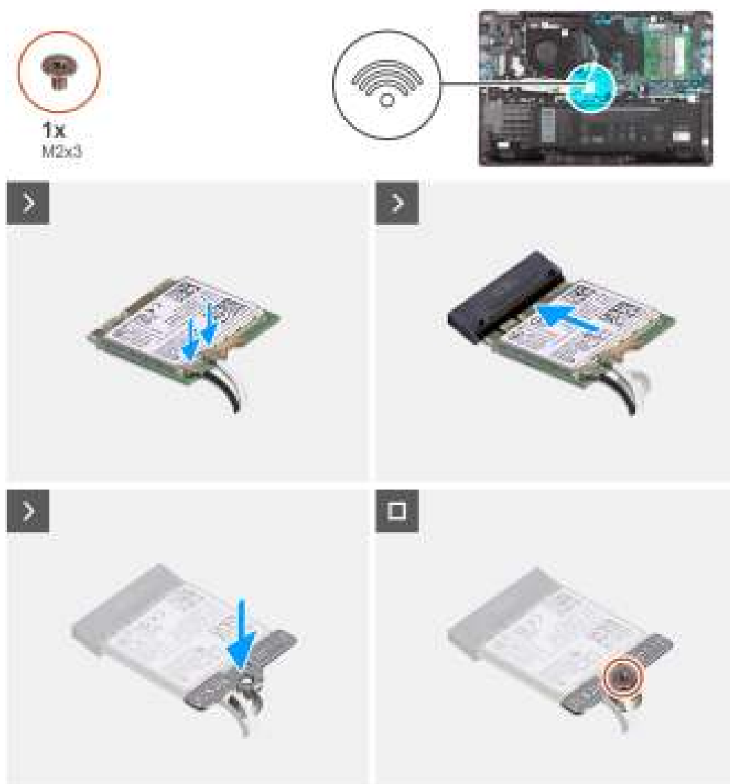
Figure 15. Installation de la carte sans fil
