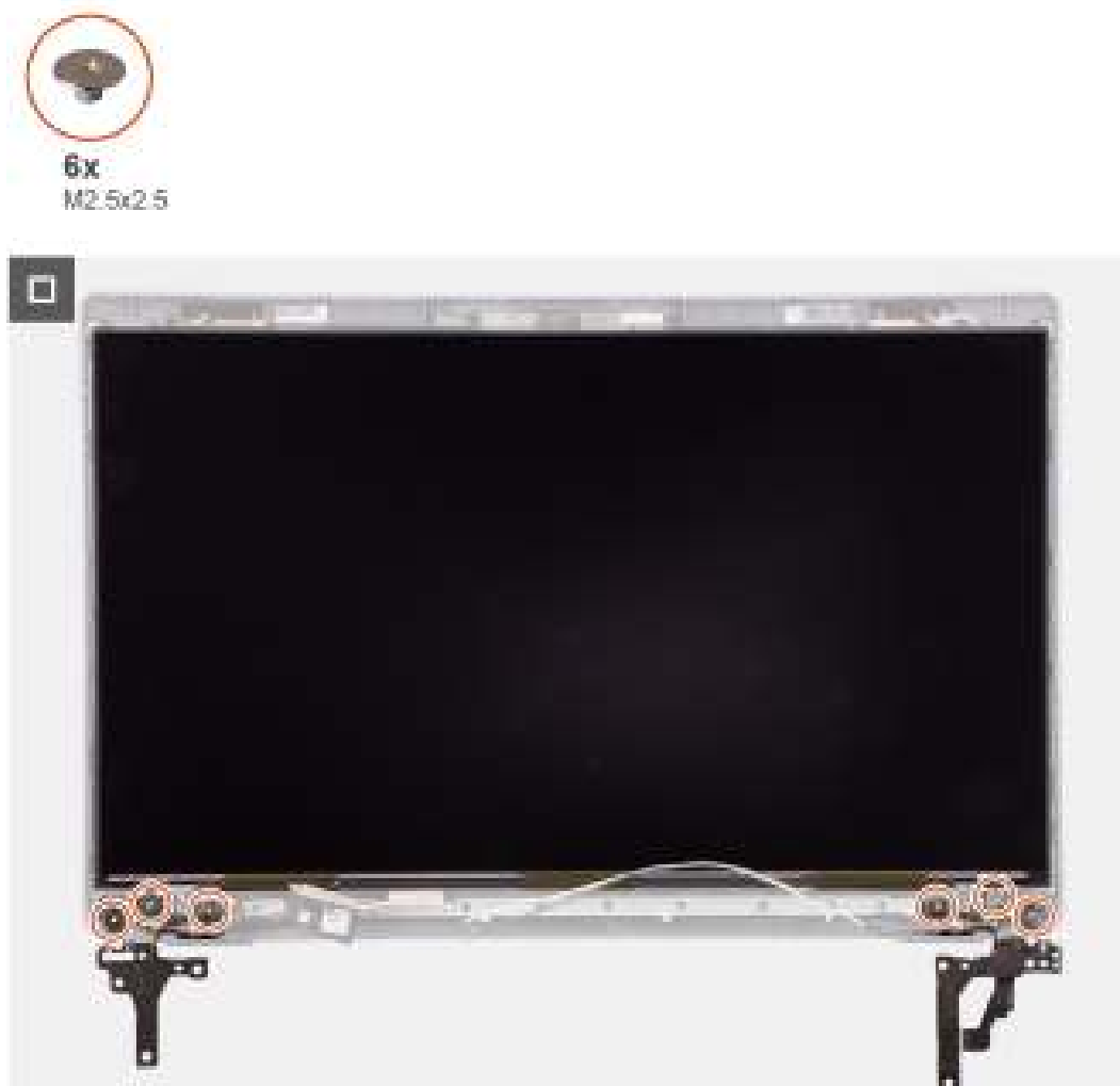
Figure 65. Installation du panneau d'écran
