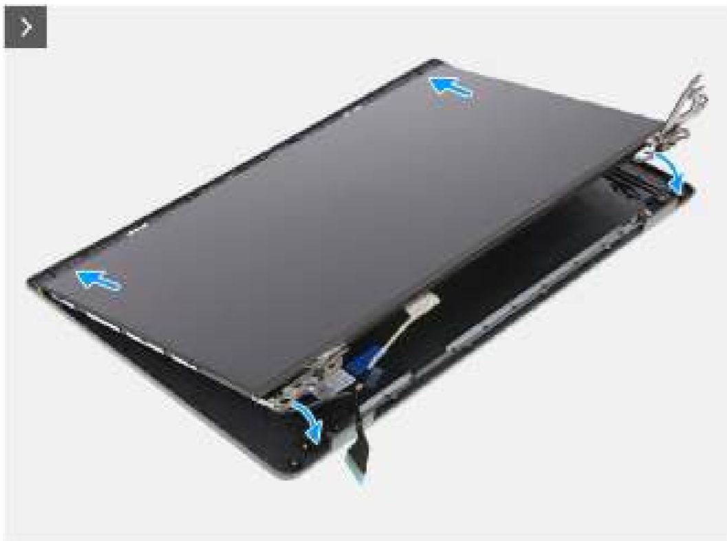
Figure 63. Installation du panneau d'écran
