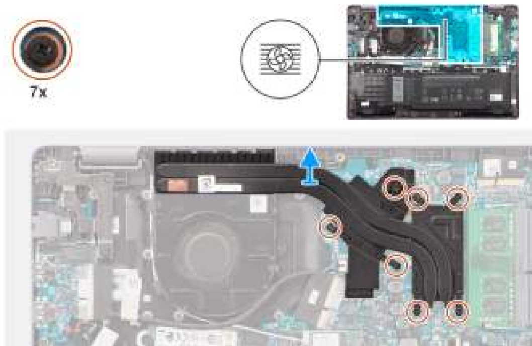
Figure 31. Retrait du dissipateur de chaleur pour carte graphique séparée
