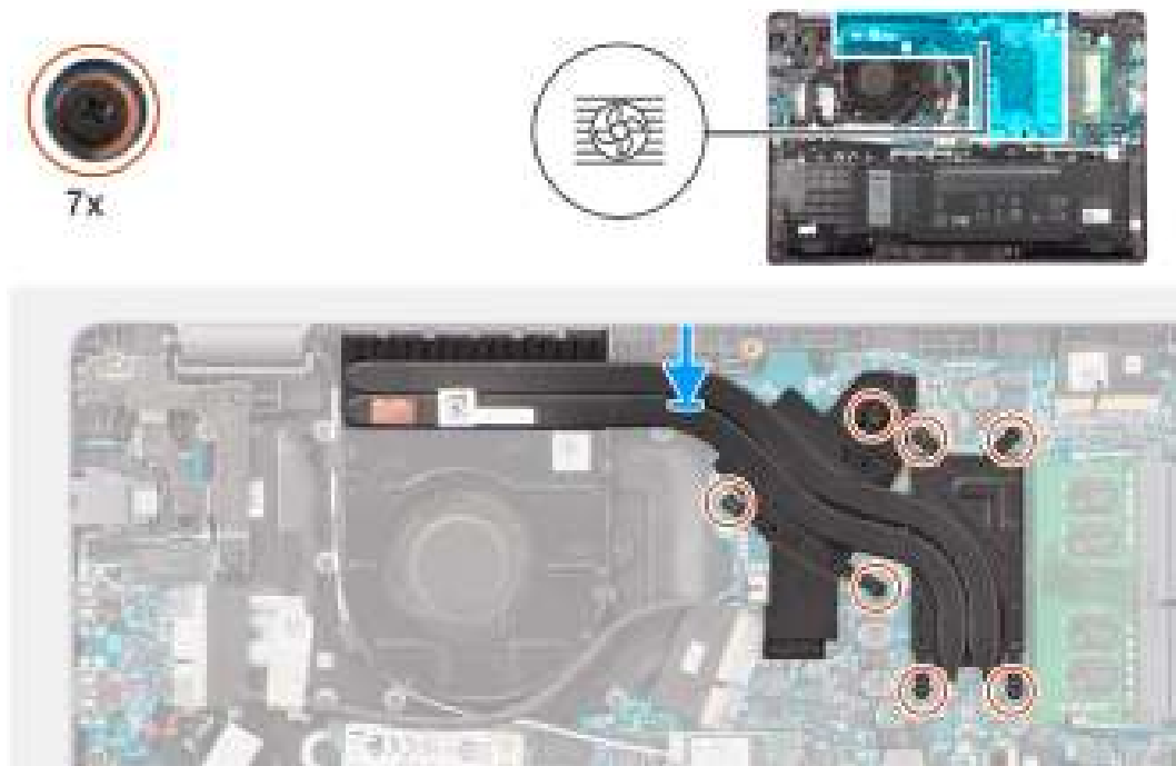
Figure 32. Installation du dissipateur de chaleur pour carte graphique séparée
