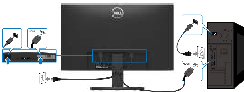
Figure 18. Connexion du câble HDMI
