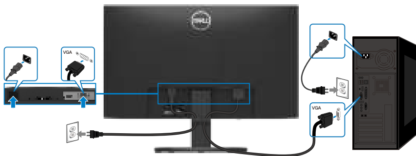
Figure 17. Connexion du câble VGA
