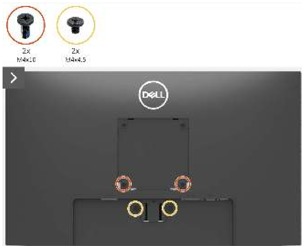
Schéma 12. Retrait du couvercle arrière
