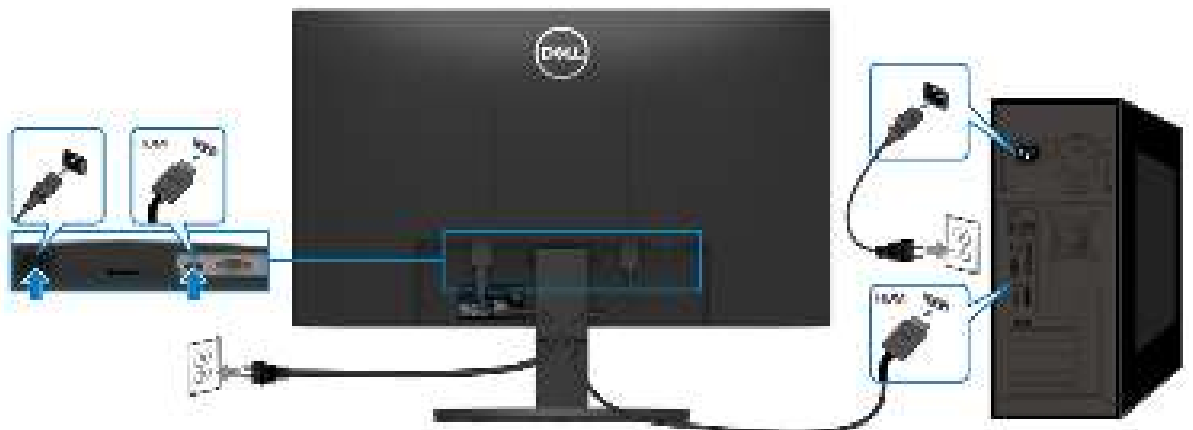
Schéma 7. Branchement du câble HDMI
