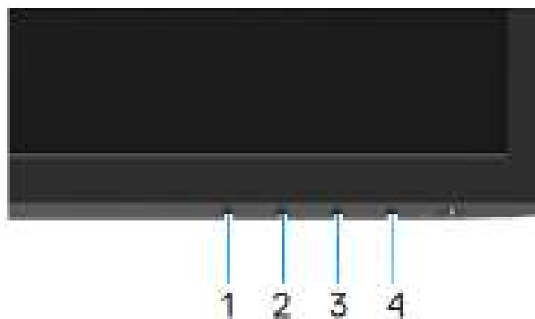
Schéma 29. Boutons de fonction de diagnostic intégrés
