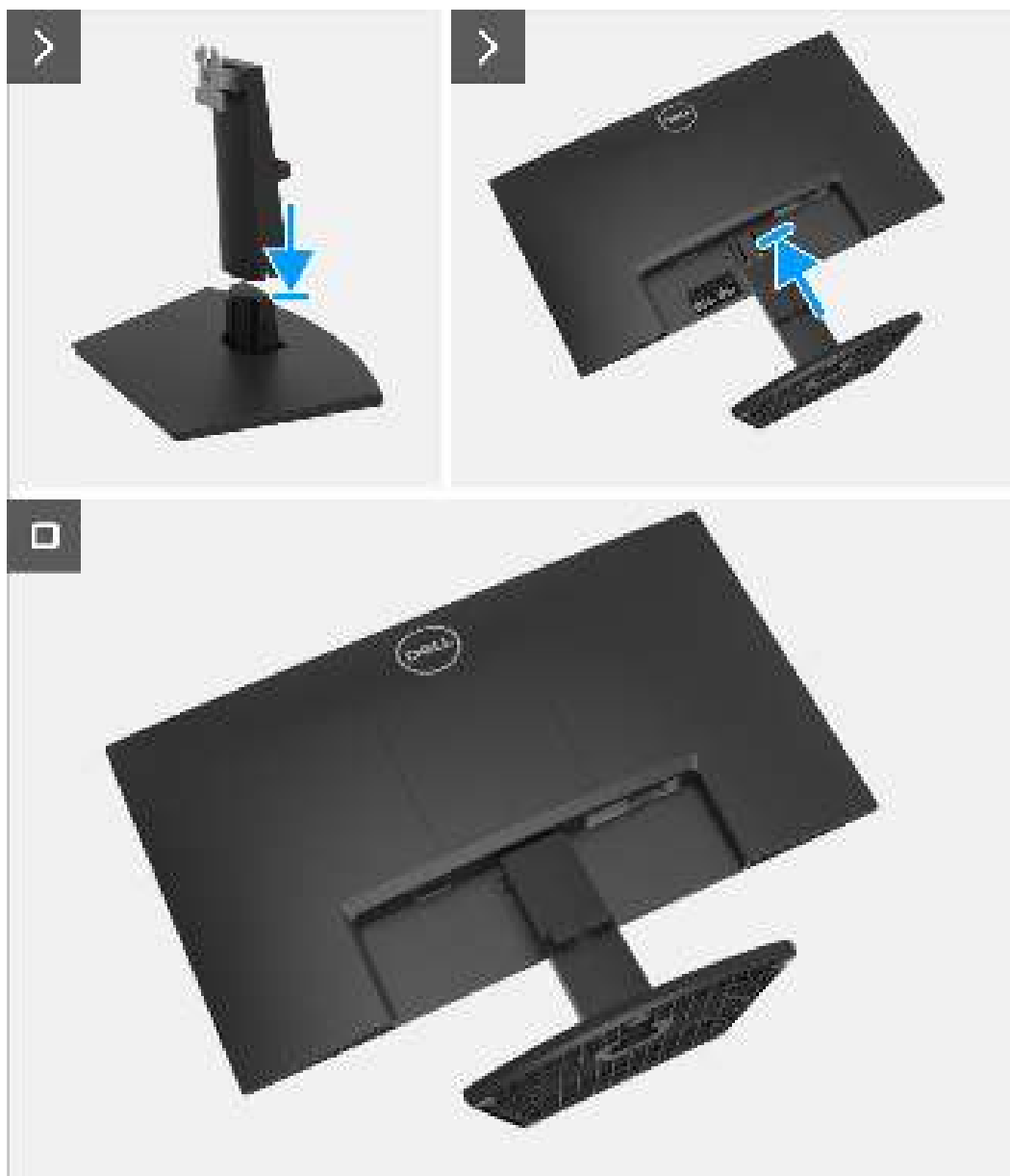
Schéma 9. Installation du support
