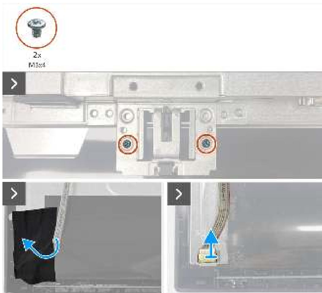
Schéma 17. Retrait de l'ensemble de châssis
