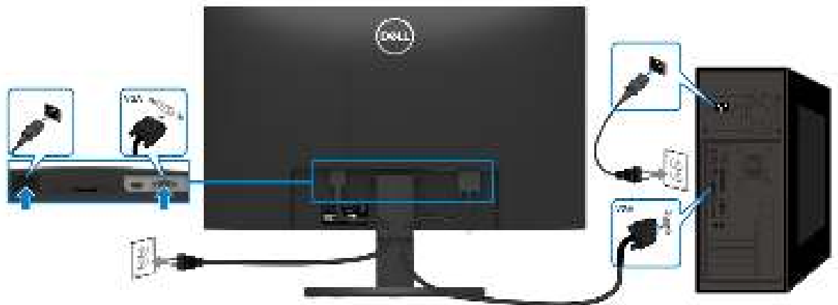
Schéma 6. Connexion du câble VGA
