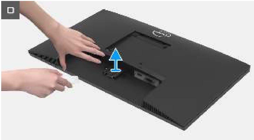
Schéma 13. Retrait du couvercle arrière
