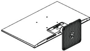
2. Appuyez sur le bouton de détachement pour détacher la colonne de base.
