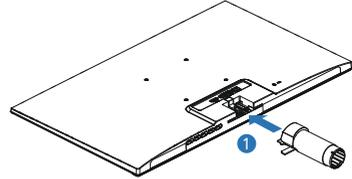
2. Tenez le support du socle du moniteur avec deux mains et insérez fermement le support du socle dans la colonne du socle.
