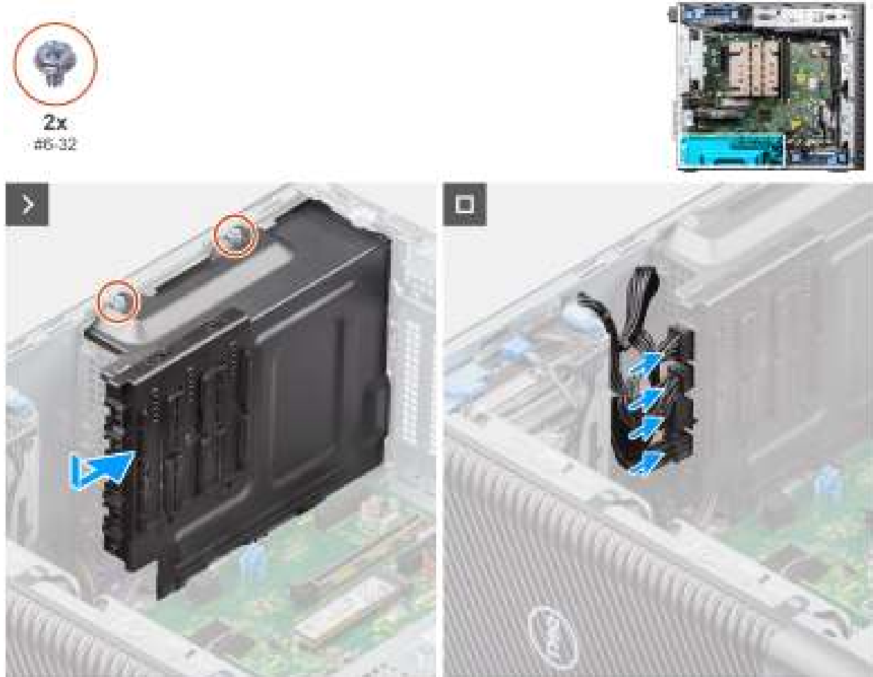
Afbeelding 47. Plaats de kap van de voedingseenheid.
