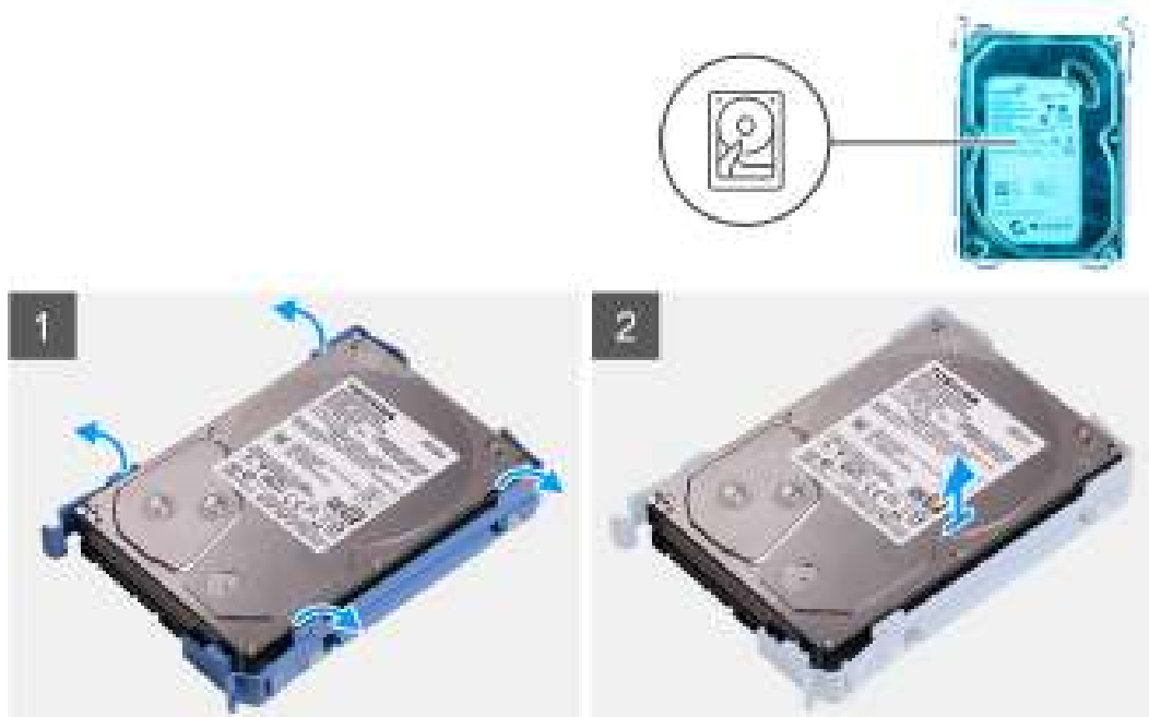
Afbeelding 18. De beugel van de 3,5-inch harde schijf verwijderen
