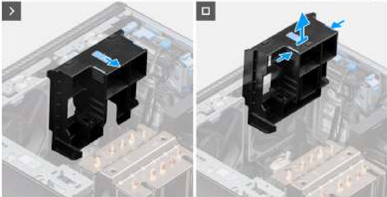
Afbeelding 34. De GPU-eindhouders verwijderen
