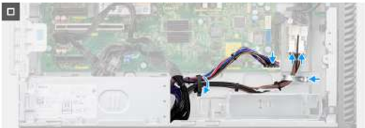
Afbeelding 50. De voedingseenheid van 1000 W plaatsen
