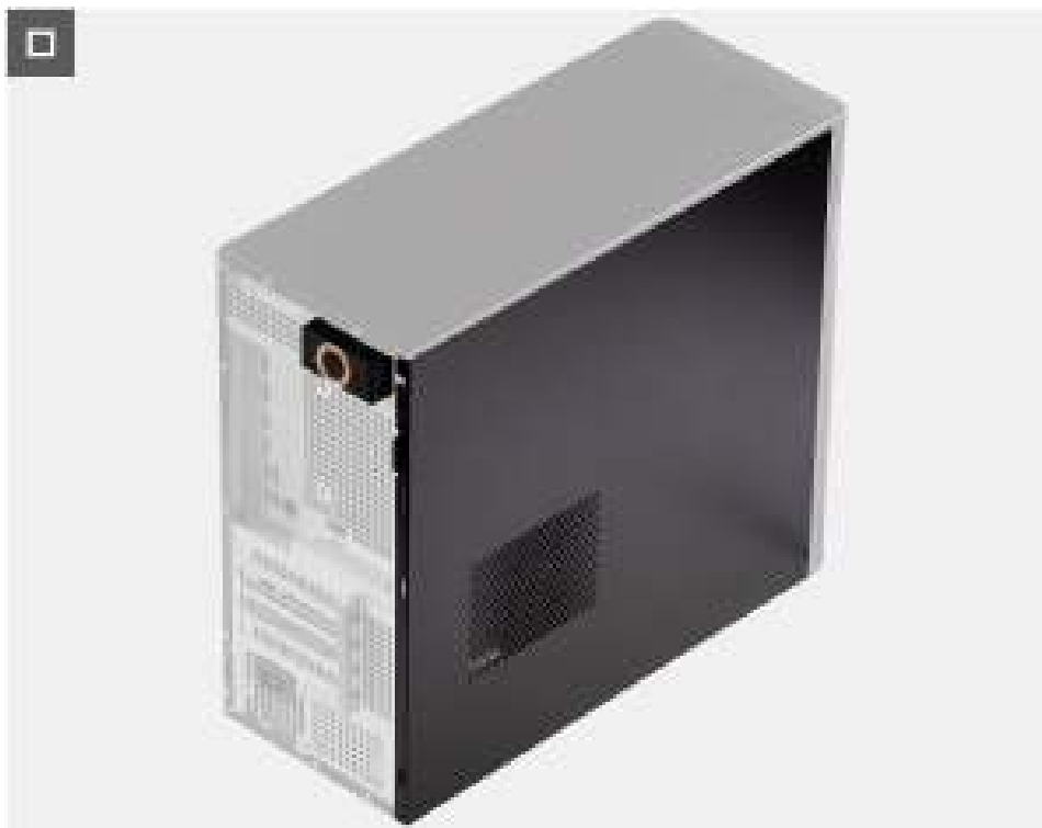
Afbeelding 11. De zijplaat plaatsen
