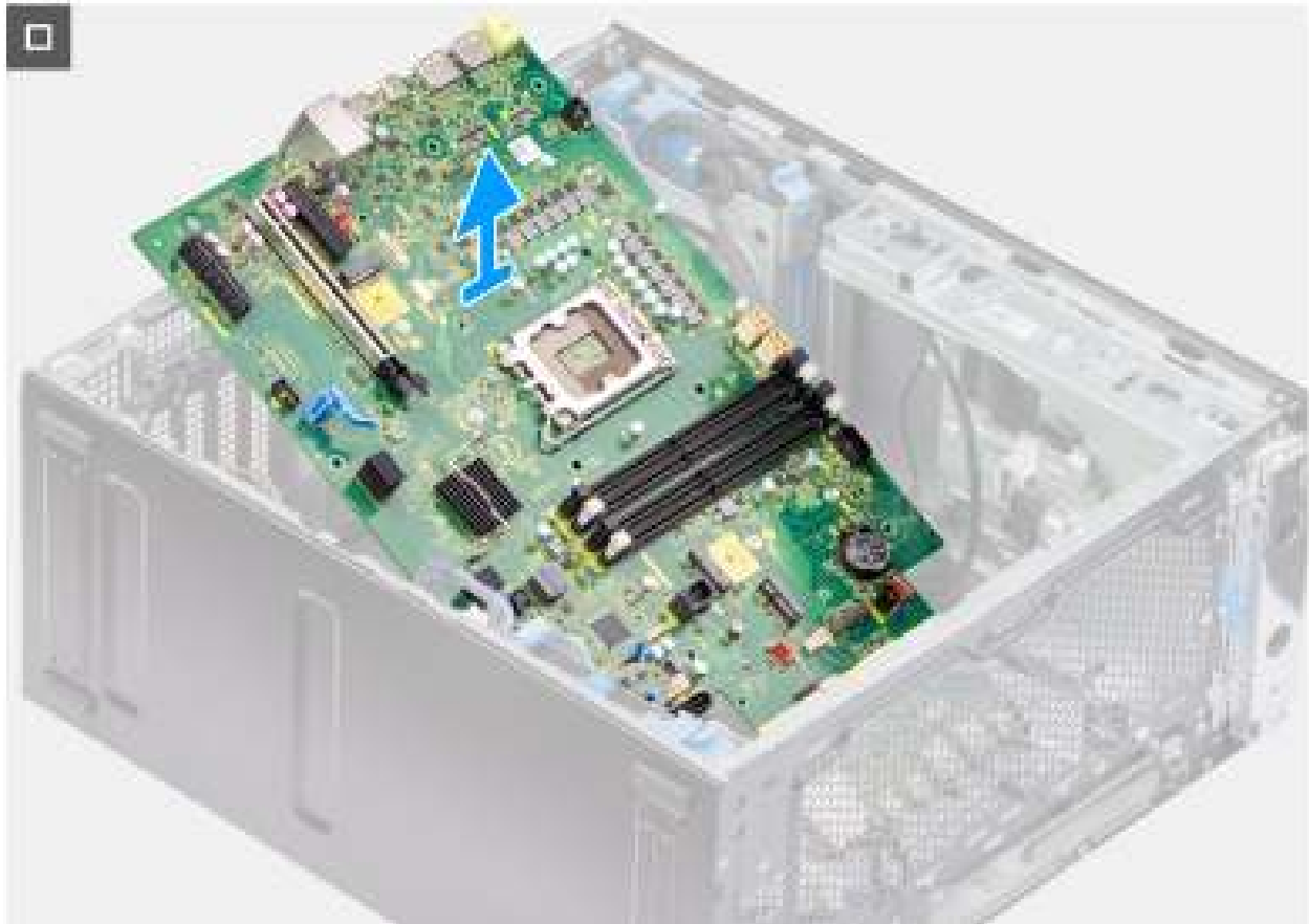
Afbeelding 78. De systeemkaart verwijderen
