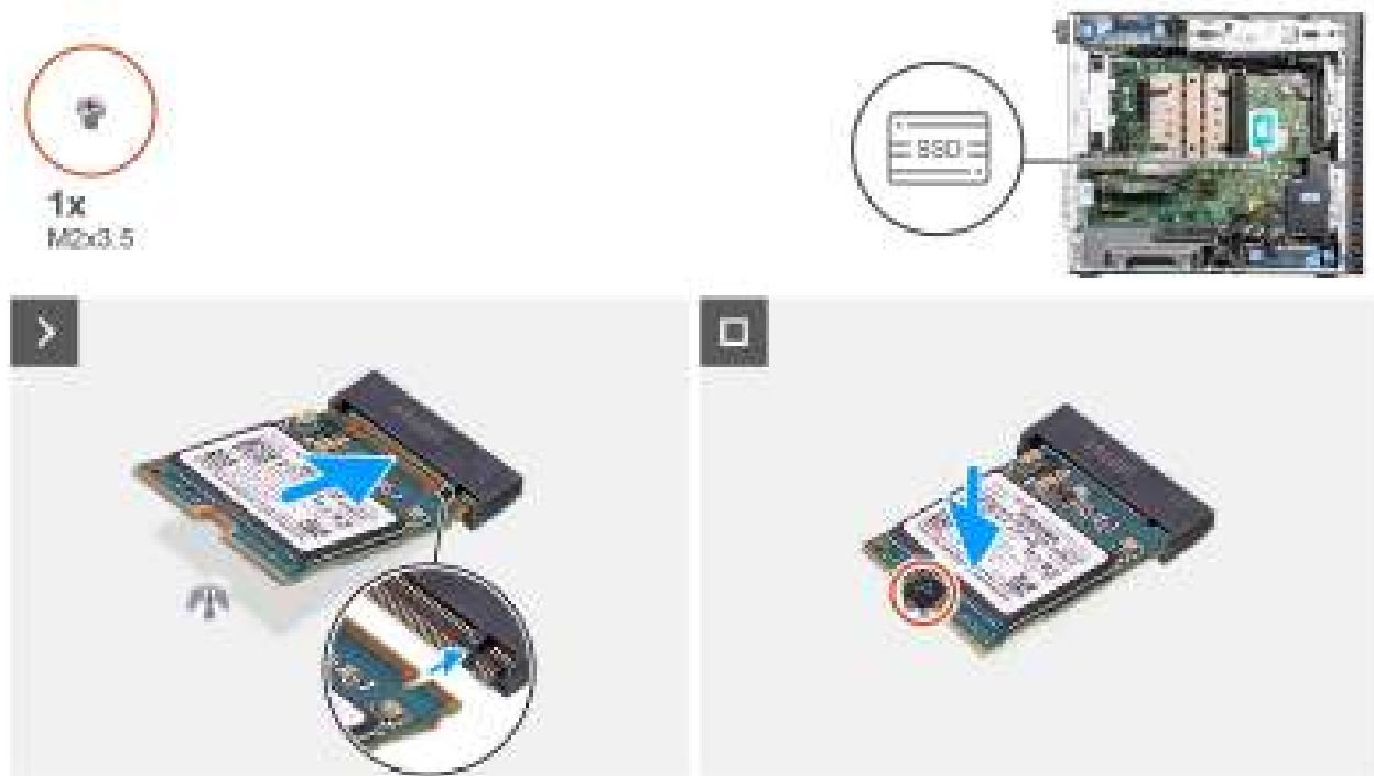
Afbeelding 23. De M.2 2230 PCIe SSD plaatsen
