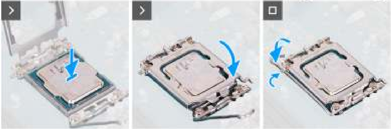
Afbeelding 57. De processor plaatsen
