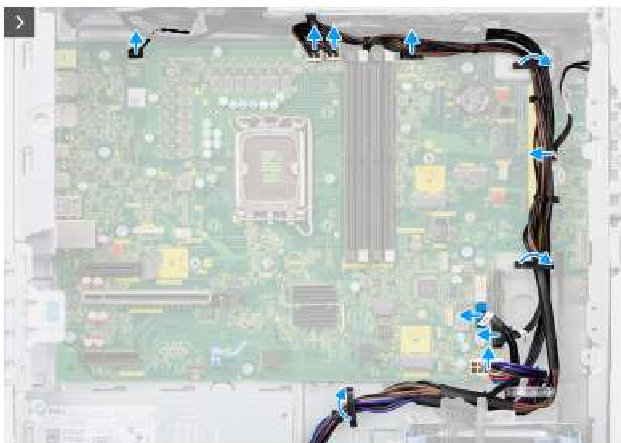
Afbeelding 76. De systeemkaart verwijderen
