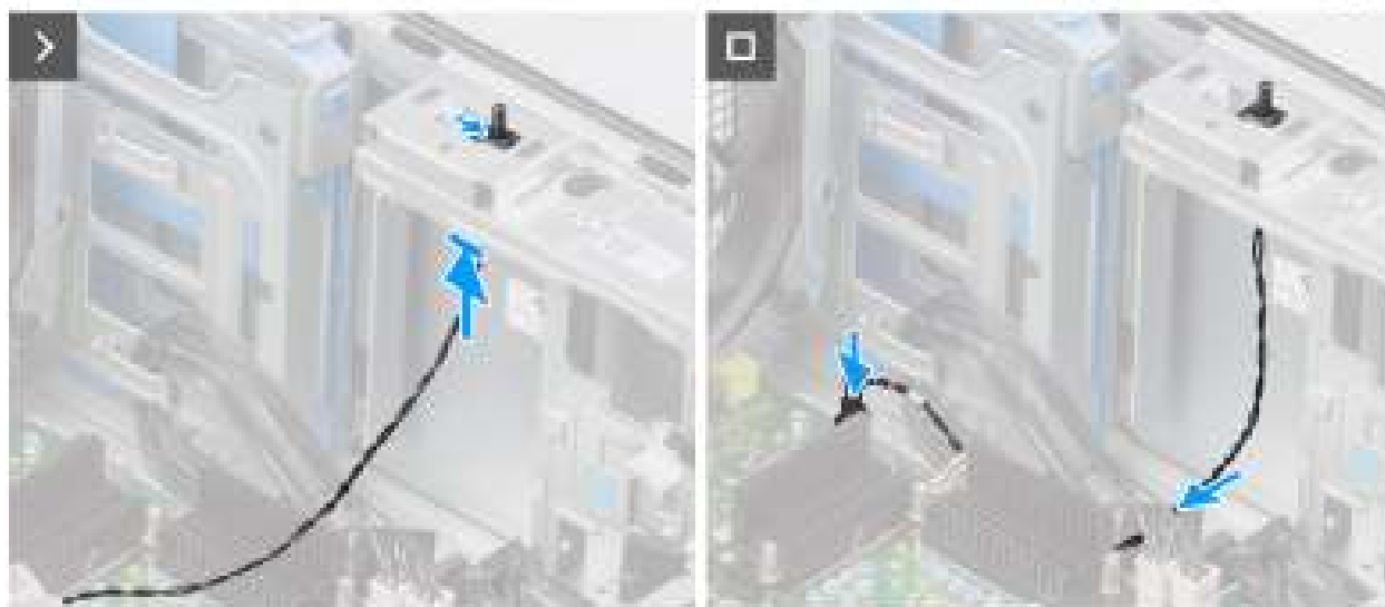
Afbeelding 71. De intrusieschakelaar plaatsen
