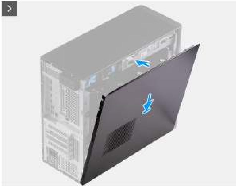
Afbeelding 10. De zijplaat plaatsen
