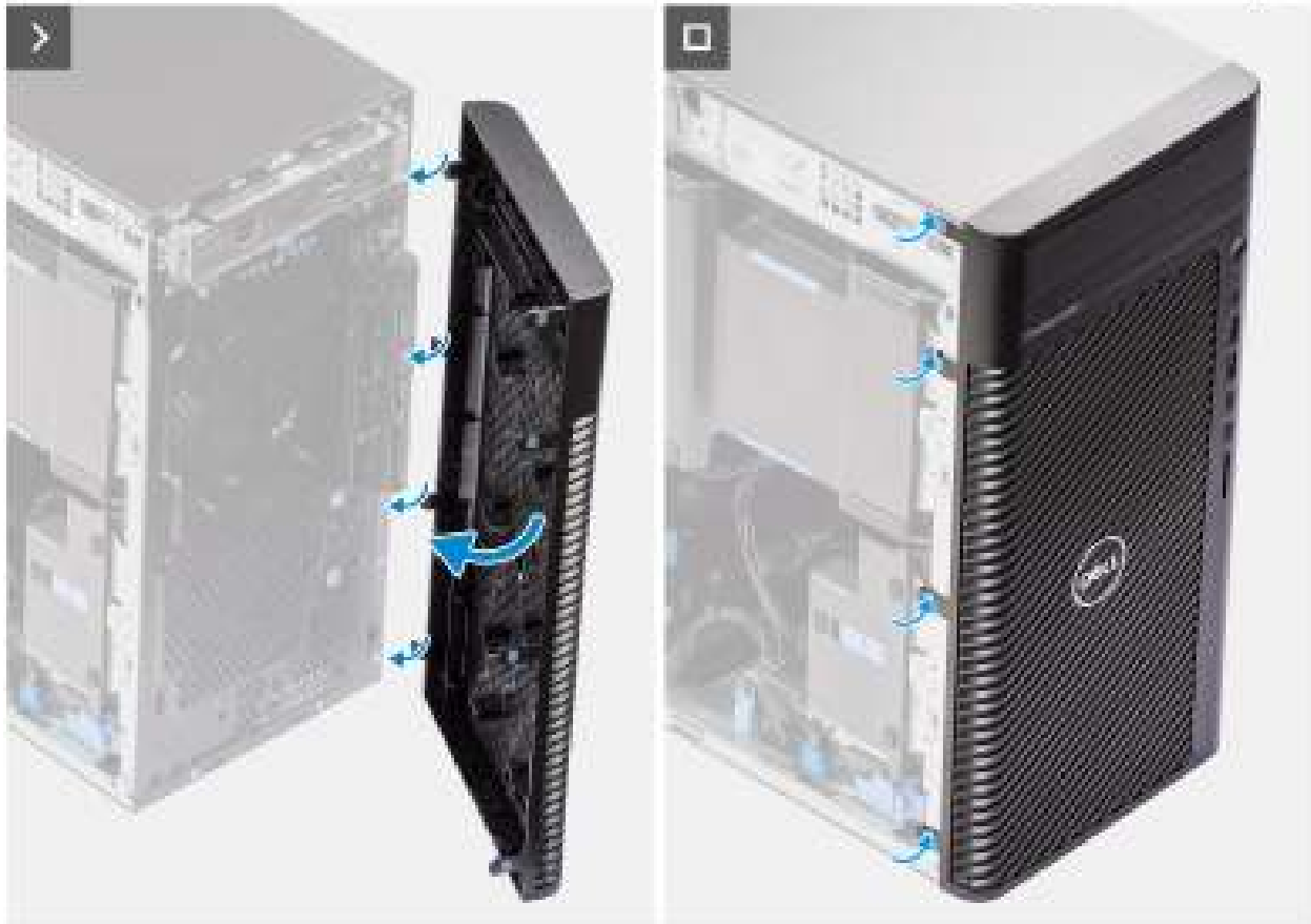
Afbeelding 13. Het montagekader aan de voorkant plaatsen
