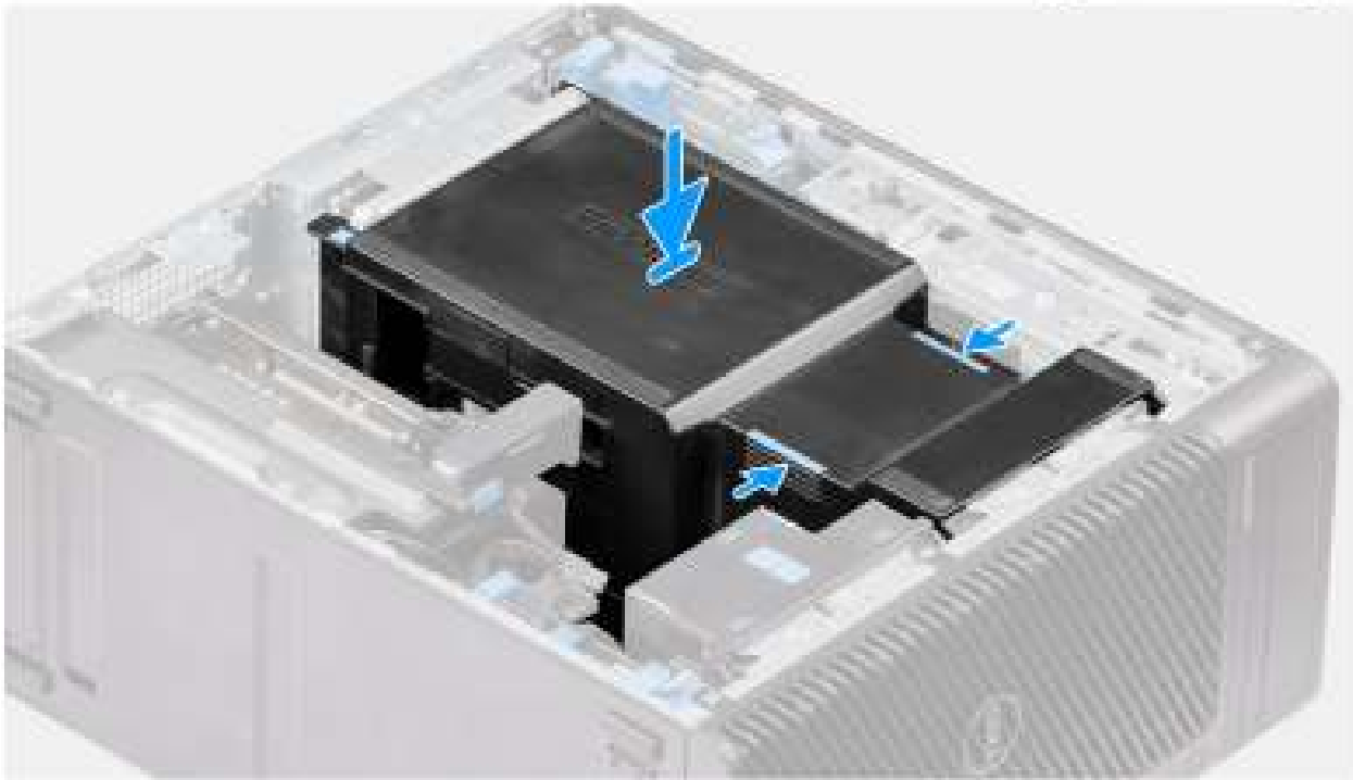
Afbeelding 15. De luchtkap plaatsen
