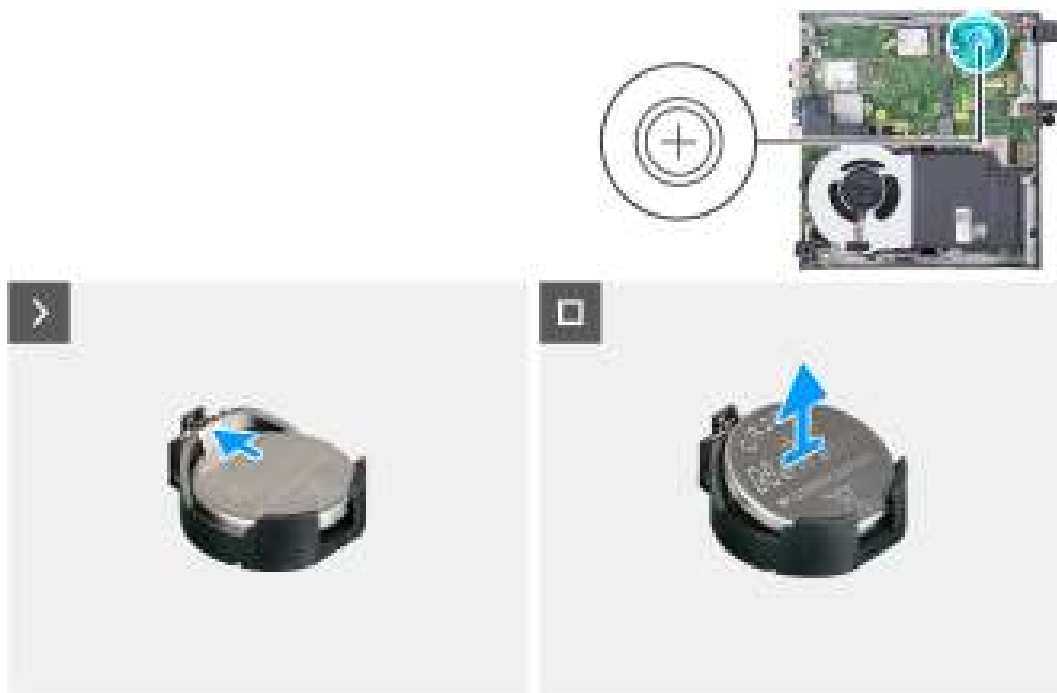
Afbeelding 13. De knoopcelbatterij verwijderen
