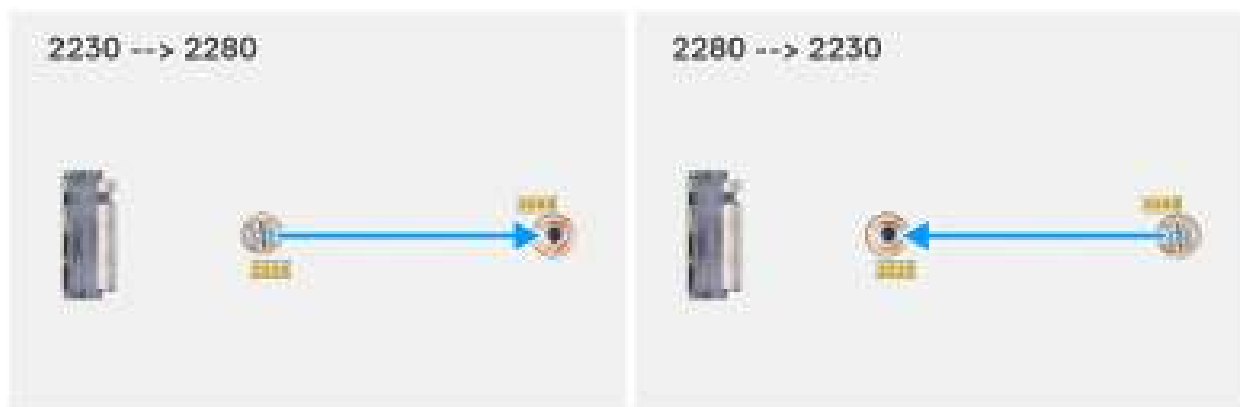
Afbeelding 27. De schroefbevestiging verplaatsen ter ondersteuning van een andere vormfactor (OptiPlex Micro Plus 7020)
