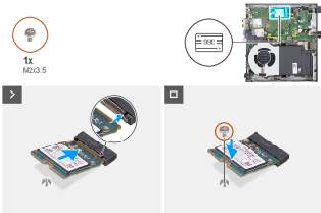
Afbeelding 22. De M.2 2230 SSD in slot 1 installeren
