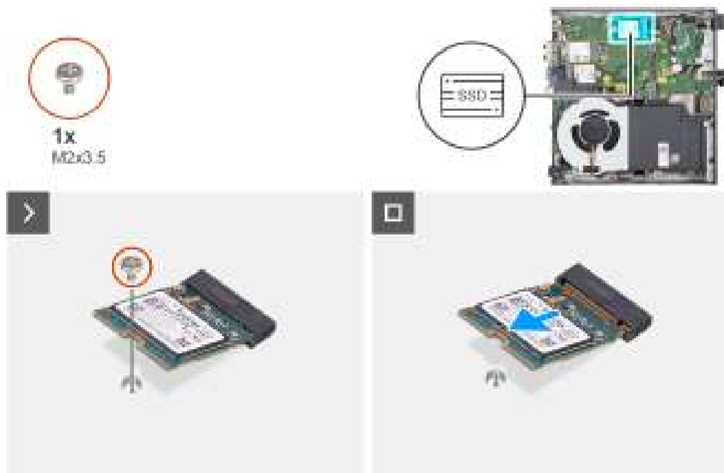
Afbeelding 21. De M.2 2230 SSD uit slot 1 verwijderen
