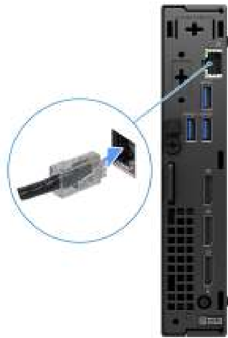
Afbeelding 4. Maak met een kabel verbinding met uw netwerk
