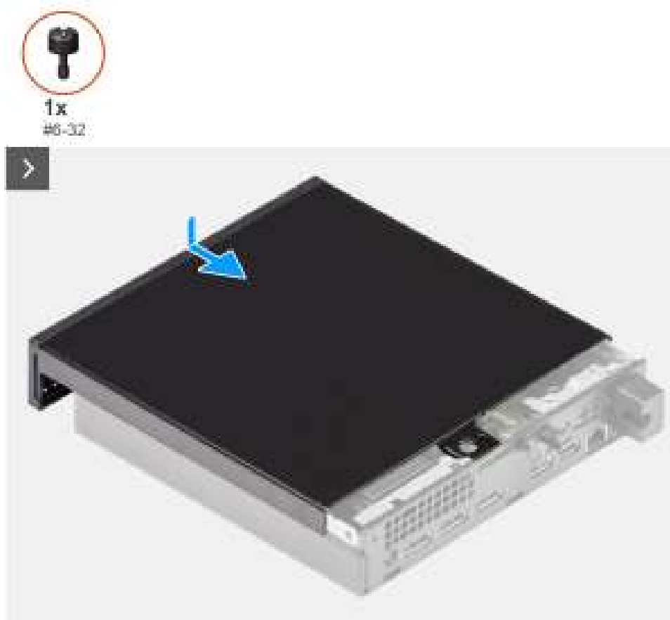
Afbeelding 11. De zijplaat plaatsen
