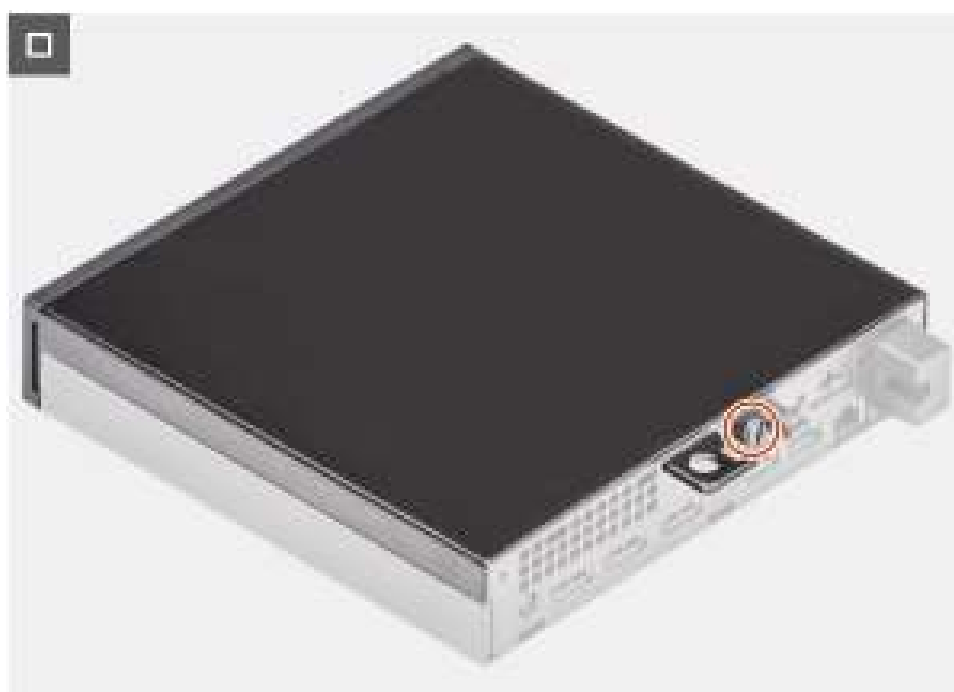
Afbeelding 12. De zijplaat plaatsen
