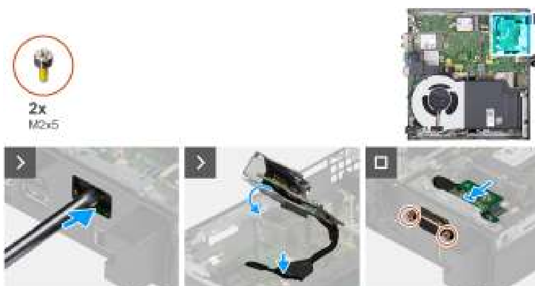
Afbeelding 37. Optionele I/O-modules installeren (VGA of serieel)
