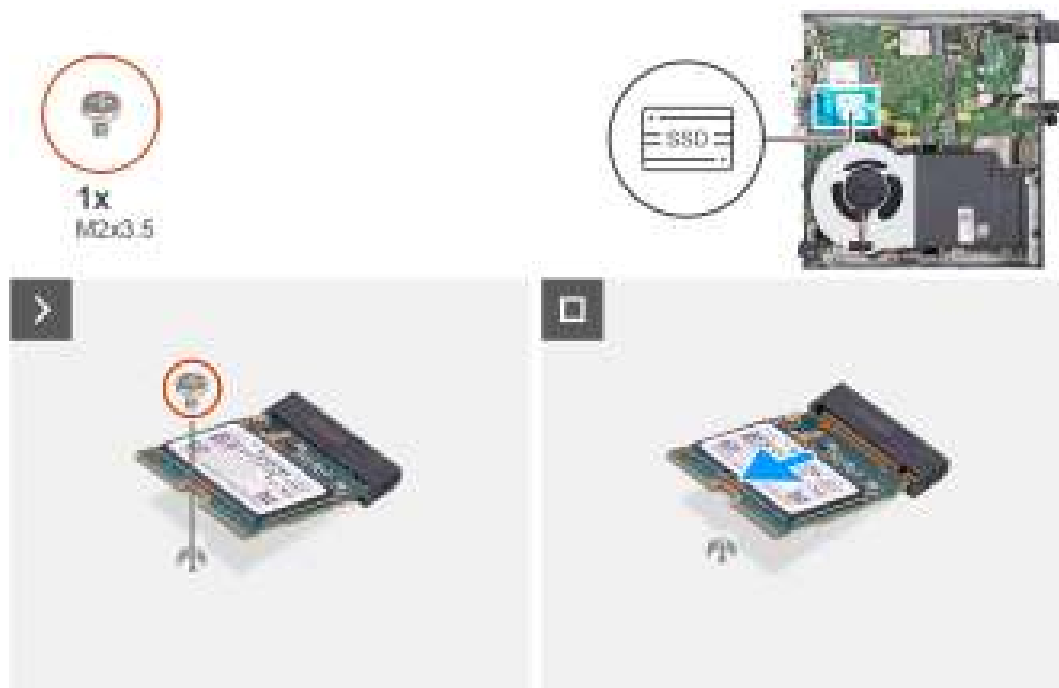
Afbeelding 19. De 2230 SSD uit slot 0 verwijderen
