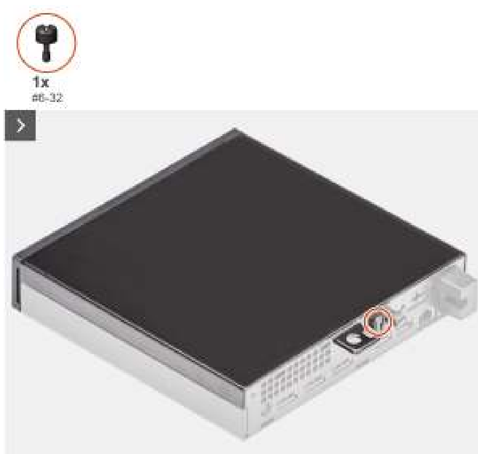
Afbeelding 9. De zijplaat verwijderen
