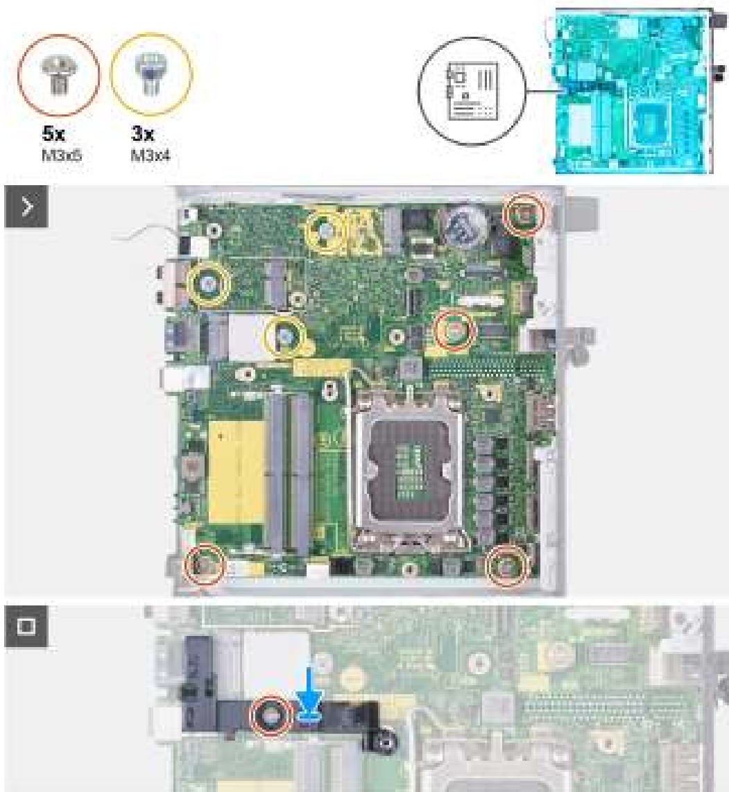
Afbeelding 49. De systeemkaart installeren
