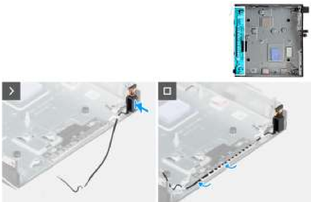
Afbeelding 53. De antennemodule (zwarte kabel) plaatsen
