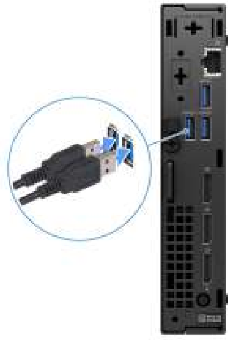
Afbeelding 3. Het toetsenbord en de muis aansluiten op uw OptiPlex Micro Plus 7020
