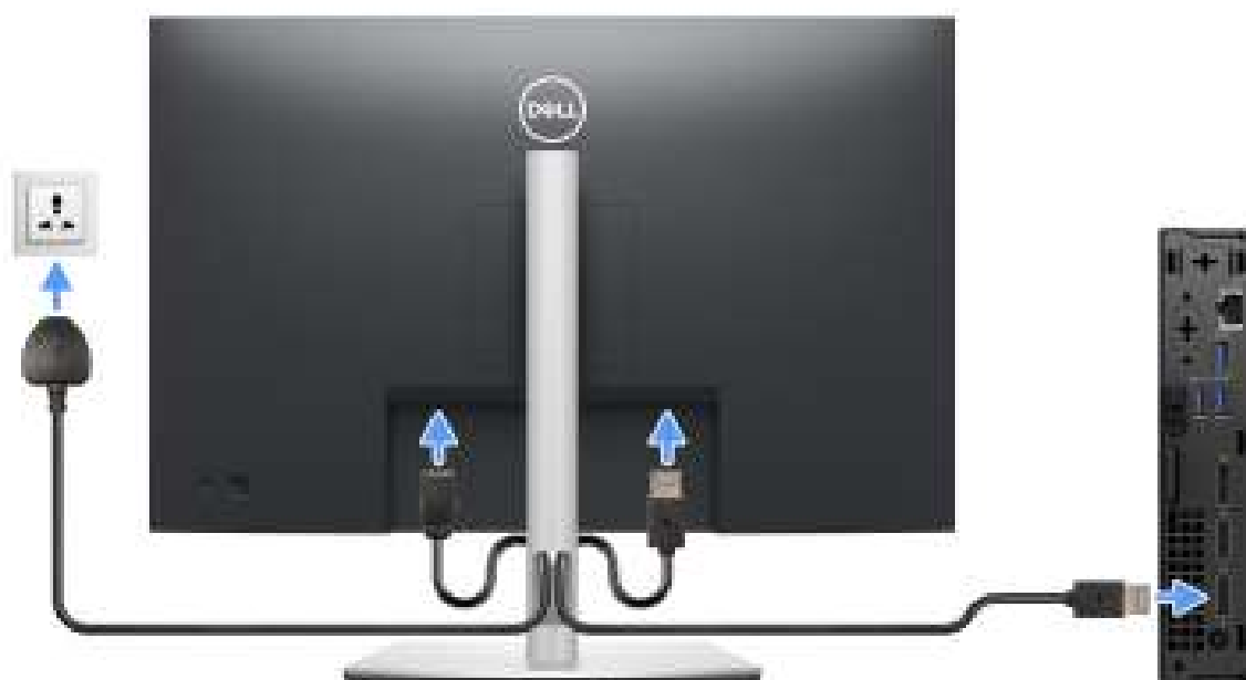
Afbeelding 5. Het beeldscherm aansluiten
