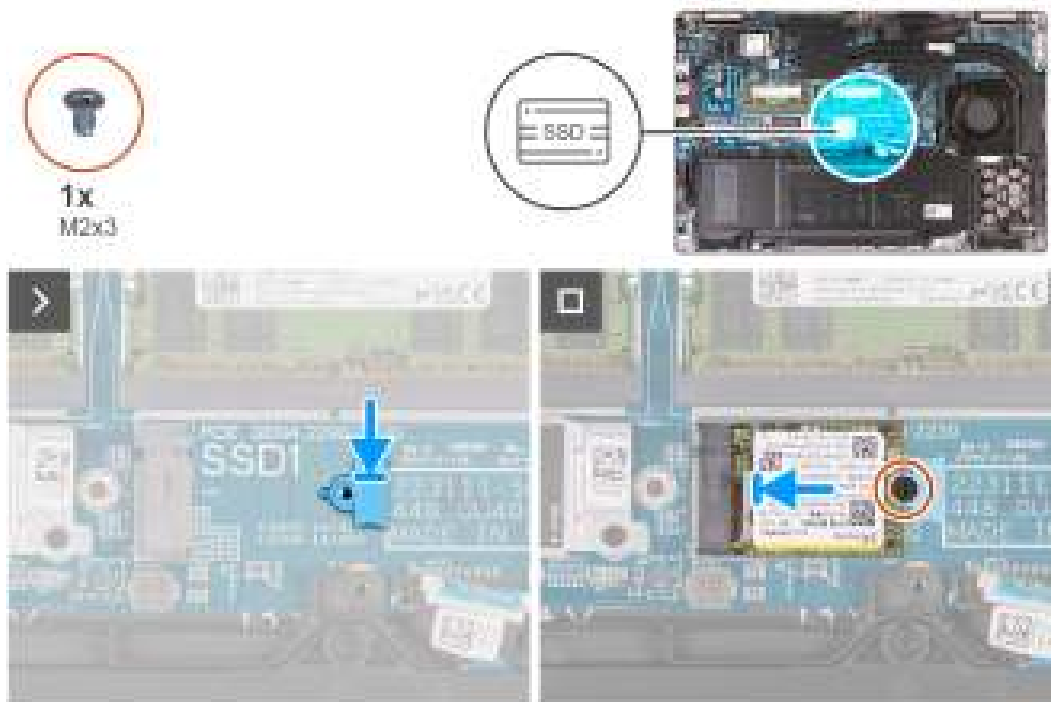
Afbeelding 28. De M.2 2230 SSD in slot 1 installeren
