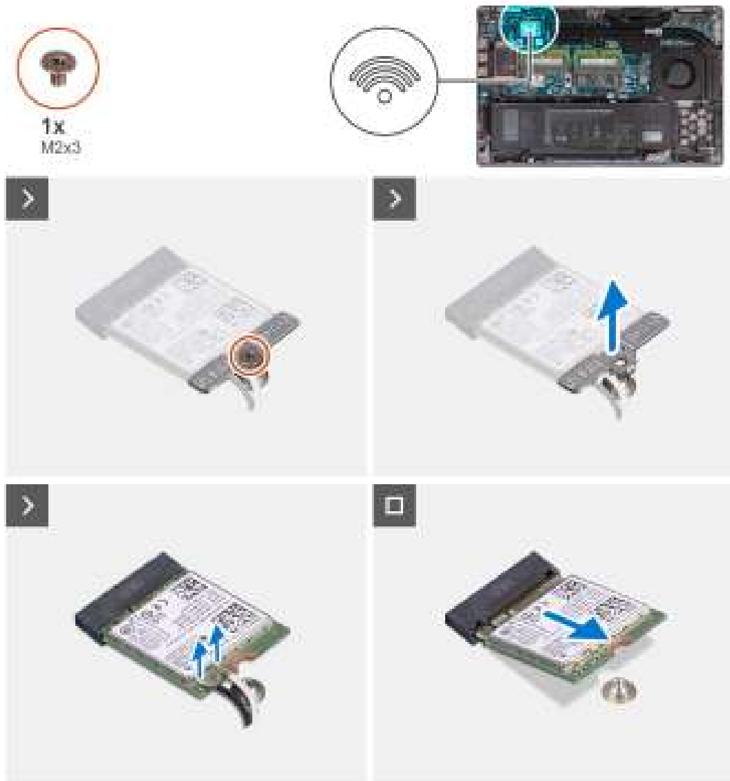
Afbeelding 19. De draadloze kaart verwijderen
