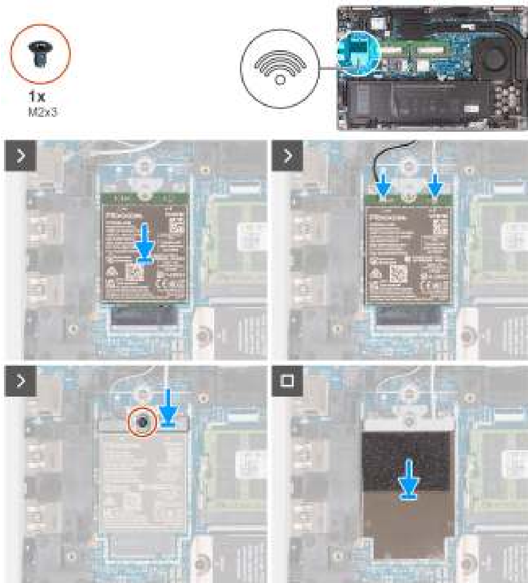
Afbeelding 22. De 4G WWAN-kaart installeren
