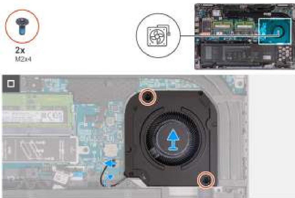
Afbeelding 33. De ventilator verwijderen
