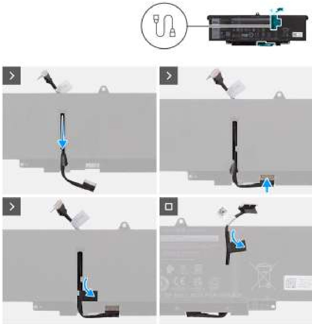
Afbeelding 35. De batterijkabel installeren
