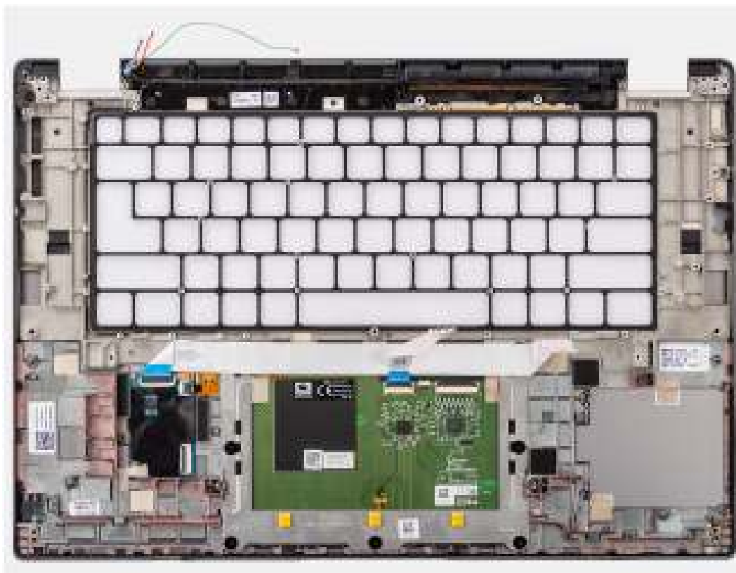
Afbeelding 70. De palmsteuneenheid installeren
