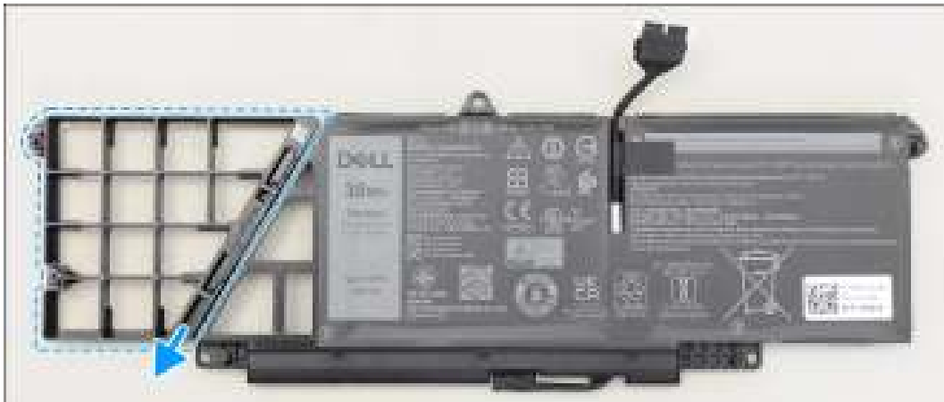
Afbeelding 30. De 2-cels batterij verwijderen
