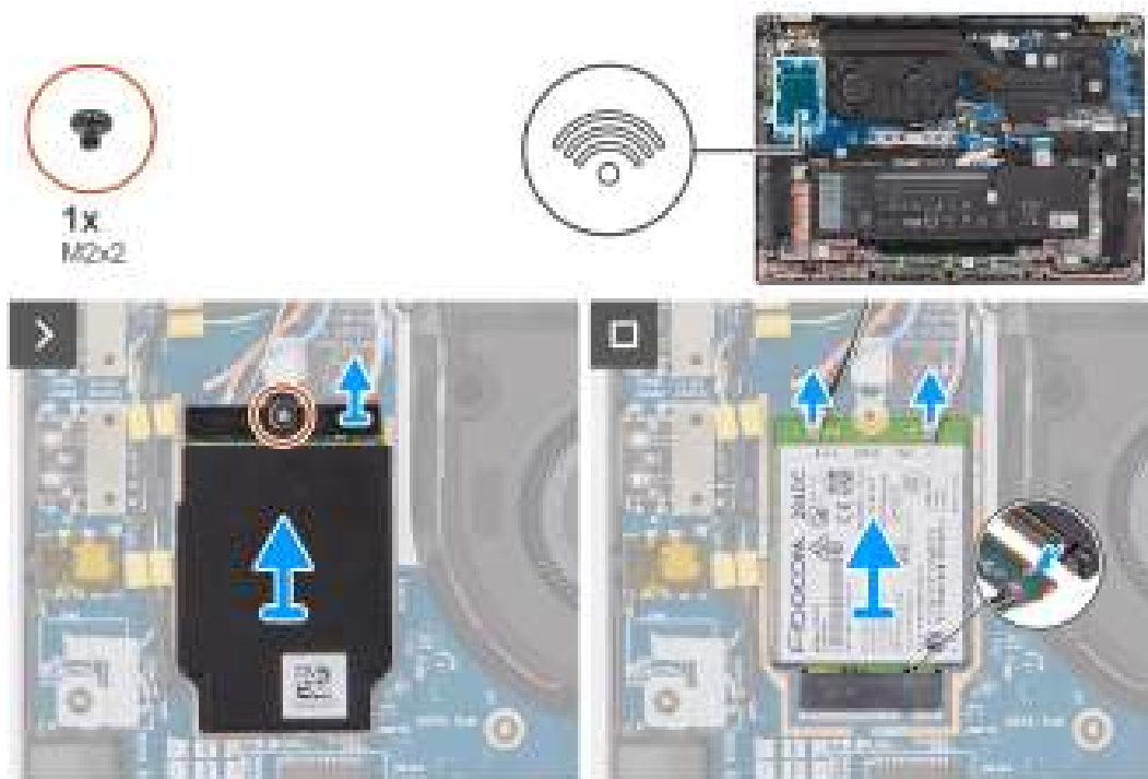
Afbeelding 20. De 4G WWAN-kaart verwijderen
