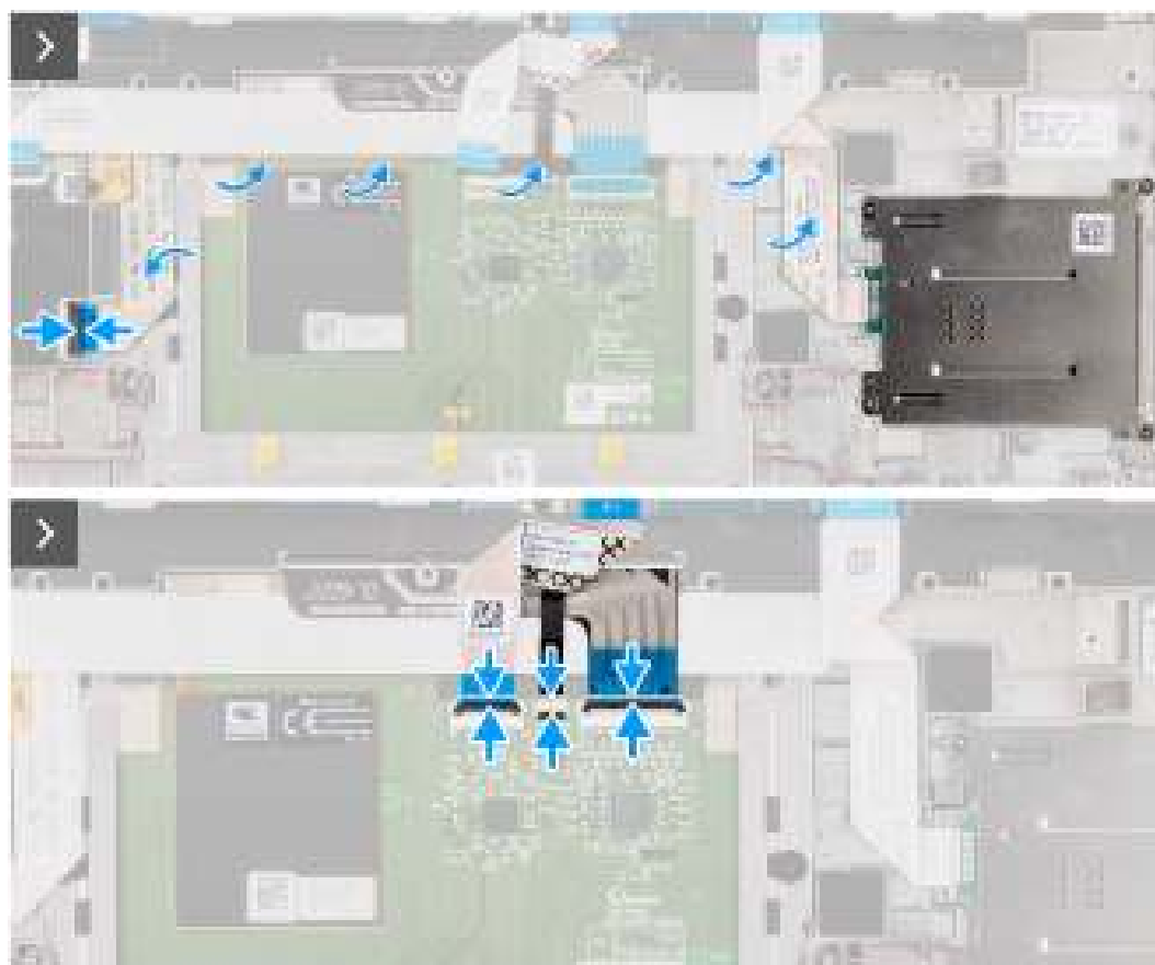
Afbeelding 48. De smartcardlezer installeren
