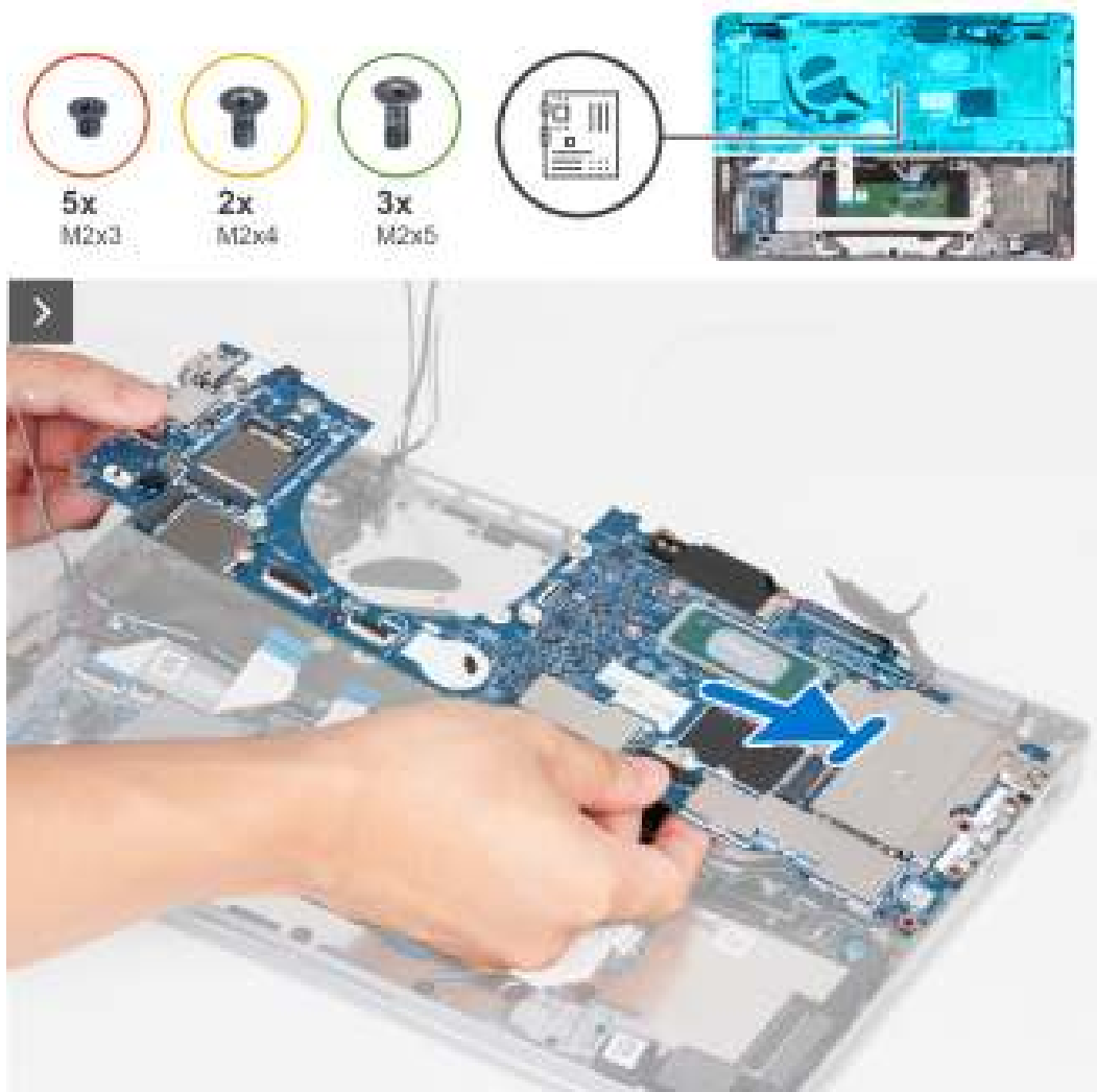
Afbeelding 49. De systeemkaart installeren
