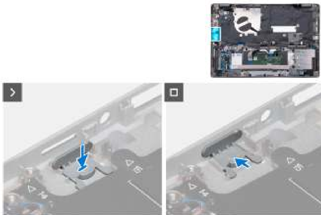
Afbeelding 91. De simkaartslotvulling installeren
