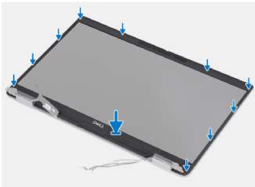
Afbeelding 69. De beeldschermbezel installeren (laptop)
