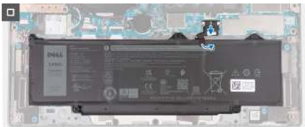
Afbeelding 19. De batterijkabel van de systeemkaart loskoppelen
