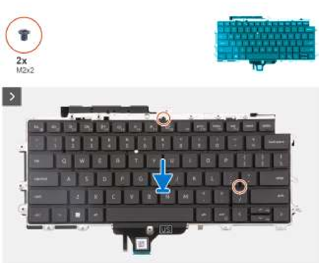
Afbeelding 61. De toetsenbordeenheid installeren
