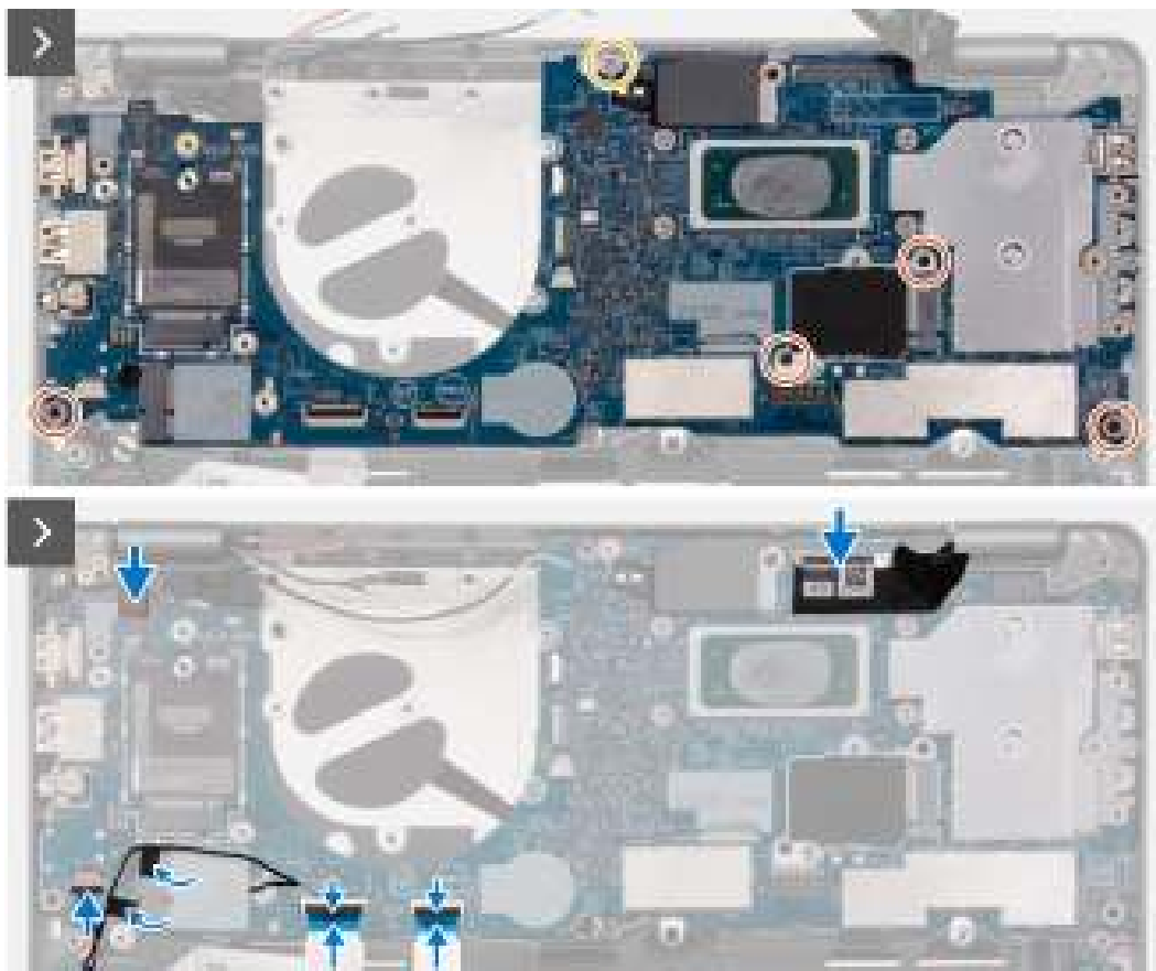
Afbeelding 50. De systeemkaart installeren
