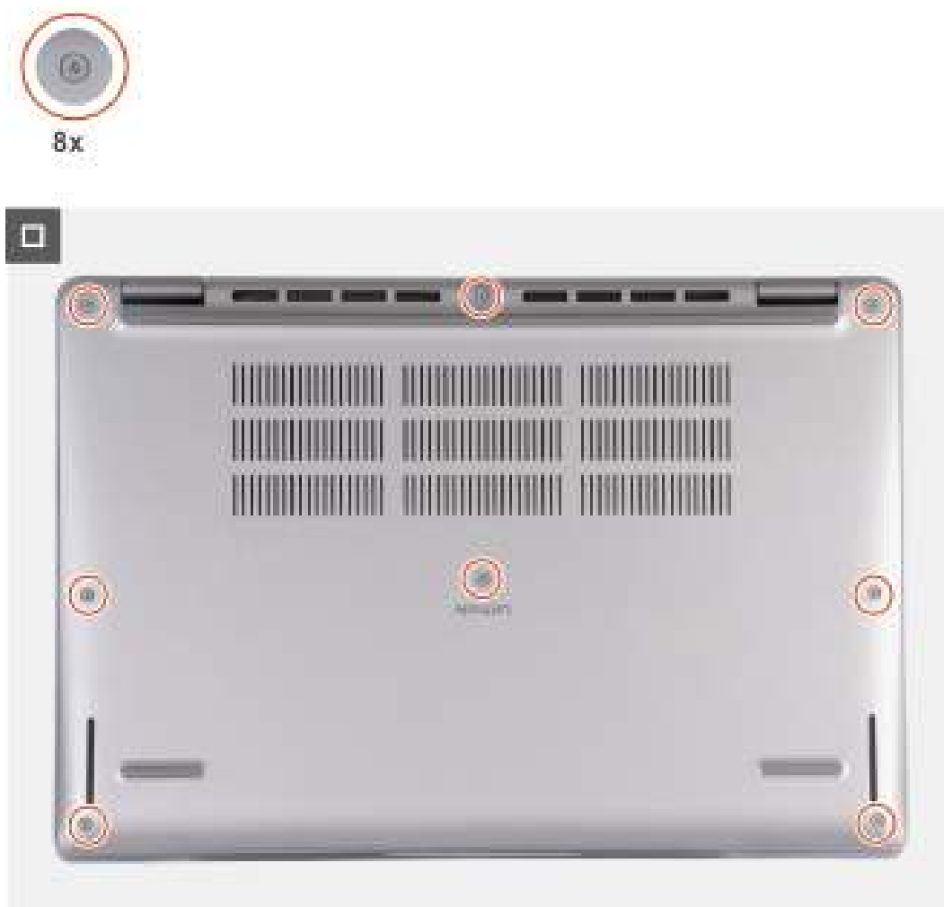
Afbeelding 22. Draai de acht geborgde schroeven vast om de onderplaat aan de palmsteuneenheid te bevestigen
