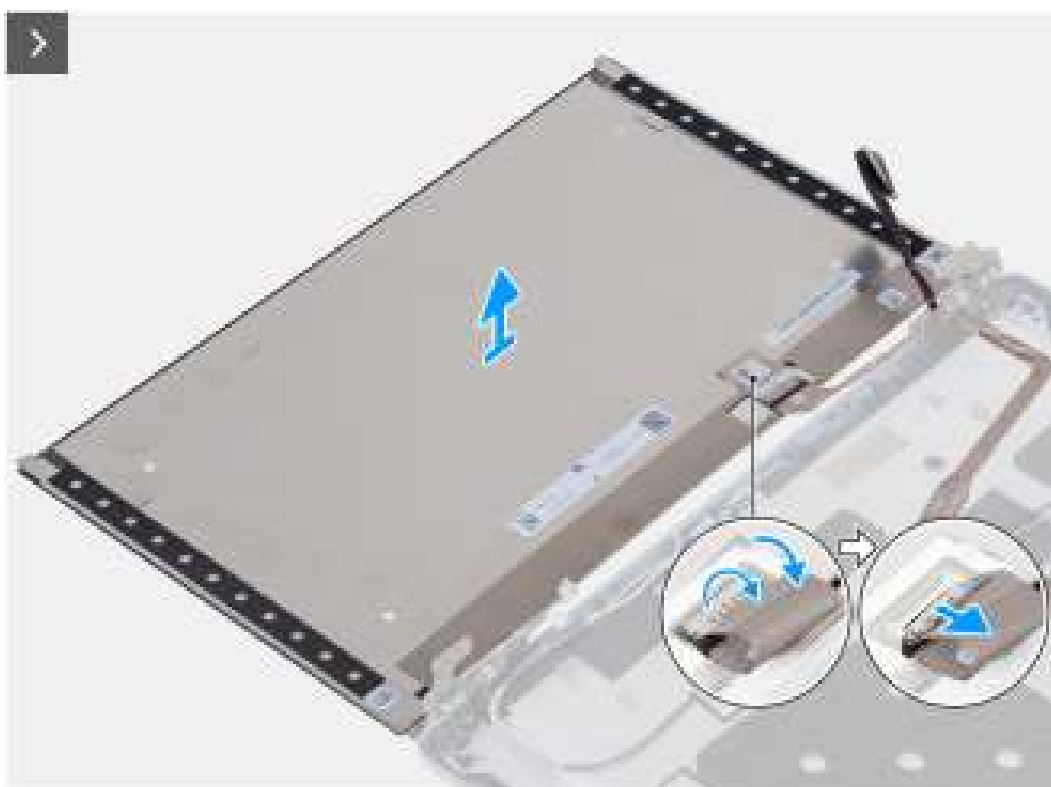
Afbeelding 78. Het beeldschermpaneel verwijderen
