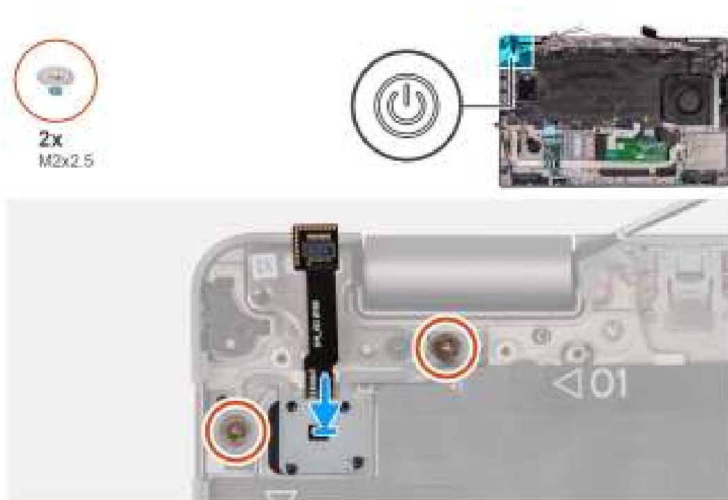
Afbeelding 64. De aan-uitknop met optionele vingerafdruklezer plaatsen
