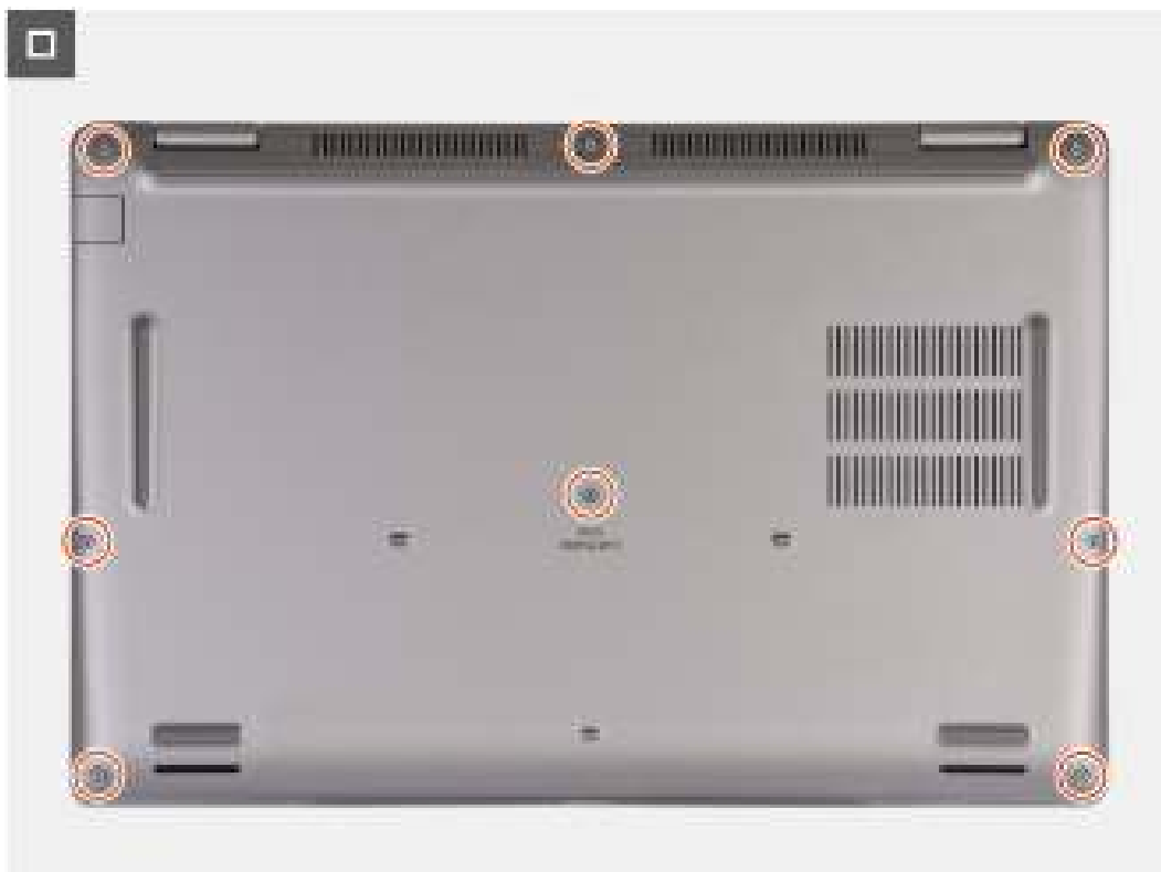
Afbeelding 18. De geborgde schroeven vastdraaien
