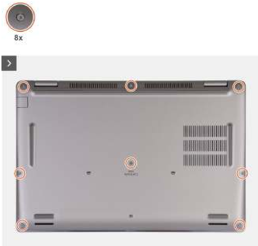
Afbeelding 13. De geborgde schroeven losdraaien
