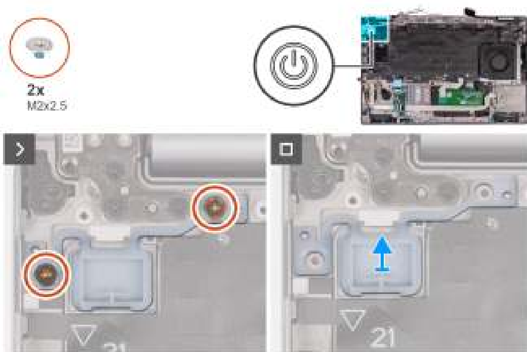
Afbeelding 61. De aan/uit-knop verwijderen
