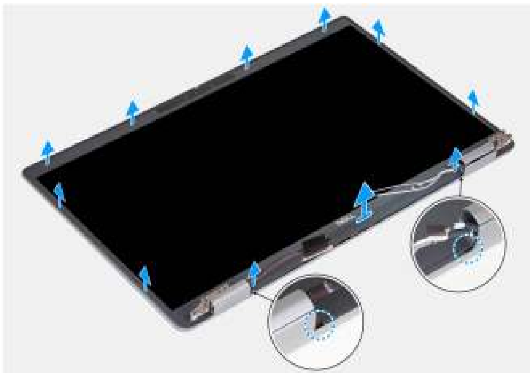
Afbeelding 74. De beeldschermbezel verwijderen
