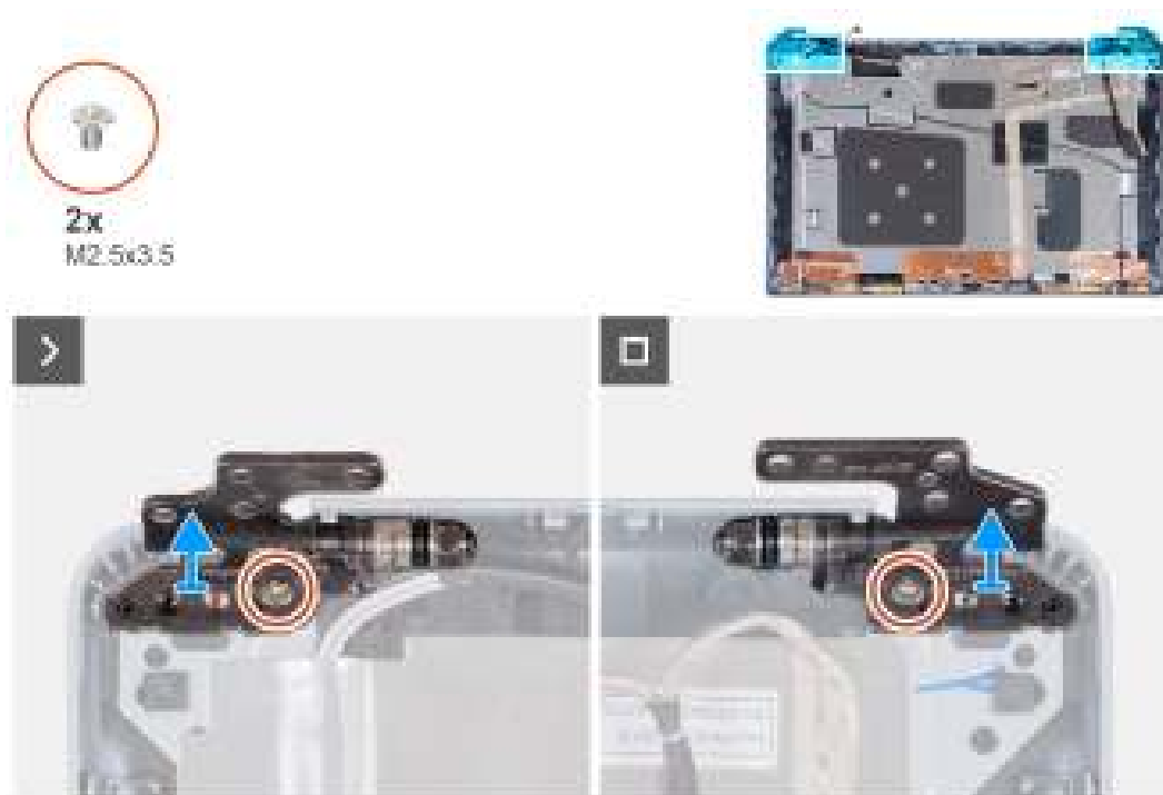
Afbeelding 86. De beeldschermsharnieren verwijderen
