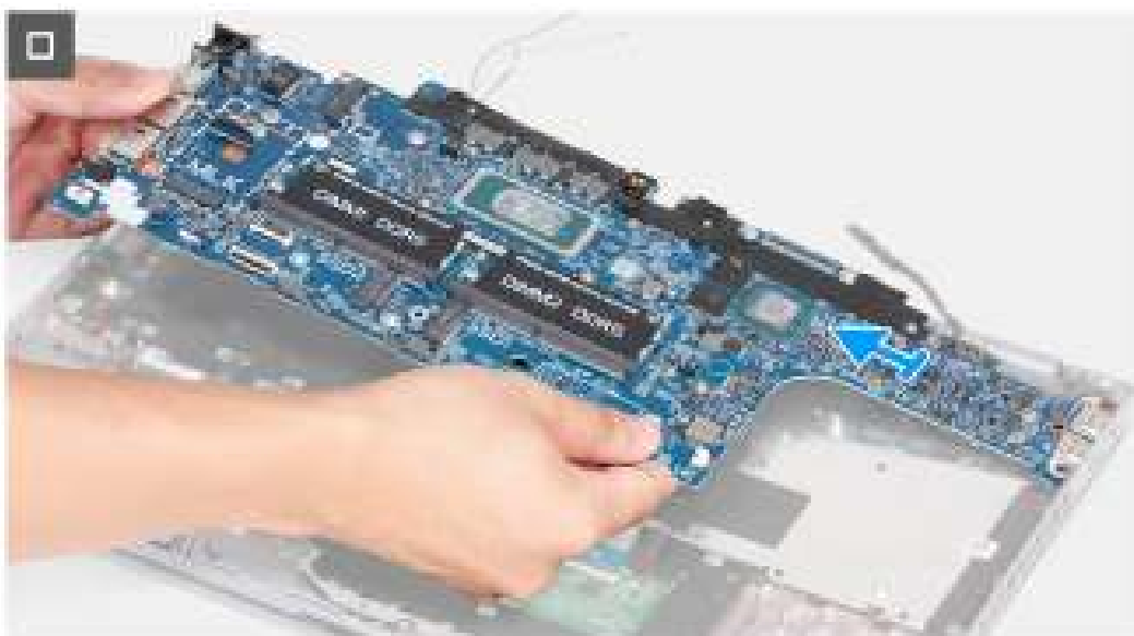
Afbeelding 56. De systeemkaart verwijderen
