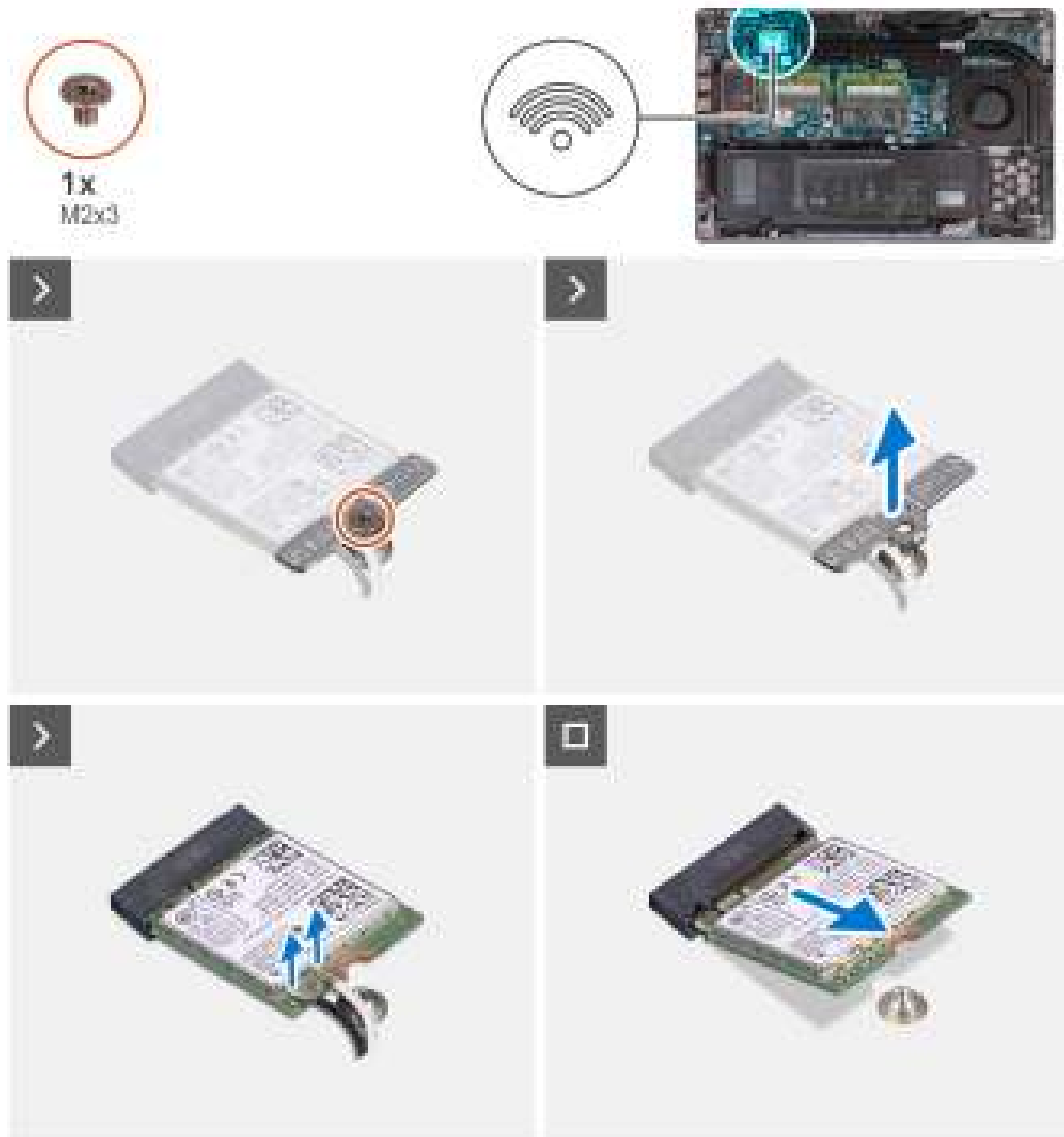
Afbeelding 19. De draadloze kaart verwijderen
