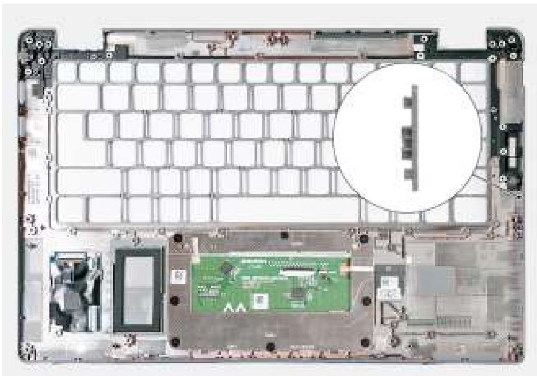
Afbeelding 83. De palmsteuneenheid verwijderen
