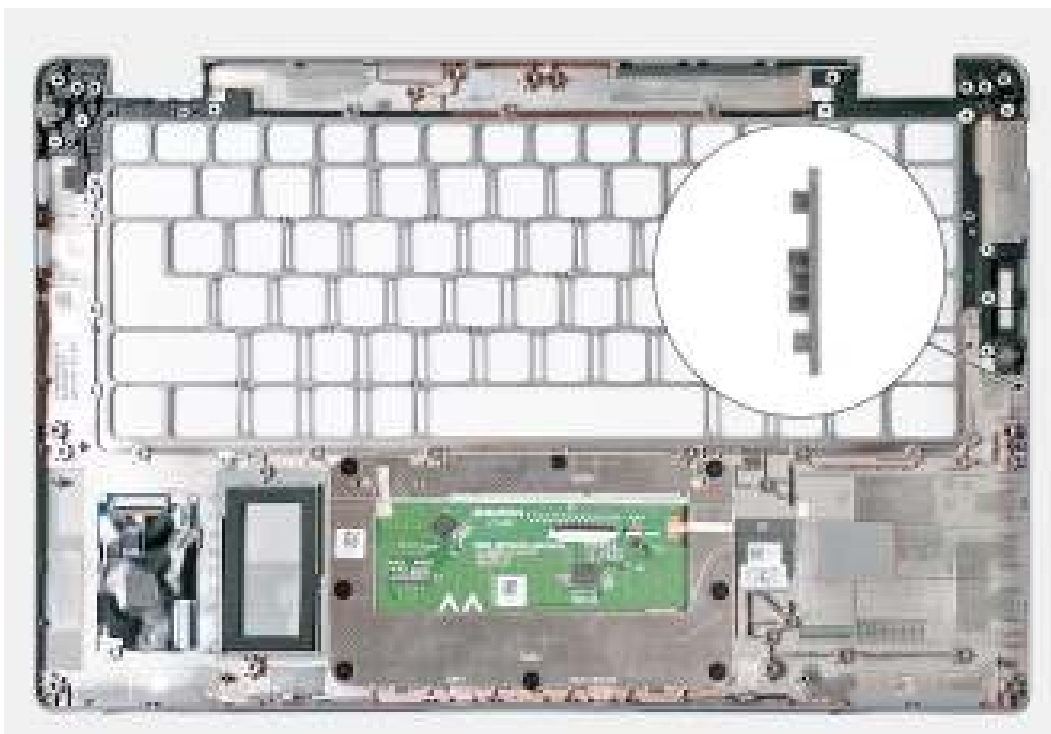
Afbeelding 84. De palmsteuneenheid installeren
