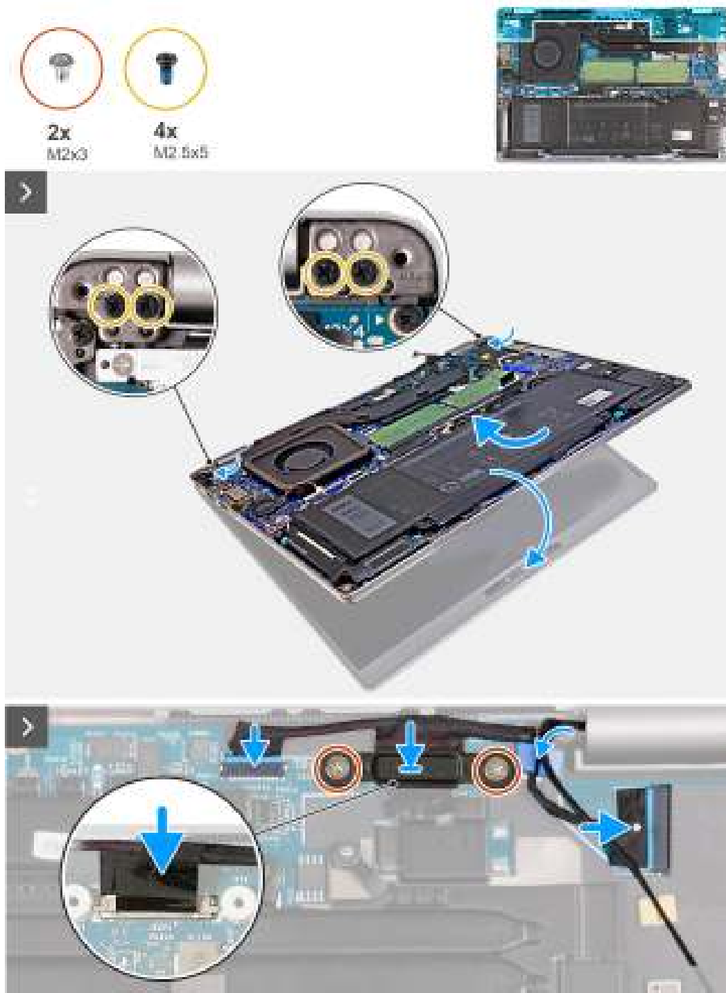
Afbeelding 52. De beeldschermseenheid installeren - voor computers die worden geleverd met afzonderlijke grafische kaart
