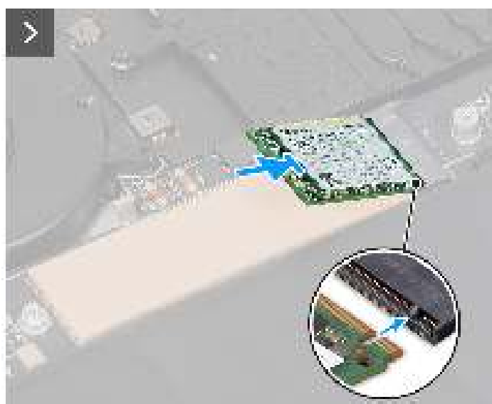
Afbeelding 21. De M.2 2230 SSD installeren
