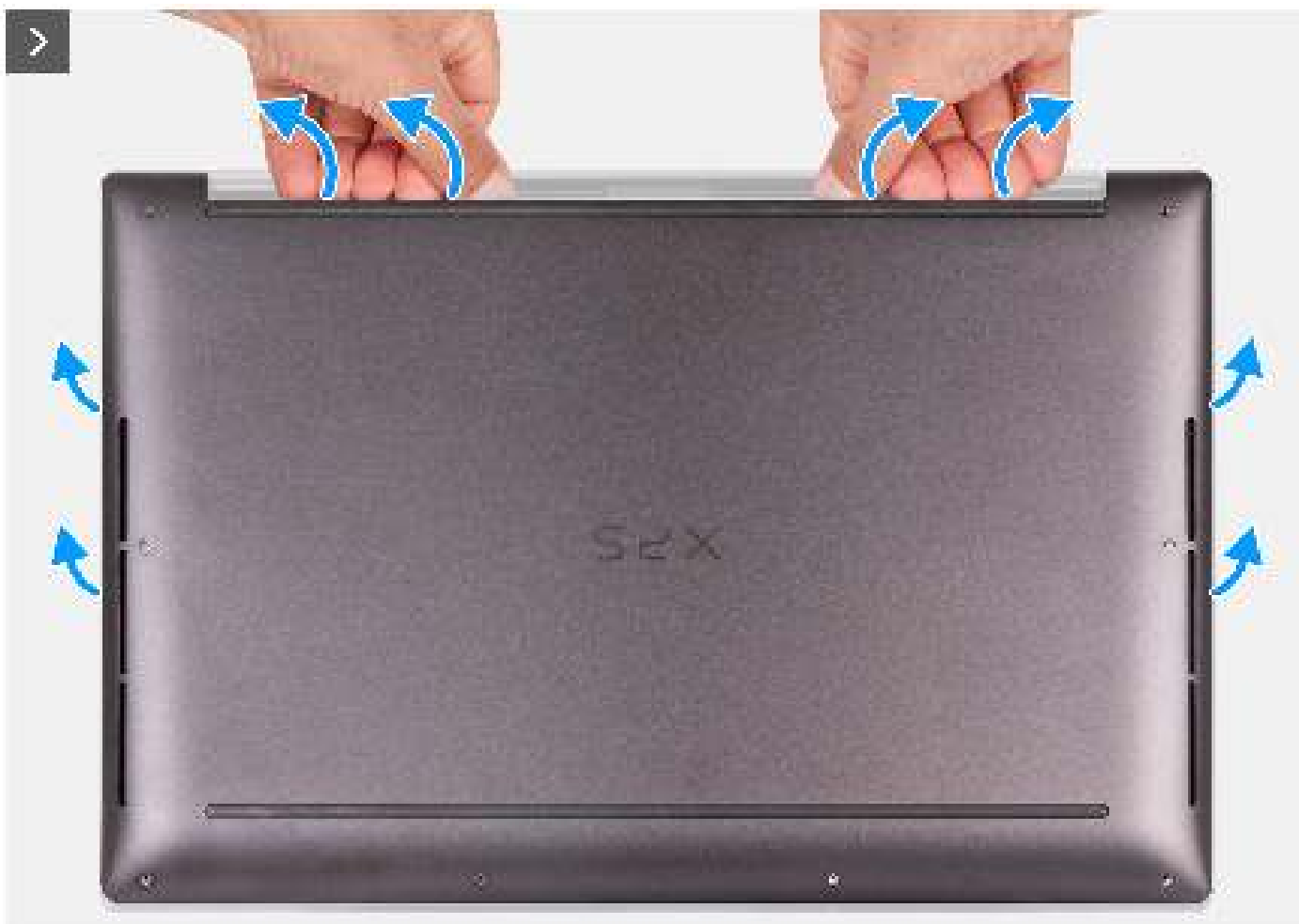
Afbeelding 10. Gebruik beide duimen om de onderplaat los te wrikken
