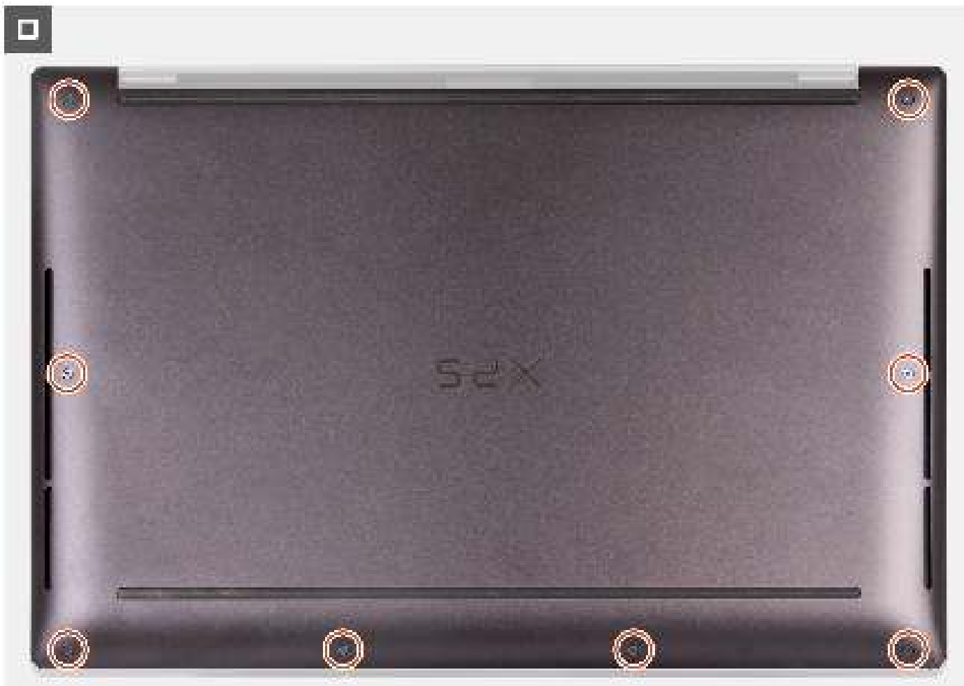
Afbeelding 16. Draai de acht schroeven vast waarmee de onderplaat aan de palmsteuneenheid is bevestigd.
