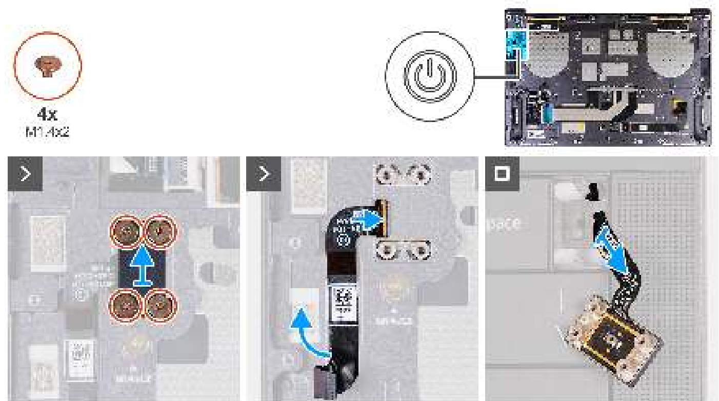
Afbeelding 38. De aan/uit-knop met vingerafdruklezer verwijderen
