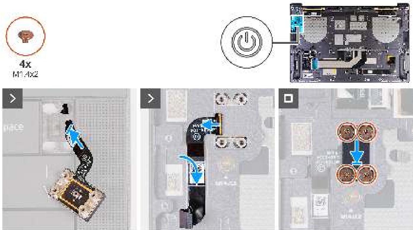
Afbeelding 40. De aan/uit-knop met vingerafdrukkezer plaatsen
