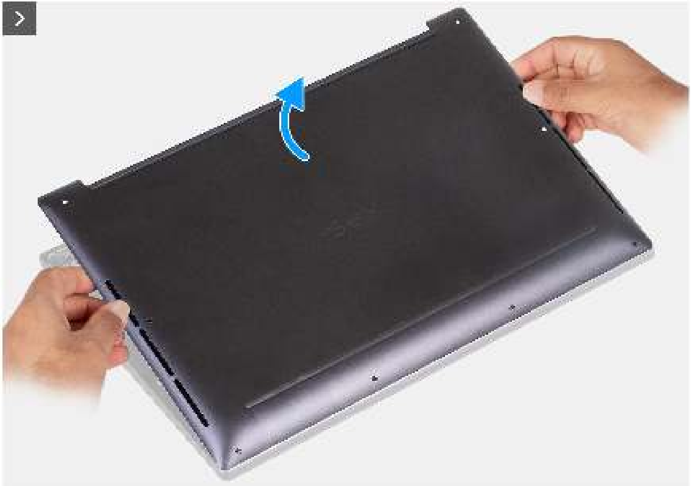
Afbeelding 11. Til de onderplaat van de palmsteuneenheid
