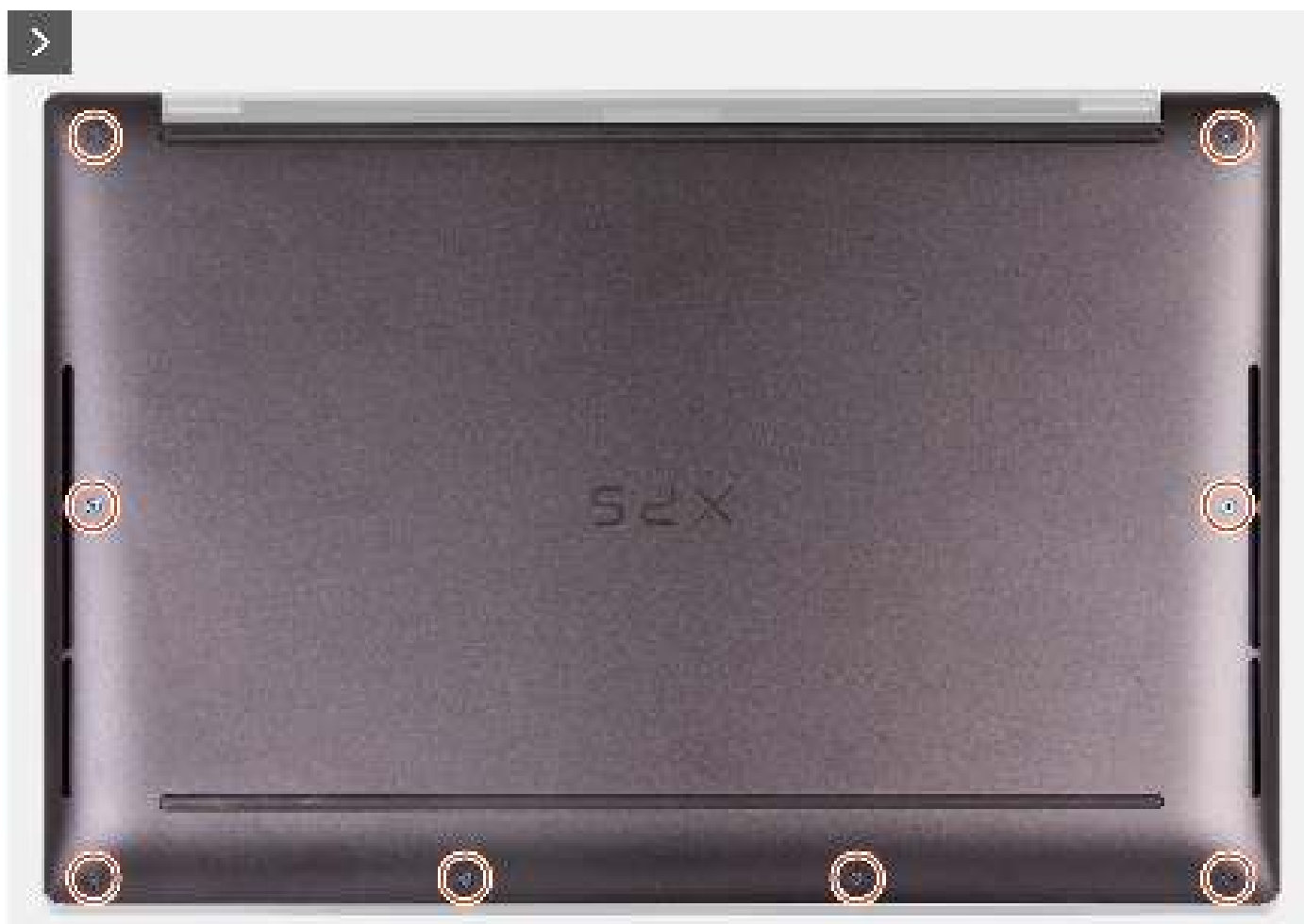
Afbeelding 9. De onderplaat verwijderen
