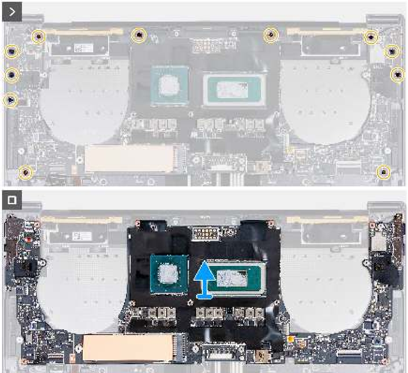
Afbeelding 34. De systeemkaart verwijderen
