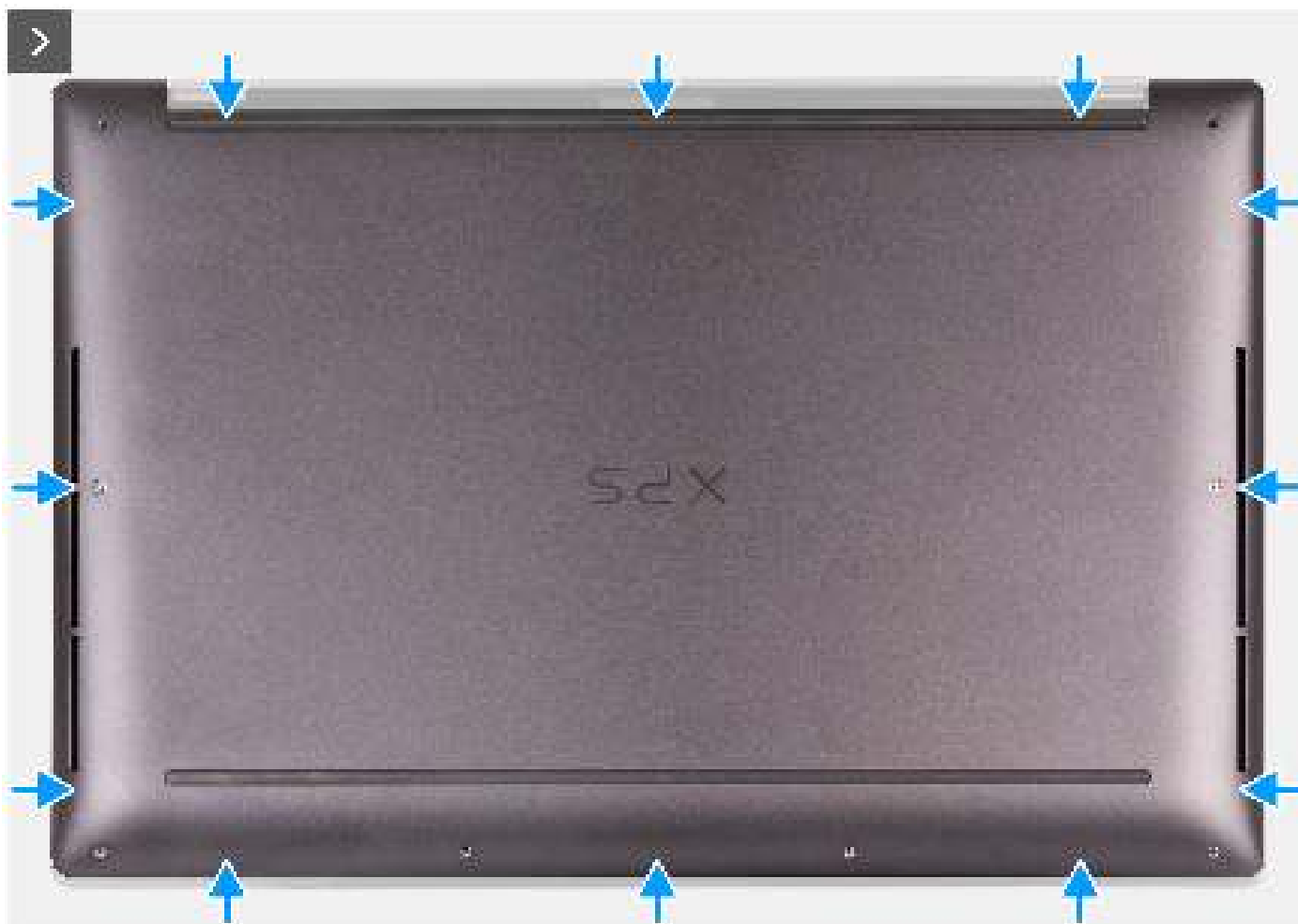
Afbeelding 15. Klik de onderplaat vast op de palmsteuneenheid
