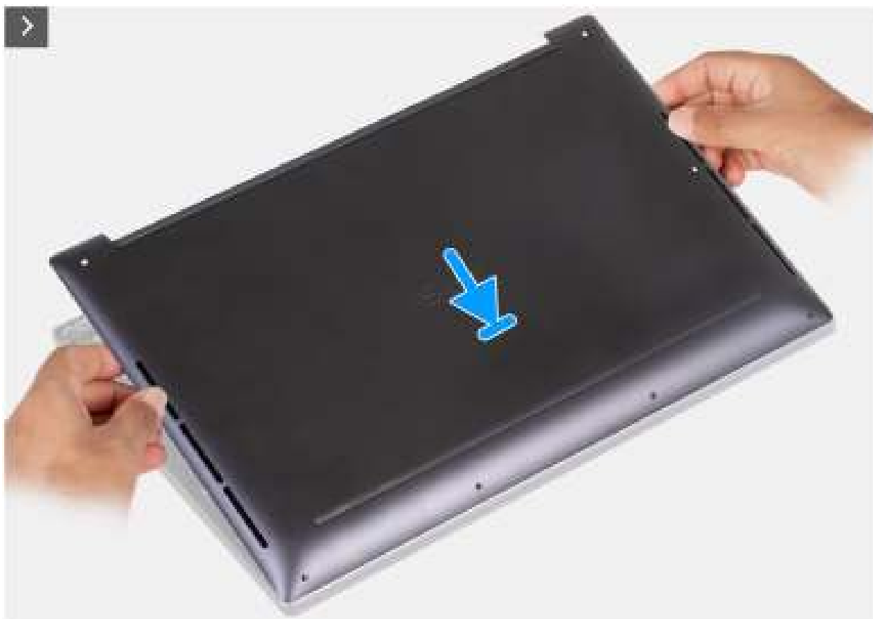
Afbeelding 14. Plaats de onderplaat in de slots op de palmsteuneenheid.
