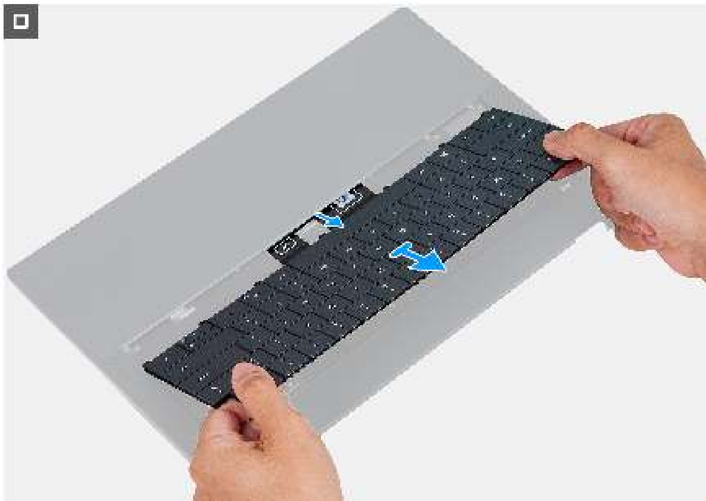
Afbeelding 42. Het toetsenbord verwijderen
