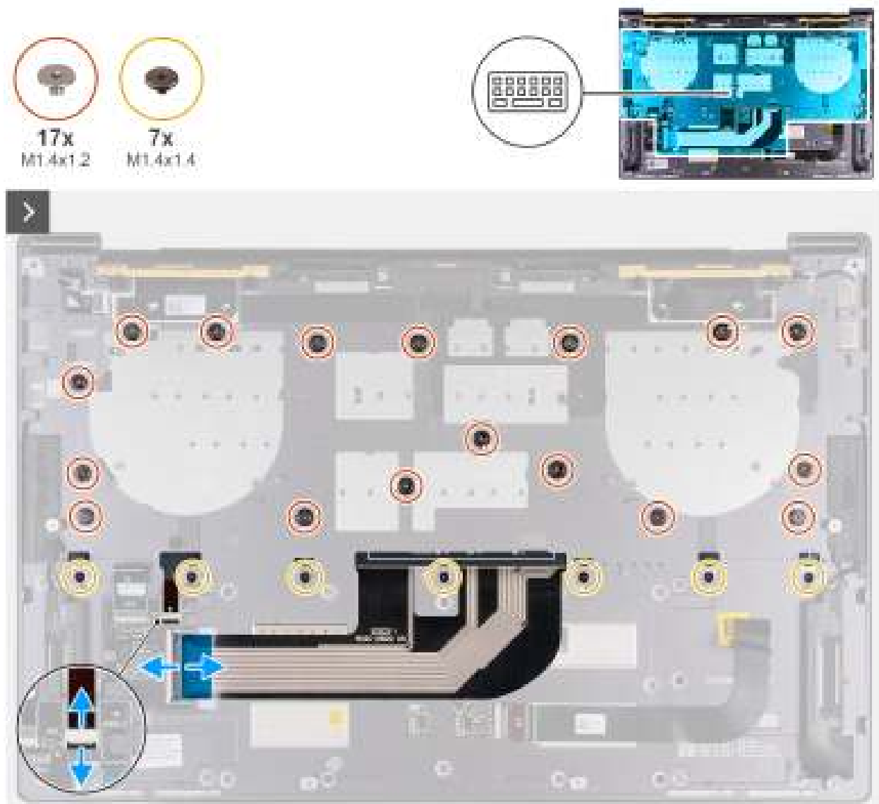
Afbeelding 41. Het toetsenbord verwijderen
