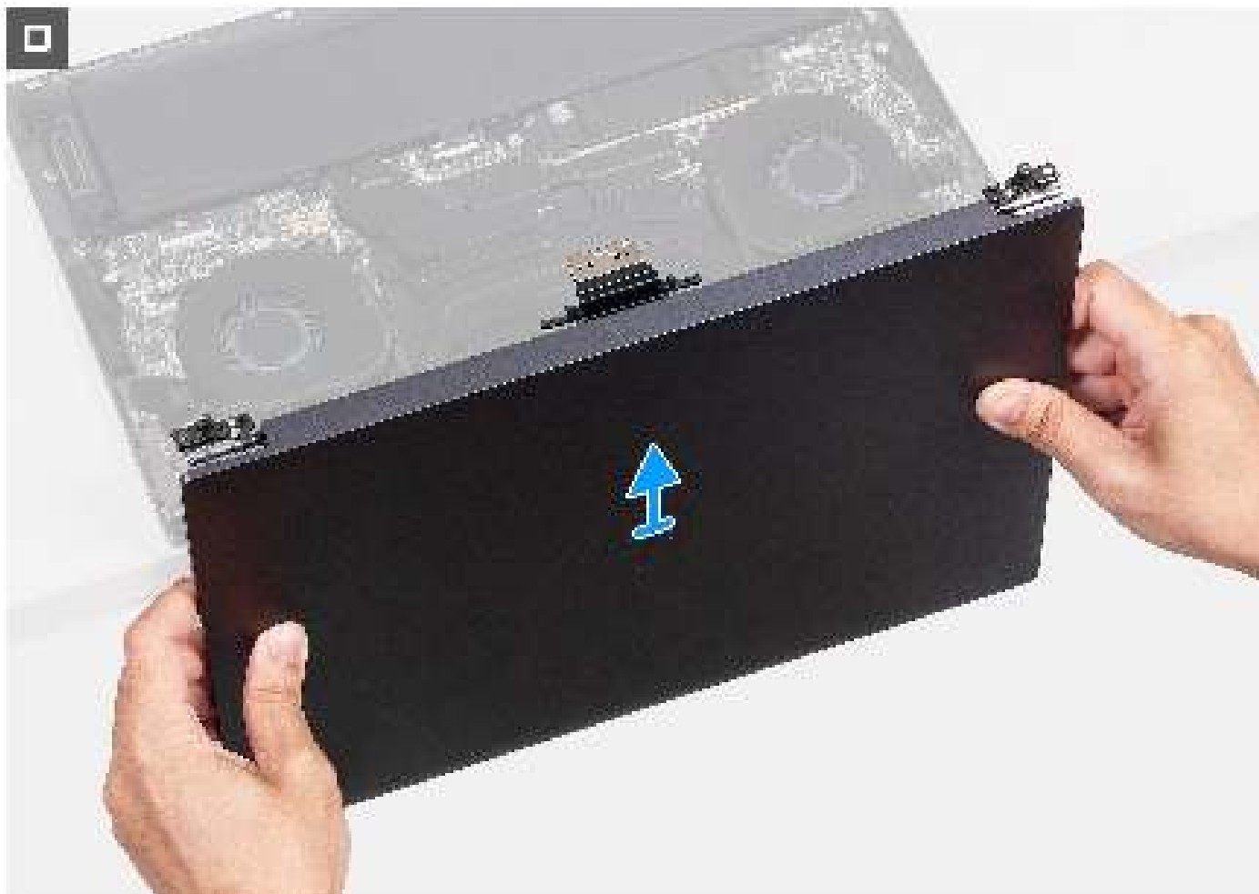
Afbeelding 28. De beeldschermeenheid verwijderen
